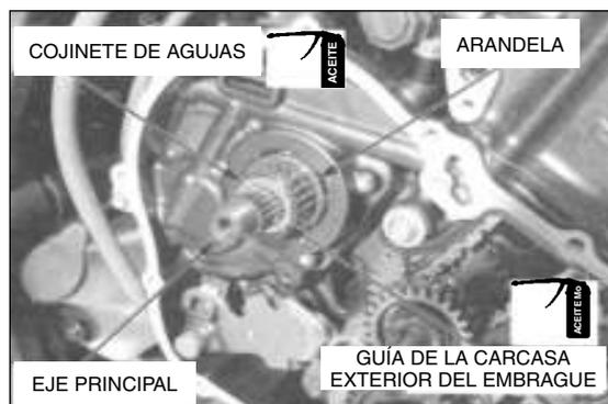
Instale la carcasa exterior del embrague y la arandela.
