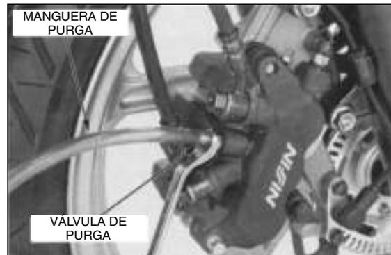
Conecte la manguera de purga a la válvula de purga del caliper del freno trasero.
