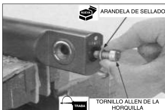
Si el pistón de la horquilla de la suspensión girara junto con el tornillo Allen, instale provisoriamente el resorte de la horquilla, el asiento del resorte, el separador y el tapón de la horquilla.
