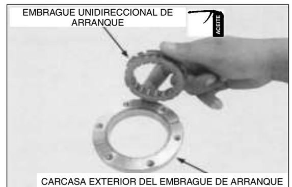
Instale el conjunto del embrague de arranque en el volante del motor como se muestra en la figura.
