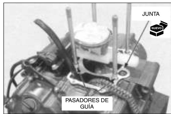
Aplique aceite para motor en la superficie interior del cilindro y en la superficie de deslizamiento del pistón.
