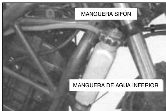
Aloje el tornillo de la abrazadera de la manguera de agua y desconecte la manguera de agua superior.
