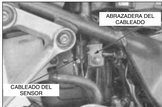
Quite el tornillo y la guía de la manguera de freno, y suelte el cableado del sensor de la rueda trasera desde la guía de la manguera de freno.
