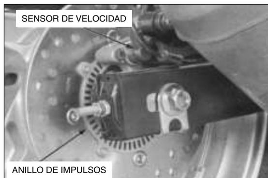
**3. Inspección de la Tensión de Entrada del Sensor de Velocidad de la Rueda Trasera**
