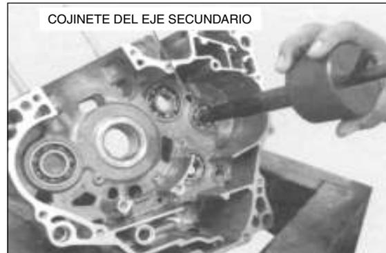
Instale los cojinetes nuevos dentro de la carcasa derecha hasta que estén totalmente asentados utilizando las herramientas especiales.
