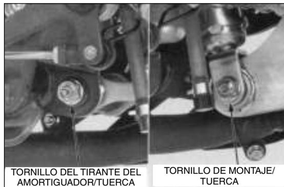
TORNILLO DEL TIRANTE DEL AMORTIGUADOR/TUERCA
