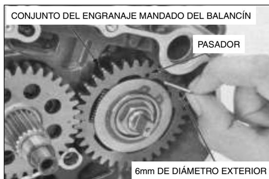
Inserte un fijador de engranajes entre el engranaje de mando del balancín y el conjunto del engranaje mandado del balancín.
