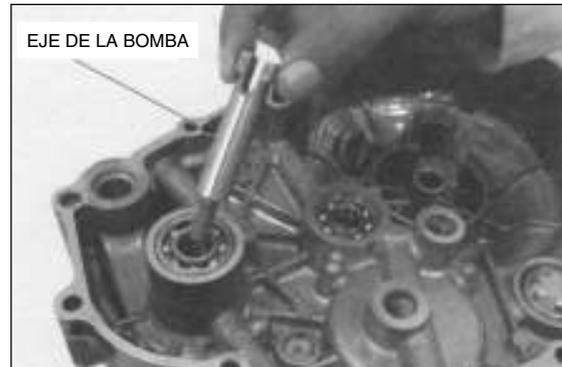
Verifique el eje de la bomba de agua con respecto a desgaste o a daño, sustitúyalo si fuera necesario.
