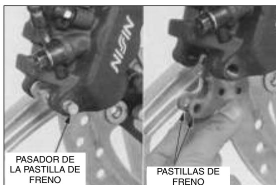
Instale pastillas de freno nuevas en el caliper del freno de manera que sus extremos se asienten contra el retén.
