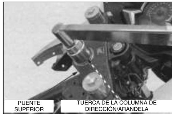
Instale la capa de la tuerca de la columna de dirección.
