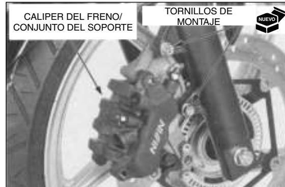
Instale el ojal de la manguera del freno en el cuerpo del caliper con arandelas de sellado nuevas y tornillos de aceite.
