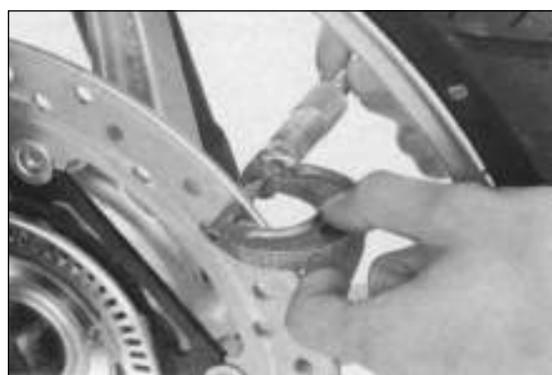
Mida el alabeo de los discos de freno utilizando un reloj comparador.
