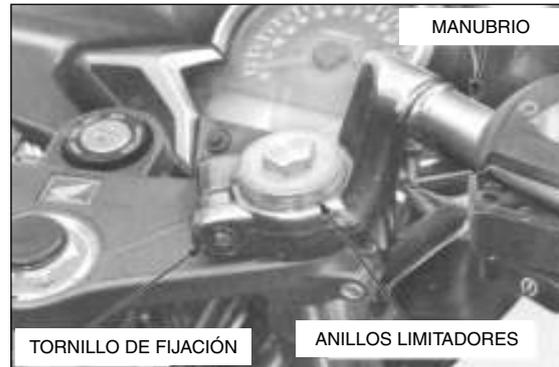
Desconecte los cables desde el tubo del acelerador, enseguida quite el tubo del acelerador.
