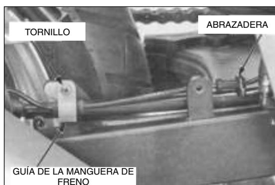
Quite el tornillo, la abrazadera de cableado del sensor desde el soporte del caliper del freno trasero.
