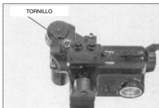
Aplique 0,10 gr. de grasa de silicona en el área de contacto de la palanca del freno del pistón maestro y en la superficie de deslizamiento del tornillo pivote de la palanca de freno, consulte la página 1-16.
