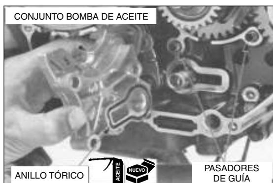
Instale y apriete firmemente los tornillos de montaje de la bomba de aceite.
