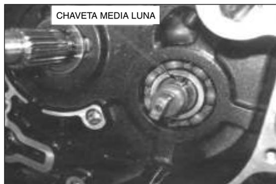
Alinee el engranaje del balancín y los agujeros del engranaje secundario del balancín e instale un pasador de 6 mm dentro del agujero.
