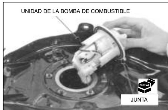
Instale la placa de asentamiento de la bomba de combustible en la unidad de la bomba de combustible alineando las ranuras de la placa de asentamiento y de las lengüetas de la unidad de la bomba de combustible.
