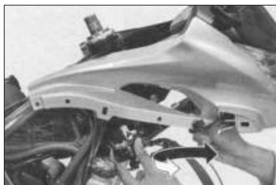
Reapriete la tuerca de ajuste al par de apriete especificado utilizando la herramienta especial.
