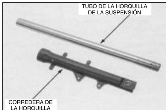
Coloque el tubo de la horquilla sobre bloques en V.
