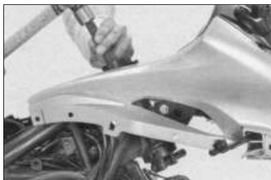
Instale provisoriamente la tuerca de la columna de dirección en la columna para evitar daños a las roscas al quitar la pista interna inferior desde la columna de dirección.
