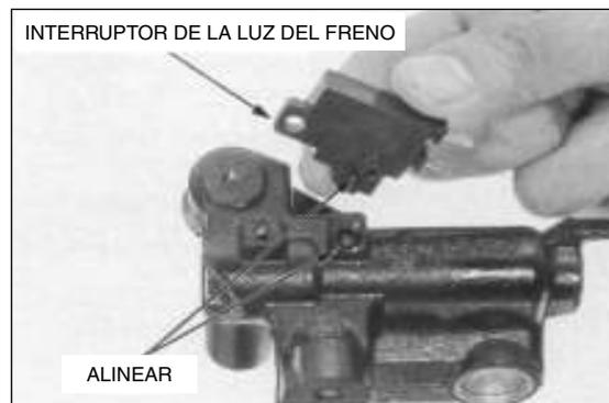
Instale y apriete el tornillo del interruptor de la luz de freno al par de apriete especificado.
