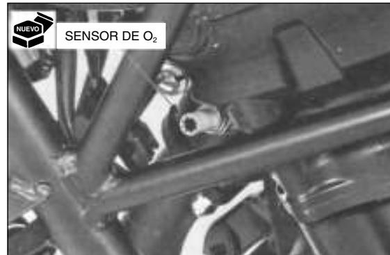
Conecte el protector del sensor de O<sub>2</sub>.
