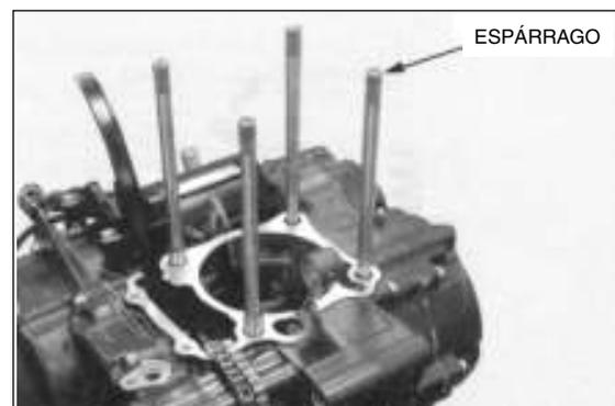
Instale espárragos nuevos en la carcasa del motor como se muestra en la figura.
