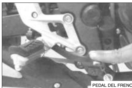
Aplique firmemente la palanca del freno o el pedal y verifique que no haya entrado aire en el sistema.
