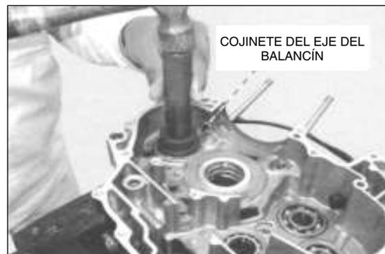
Después de la instalación aplique aceite para motor en el área de rotación de cada cojinete.
