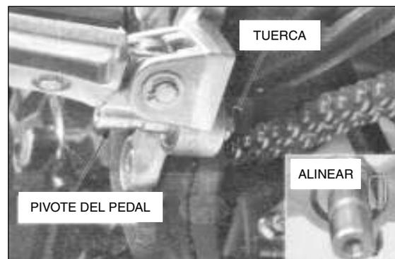
Aplice grasa en la superficie de deslizamiento del pivote del pedal del selector de marchas.
