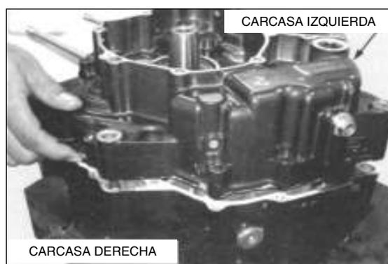
Instale los tornillos de la carcasa derecha.
