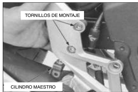
Instale el cilindro maestro en el pedal de freno e instale el pasador de conexión y una chaveta nueva.
