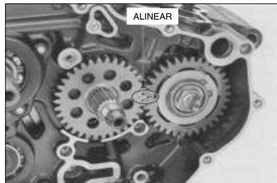
Inserte el fijador de engranajes entre el engranaje de mando y el engranaje mandado del balancín.
