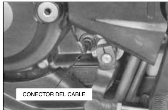
Verifique si hay continuidad entre el terminal del interruptor y el tierra del motor.
