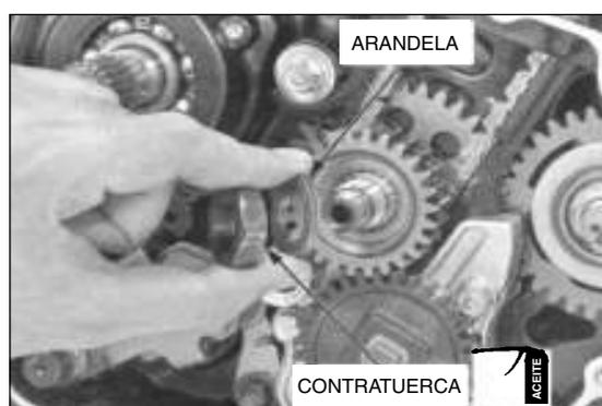
Instale provisoriamente la arandela, la guía de la carcasa exterior del embrague, el cojinete de agujas y la carcasa exterior del embrague.
