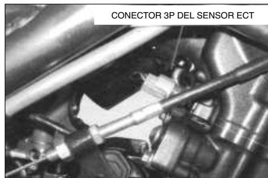
CONECTOR 3P DEL SENSOR ECT
