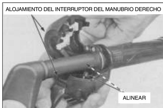
Instale los tornillos y apriete primero el tornillo delantero y enseguida el trasero al par de apriete especificado.
