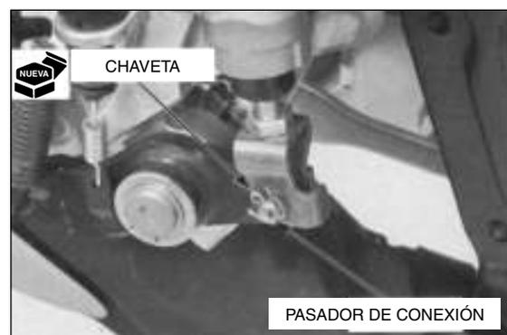
Instale el conjunto del soporte del descansapie principal derecho y los tornillos Allen de montaje del soporte del descansapie.
