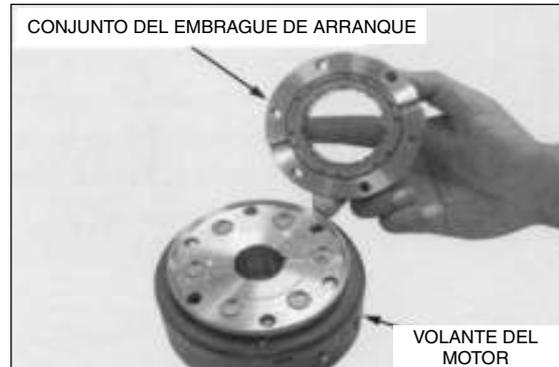
Aplique traba química en las roscas de los tornillos Allen del embrague de arranque.
