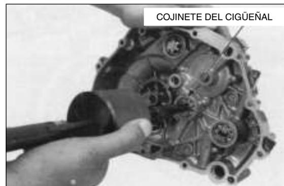
Instale un nuevo cojinete en la tapa derecha de la carcasa del motor con el lado marcado vuelto hacia arriba hasta que esté totalmente asentado, con las herramientas especiales.
