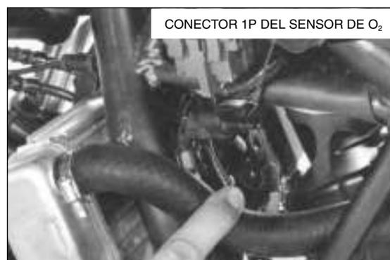
Desenchufe el protector del sensor de O<sub>2</sub>.
