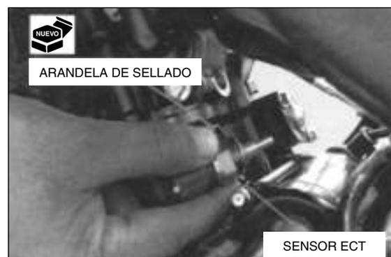
Enchufe el conector 3P del sensor ECT.
