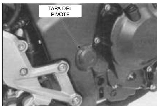
Quite la tuerca del pivote del brazo oscilante, el tornillo pivote y el brazo oscilante.
