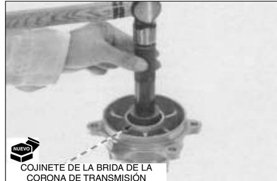
Instale el separador en el cojinete de la brida de la corona de transmisión.
