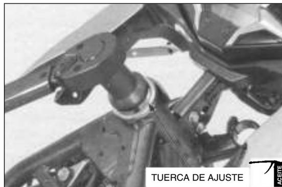
Instale una arandela de traba nueva alineando sus lengüetas dobladas cortas con las ranuras en la tuerca de ajuste de la columna de dirección.
