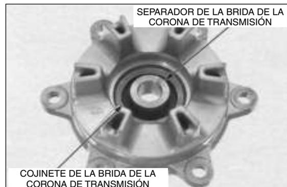
Instale el cabezal extractor de cojinetes en el cojinete.
