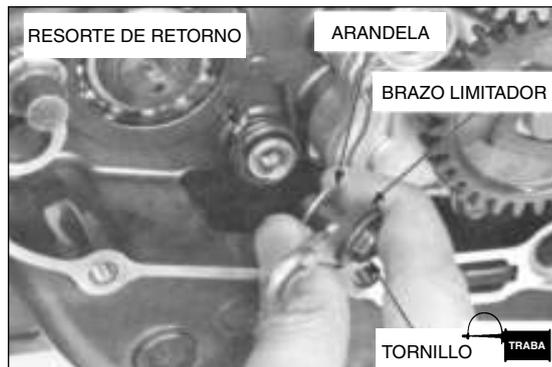
Aparte el brazo limitador utilizando un destornillador.
