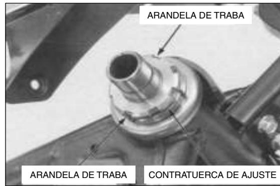
Afloje la tuerca de ajuste de la columna de dirección utilizando una herramienta especial.
