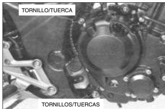
Instale el cableado del sensor VS en las guías.
