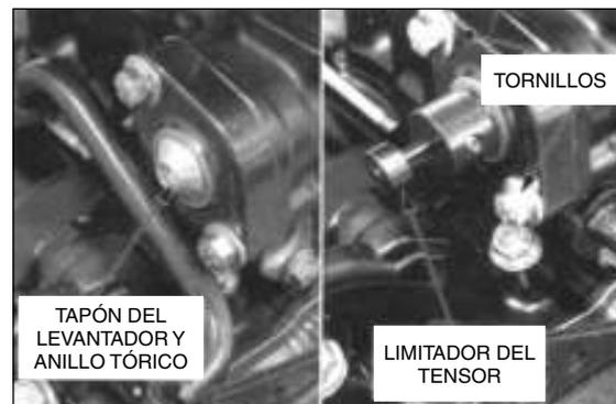
Instale una junta nueva en el levantador del tensor de la cadena de distribución e instálelos en el cilindro.
