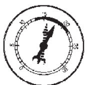
ASENTAMIENTO DE VALVULAS POBRE EN RALENTI
