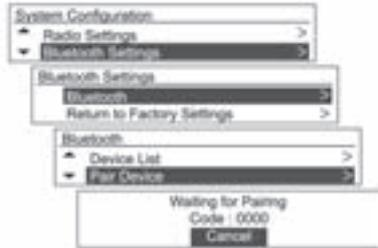
Pulse el botón **CONFIG**, y use el botón **MENU** con el dial **TUNE** para desplazarse a **Configuración del sistema** → **Configuración Bluetooth** → **Asociar dispositivo**, y pulse a continuación el botón **MENU**.
