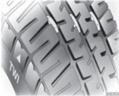
La profundidad mínima autorizada legalmente (1,6 mm) se ha alcanzado cuando el dibujo muestra un indicador de desgaste (TWI = Tread Wear Indicator). Su posición se indica mediante marcas en el flanco del neumático.
