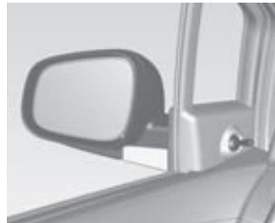
Basta con mover la palanca de ajuste en la dirección deseada para regular el ángulo de los retrovisores.
