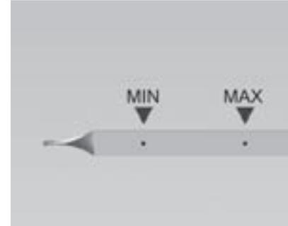
8. Compruebe el nivel de aceite. El aceite debe estar entre la marca MIN y MAX en la varilla de nivel, tal como se muestra en la ilustración.
