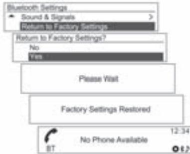
Para reiniciar la **Configuración de Bluetooth** a sus valores predeterminados, utilice el botón **MENU** con el dial **TUNE** para seleccionar la opción de restauración de configuración inicial y, a continuación, seleccione **Sí** con el botón **MENU**.
