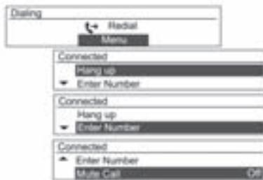
Pulse el botón **MENU** mientras el teléfono está conectado para mostrar las funciones de conexión, tal como se muestra arriba.
