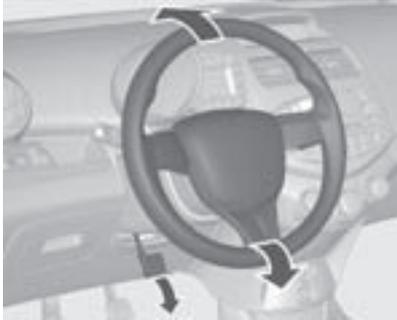
Desbloquee la palanca, ajuste el volante, luego enclave la palanca y asegúrese de que esté totalmente bloqueada. El volante sólo se debe ajustar con el vehículo parado.
