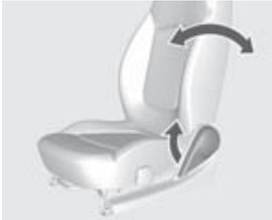
Tire de la palanca, ajuste la inclinación y suelte la palanca. Deje que el asiento enclave audiblemente.
