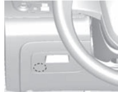
El bloque de fusibles interior está situado en la parte inferior del tablero de instrumentos, en el lado del conductor.
