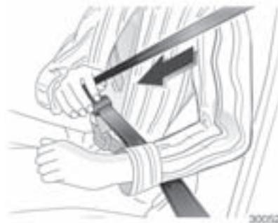
Extraiga el cinturón del retractor, guíelo por encima del cuerpo sin retorcerlo e inserte la lengüeta en el cierre. Durante el viaje, tense frecuentemente el cinturón abdominal tirando suavemente de la banda torácica. Recordatorio del cinturón de seguridad
