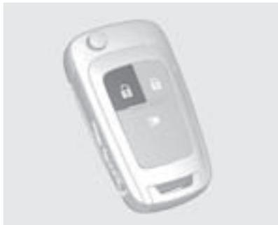
Si se desbloquea el vehículo con el botón
