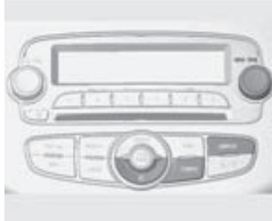
Pulse el botón **CONFIG** con el encendido conectado (ON) y el sistema de infoentretenimiento activado.
