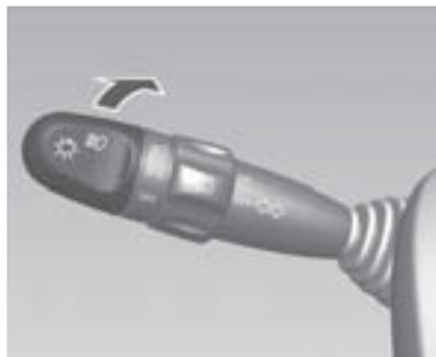
Apague y encienda las luces delanteras y traseras, gire el extremo de la palanca del conmutador combinado. El conmutador de las luces tiene tres posiciones que activan varias luces del siguiente modo:
