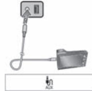
Conecte la salida de audio del equipo de sonido externo al terminal de entrada AUX.
