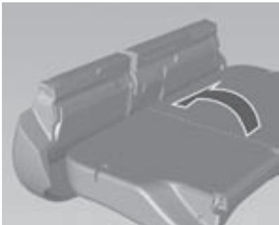
3. Tire del mando de desbloqueo situado encima del respaldo del asiento trasero y abata el asiento hacia delante y detrás.
