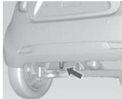
La argolla de remolque trasera está debajo del parachoques trasero.
