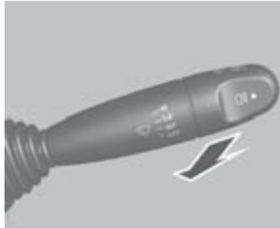
Tire de la palanca. Se pulveriza líquido de lavado sobre el parabrisas y el limpiaviento se realiza el barrido varias veces.
