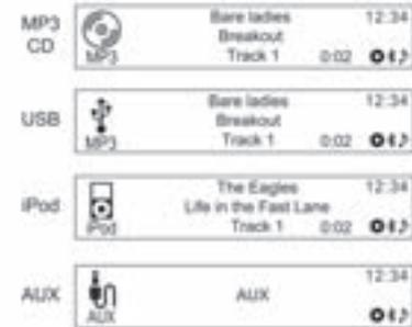
Pulse el botón **AUX** para seleccionar la entrada de sonido exterior (sólo para el Tipo C) o pulse repetidamente el botón **CD/AUX** (sólo para el Tipo A/B) para cambiar por las funciones del reproductor de audio, la función de CD para discos CD/MP3 o el reproductor de audio USB/iPod conectado (sólo para el Tipo A/B).
