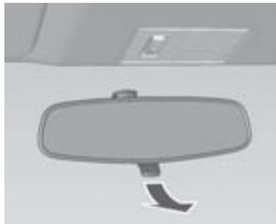
Para reducir el deslumbramiento, accione la palanca que hay debajo de la carcasa del espejo.
