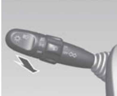
La palanca volverá a la posición normal cuando la suelte. Las luces de carretera estarán encendidas mientras sujete la palanca del conmutador combinado hacia usted.
