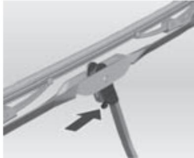
Levante el brazo del limpiaparabrisa. Pulse la palanca de desbloqueo y desacople la escobilla.
