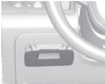
1. Abra la tapa del panel de fusibles tirando hacia fuera de la parte superior.
