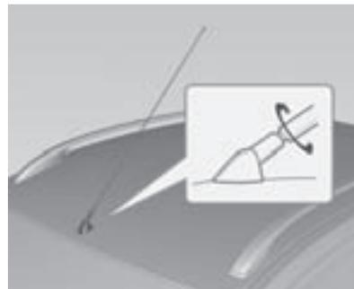
Para desmontar la antena del techo, gírela hacia la izquierda. Para montar la antena del techo, gírela hacia la derecha.
