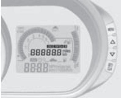
El cuentakilómetros muestra la distancia recorrida por el automóvil en kilómetros o millas.
