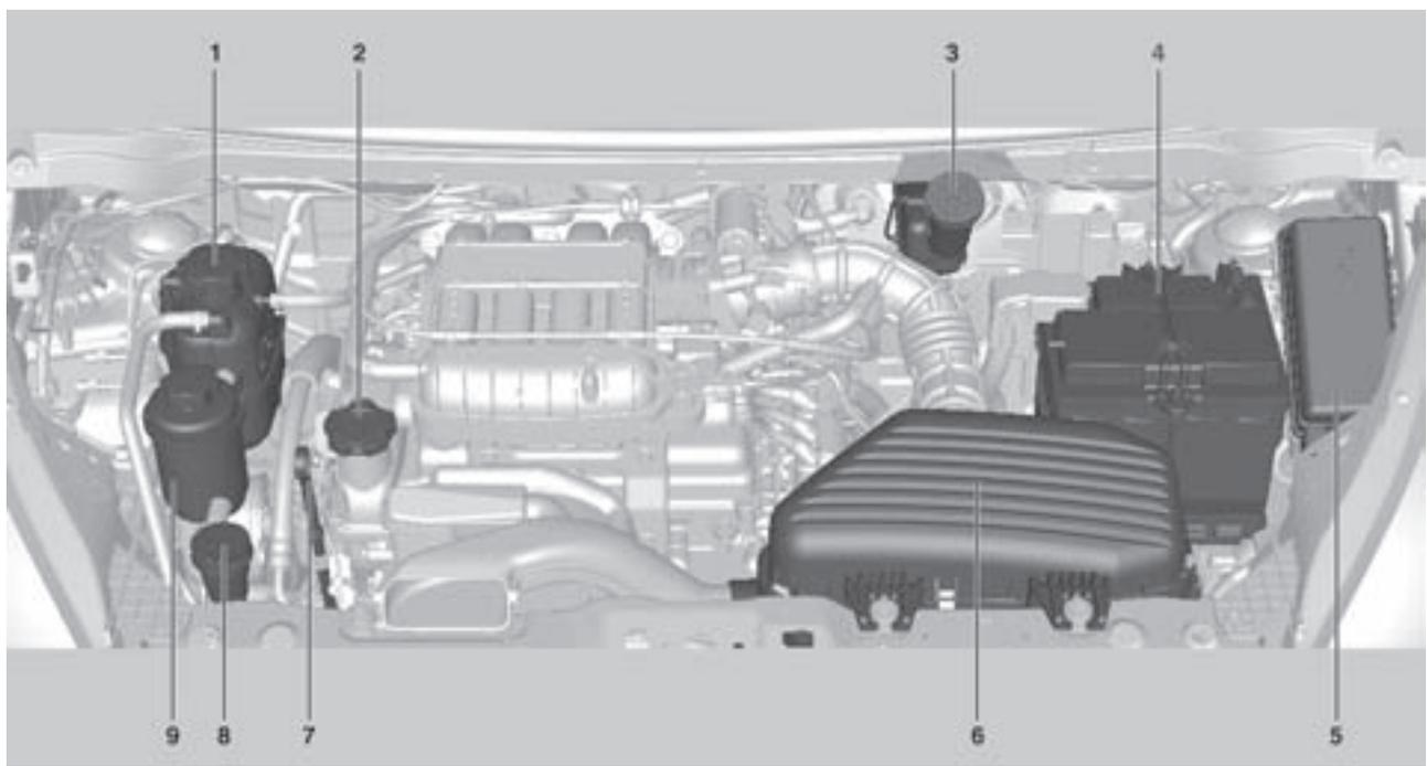
1. Depósito del refrigerante del motor
