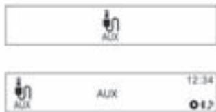
Pulse el botón **CD/AUX** (sólo para el Tipo A/B) o **AUX** (sólo para el Tipo C) para cambiar al modo de entrada de sonido exterior si ya se ha conectado el equipo de sonido externo.
