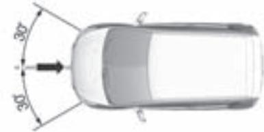
El sistema de airbags frontales se activa en caso de choque de una determinada gravedad en el sector indicado. El encendido debe estar conectado.
