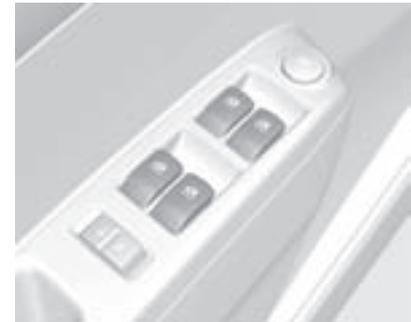
Los elevalunas eléctricos se pueden accionar con el encendido conectado.
