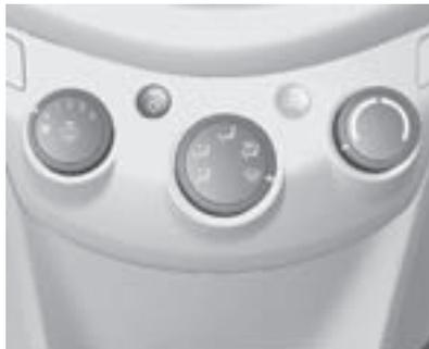
1. Gire el mando de distribución del aire a la posición DESEMPAÑAR ☰ y el modo de recirculación se activará y ajustará a modo de aire exterior automáticamente.
