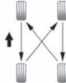
Al rotar los neumáticos, utilice siempre el patrón de rotación correcto aquí mostrado. No incluya el neumático de repuesto en la rotación. Después de haber rotado los neumáticos, ajuste los neumáticos delanteros y traseros a la presión de inflado recomendada en la etiqueta de información de neumáticos y carga.
