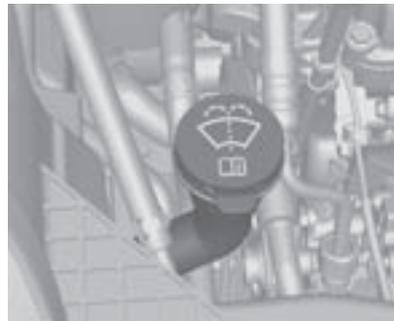
Llene el depósito con agua limpia mezclada con una cantidad adecuada de líquido lavaparabrisas que contenga anticongelante. Para la relación correcta de la mezcla, consulte el depósito del líquido de lavado.
