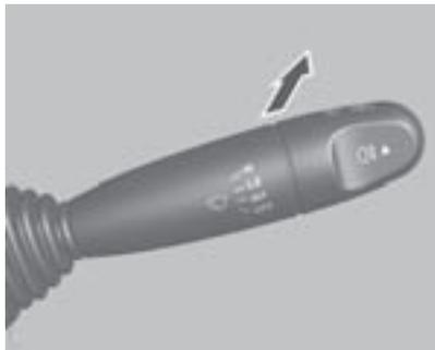
Para poner en marcha el limpiador y el lavador traseros, mueva la palanca hacia el panel de instrumentos. Si la mueve una vez, el limpiador se activará de forma continua a velocidad lenta. Para pulverizar líquido de lavado, mueva la palanca otra vez.
