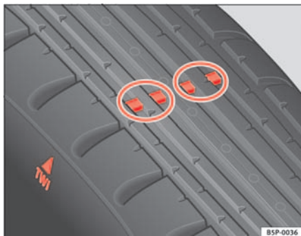
Fig. 129 Indicadores de desgaste del perfil del neumático
