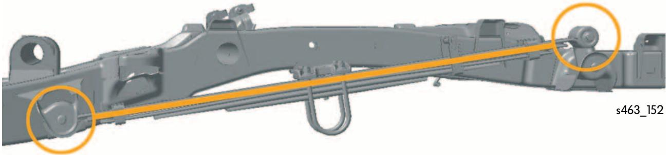
Una característica especial del anclaje de la suspensión es que los puntos de fijación traseros del paquete de muelles en la estructura del chasis quedan más altos que los puntos de fijación delanteros.
