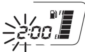
3. Para ajustar las horas, hay que pulsar la tecla RESET (2) hasta que aparece la hora deseada.
