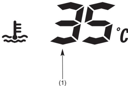
(1) Medidor de la temperatura del refrigerante
