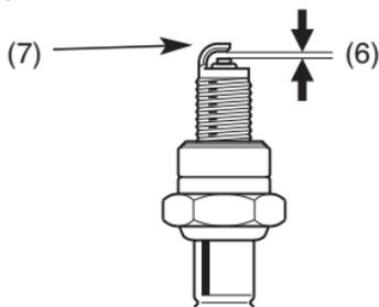
(6) Separación entre electrodos (7) Electrodo lateral
