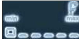
El parpadeo indica una falta de aceite que puede deteriorar el motor. Si se confirma la falta de aceite por la verificación de la varilla manual, complete imperativamente el nivel.
