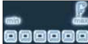
El parpadeo indica un exceso de aceite que puede deteriorar el motor. Si se confirma el exceso de aceite por la verificación de la varilla manual, consulte en un Punto de Servicio PEUGEOT.
