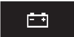
Un icono de advertencia de sistema de carga que muestra una batería con un signo menos (-) y un signo plus (+). | Indica un funcionamiento incorrecto en el sistema de carga del vehículo.                                                                             |
