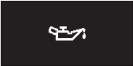
Un icono de advertencia de aceite del motor que muestra un contenedor de aceite con una gota que se derrama.    | Indica una presión anómala del aceite del motor.<br>Es posible que la luz de aviso se encienda si la presión del aceite del motor es demasiado baja. |
