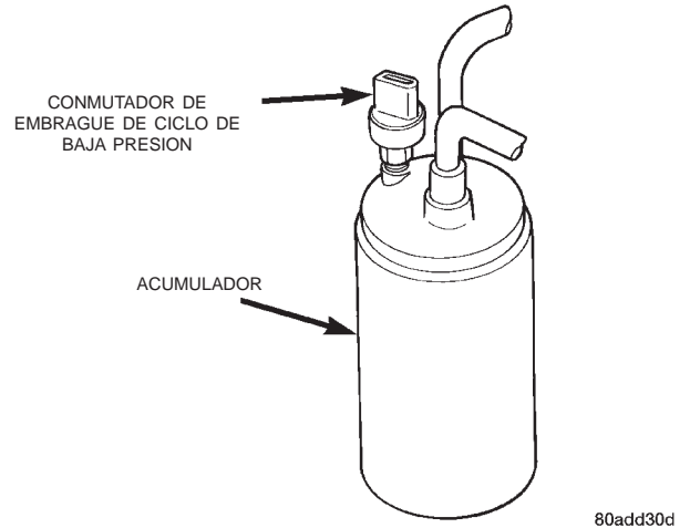
Fig. 7 Conmutador de embrague de ciclo de baja presión-característico
