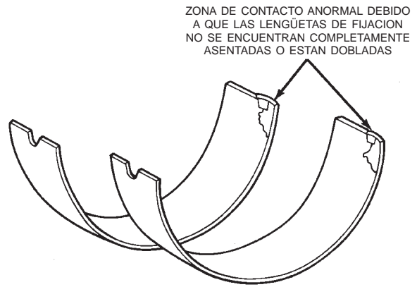
Fig. 14 Inspección de la lengüeta de fijación
