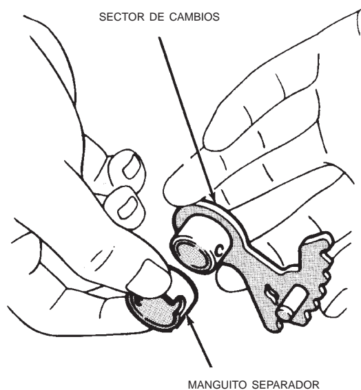
Fig. 68 Instalación del manguito separador en el sector
