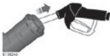
Levante ligeramente la boquilla de llenado de combustible para desmontarla.
