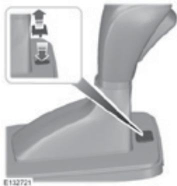
Utilice el botón para mover la palanca selectora de la posición de estacionamiento en caso de que se produzca un problema eléctrico o si el vehículo tiene descargada la batería.
