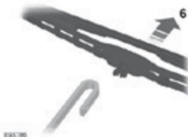
**Nota:** Compruebe que la escobilla encaja correctamente. Efectúe la instalación en orden inverso.
