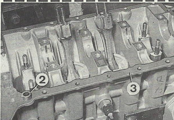
Assemblage des demi-carter de paliers de vilebrequin 1. Positionnement des coussinets rainurés dans le carter-chapeaux - 2. Centreurs - 3. Surfaces à enduire de pâte à joints
