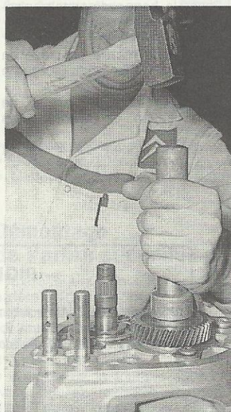
Pose de l'anneau d'arrêt d'arbre primaire avec le mandrin 80313 TP
