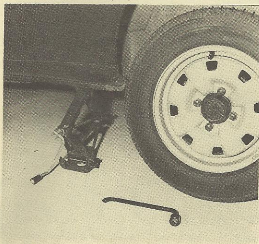
Mise en place du cric sous la voiture
