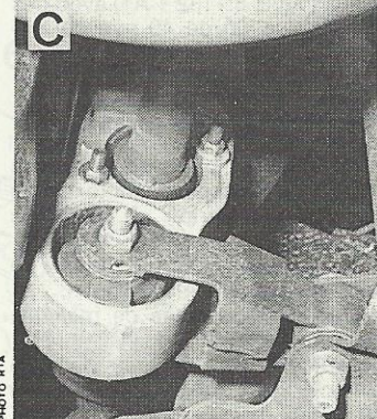
Supports du moteur A. Support droit - B. Support gauche C. Support inférieur sur le palier intermédiaire de transmission
