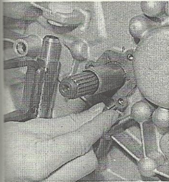
Pose du guide de butée. Monter les vis au Loctite « Frenetanch »
