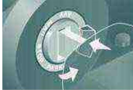
Pulse en este mando y gire simultáneamente la llave de una muesca en el sentido contrario del arranque. Puede a continuación quitar la llave : Las luces de posición se quedarán encendidas durante el periodo de su estacionamiento.
