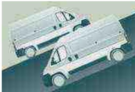
Esta función, ligada al ESP, facilita el arranque en una pendiente y se activa en las condiciones siguientes :
