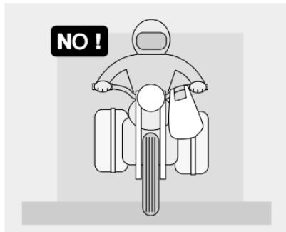
Não fixar, de nenhuma forma, objectos que estorvem, volumosos, pesados e/ou perigosos sobre guiador, guarda-lamas e forquetas: isto pode causar uma resposta mais lenta do veículo em caso de curvas, e vai comprometer inevitavelmente a maneabilidade do veículo.
