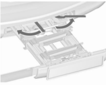
Mueva las dos palancas de fijación lateralmente todo lo que se pueda.
