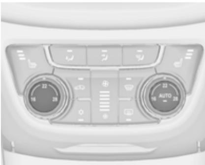
Si se ajusta la temperatura mínima **Lo**, el climatizador automático funciona a la máxima potencia de refrigeración siempre que se conecte la refrigeración ☀.
