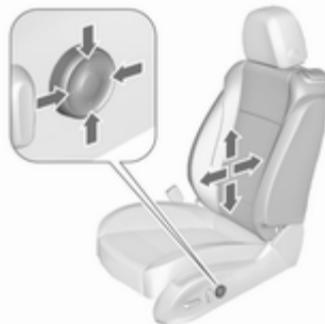
Ajuste el apoyo lumbar con el commutador de cuatro posiciones para adaptarlo a sus necesidades personales.
