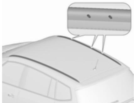
Fije el portaequipajes de techo en la zona de los orificios indicados por las flechas en la ilustración.
