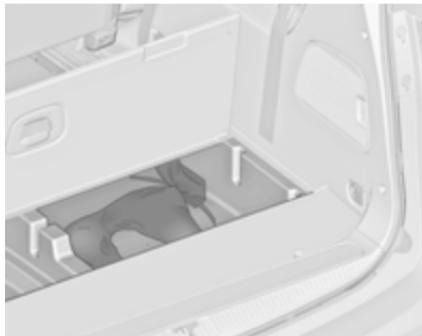
En la versión sin tercera fila de asientos, existen cajas portaobjetos bajo la cubierta del suelo. Levante la cubierta para abrir.
