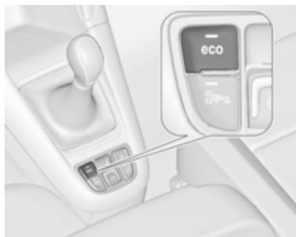
Desactive manualmente el sistema stop-start pulsando **eco**. La desactivación se indica mediante el apagado del LED del botón.
