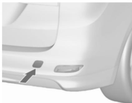
Introduzca un destornillador en la ranura del borde inferior de la tapa. Suelte la tapa moviendo cuidadosamente el destornillador hacia abajo. Para evitar daños, se recomienda colocar un paño suave entre el destornillador y el marco.
