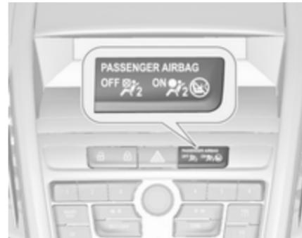
Si el testigo de control ON se ilumina durante unos 60 segundos después de conectar el encendido, el airbag frontal del acompañante se inflará en caso de colisión.
