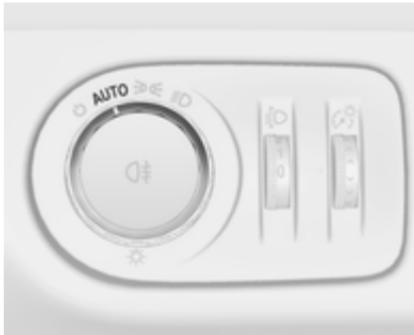
Cuando está conectada la función de control automático de las luces y el motor está en marcha, el sistema cambia entre luz de circulación diurna y conexión automática de los faros, dependiendo de las condiciones lumínicas y de la información proporcionada por el sistema del sensor de lluvia.
