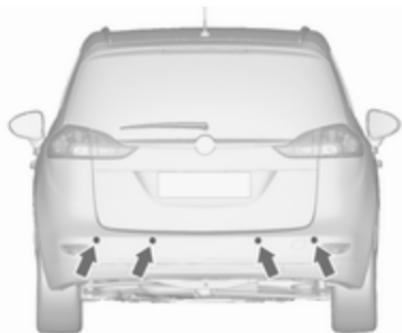
El sistema tiene cuatro sensores de aparcamiento por ultrasonidos en cada parachoques trasero y delantero.
