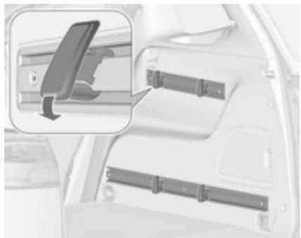
Monte los ganchos en la posición deseada en los carriles: inserte el gancho en la ranura superior del carril y encájela en la ranura inferior.
