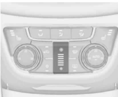
Pulse el botón inferior para reducir la velocidad del ventilador o el botón superior para aumentarla, como muestra la ilustración. La velocidad del ventilador se indica mediante el número de segmentos en la pantalla.
