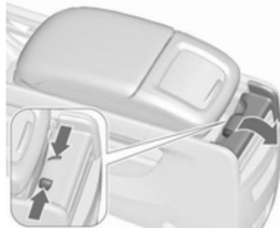
Presione las fijaciones hacia dentro y pliegue el mecanismo situado en la parte posterior del reposabrazos.
