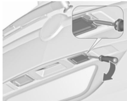
1. Meta el destornillador en la hendidura de la cubierta, presione a un lado y suelte el muelle. Desmonte la tapa.
