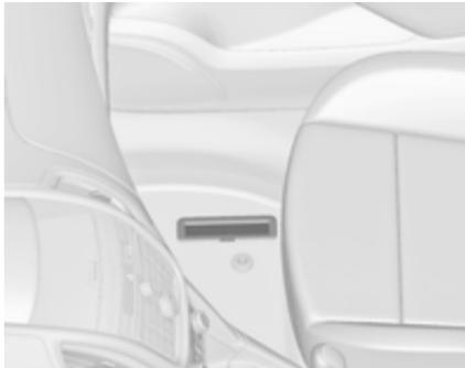
El número de identificación del vehículo puede estar estampado en la placa de características y en el panel del piso, debajo de la cubierta del piso, visible bajo una tapa.
