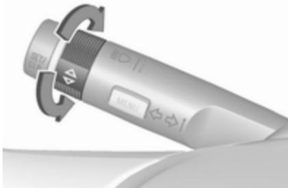
Las señales de tráfico se muestran en la página **Detección de señales de tráfico** en el centro de información del conductor, que se selecciona mediante la rueda de ajuste en la palanca de los intermitentes  $\diamond 125$ .
