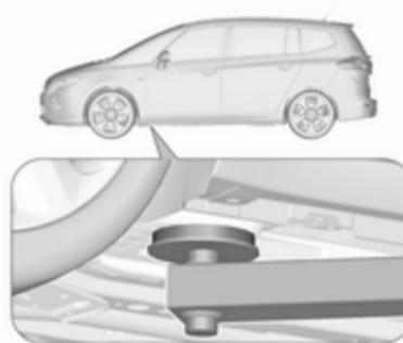
Posición del brazo trasero de la plataforma de elevación en los bajos del vehículo.
