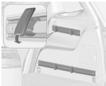
Inserte el gancho en la posición deseada, primero en la ranura superior del carril y luego encájelo en la ranura inferior. Para desmontarlo, extráigalo primero de la ranura superior.
