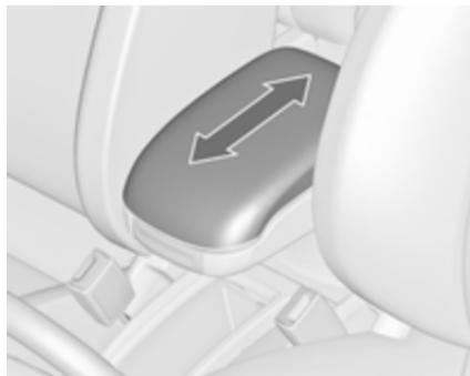
La consola del reposabrazos contiene un compartimento portaobjetos. Para abrir, deslice el reposabrazos hacia delante.
