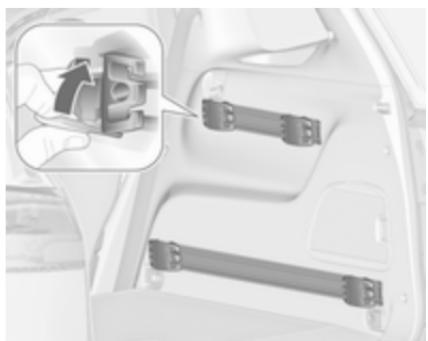
Doble hacia arriba la placa del asidero, inserte el adaptador en la ranura superior e inferior del carril y muévalo hasta la posición deseada. Gire la placa del asidero hacia arriba para bloquear el adaptador. Para desmontarla, gire la placa del asidero hacia abajo y extrágala del carril.
