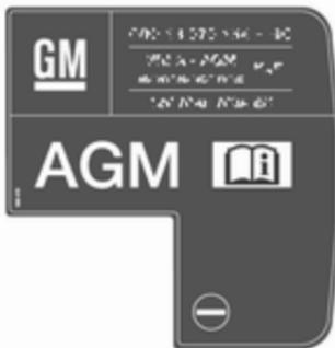
Las baterías AGM se pueden identificar por la etiqueta en la batería. Le recomendamos el uso de una batería de vehículo original Opel.
