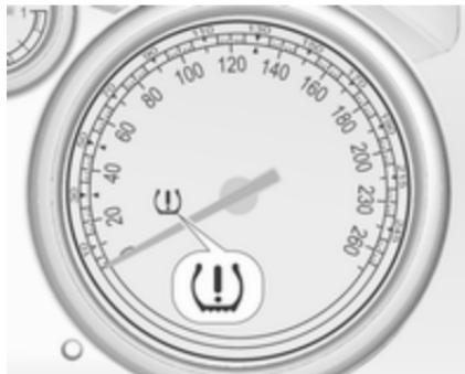
Si se detecta un problema de presión baja de los neumáticos, se indica mediante el testigo de control **122**.
