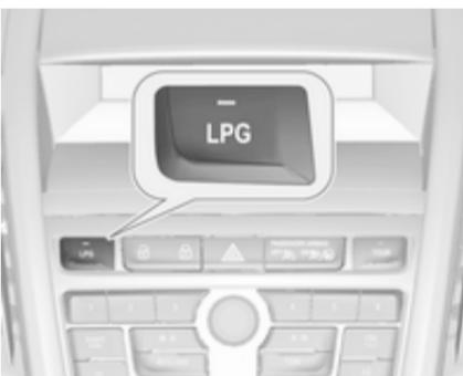
Pulsando **LPG**, el sistema cambia entre funcionamiento con gasolina y con gas licuado en cuanto se hayan alcanzado los parámetros requeridos (temperatura del refrigerante, temperatura del gas y régimen mínimo del motor). Los requisitos se suelen cumplir después de unos 60 segundos (dependiendo de la temperatura exterior) y de pisar con fuerza el acelerador. El LED de estado muestra el modo de funcionamiento actual.
