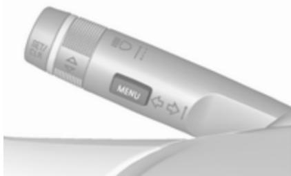
Pulse **MENU** para cambiar entre menús o para volver de un submenú al siguiente nivel superior del menú.
