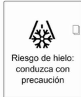
Si la temperatura exterior desciende a 3 °C, aparece un mensaje de advertencia en el centro de información del conductor con pantalla combi de gama alta.
