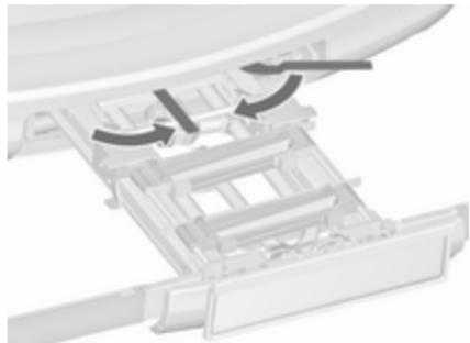
Mueva las dos palancas de fijación hacia dentro todo lo que se pueda.
