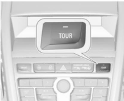
Los ajustes de los sistemas se adaptan para un estilo de conducción más confortable.
