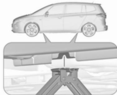
4. Asegúrese de que el gato está bien colocado en el punto de elevación correspondiente del vehículo.
