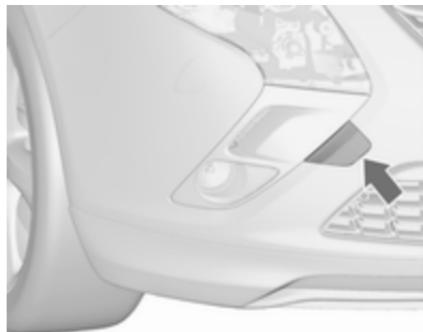
Introduzca un destornillador en la ranura del borde corto de la tapa. Suelte la tapa moviendo cuidadosamente el destornillador hacia el lateral. Para evitar daños, se recomienda colocar un paño suave entre el destornillador y el marco.
