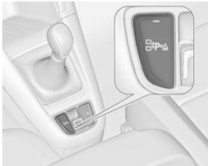
El asistente de aparcamiento delantero y trasero lleva incorporado el botón . Si el vehículo además está equipado adicionalmente con el asistente de aparcamiento avanzado (consulte la siguiente descripción separada), los dos sistemas funcionarán mediante el botón .
