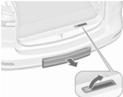
Suba el tirador de desbloqueo. El portabicicletas trasero se desacopla y sale rápidamente del parachoques trasero.
