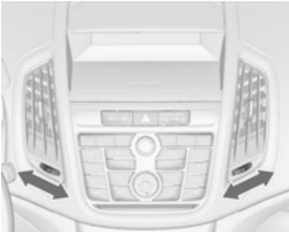
Para abrir la salida, gire la rueda de ajuste a I. Ajuste el caudal de aire de la salida de ventilación girando la rueda de ajuste.
