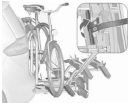
4. Pase la correa del adaptador por debajo de la palanca para plegar el portabicicletas trasero. Abroche la correa.
