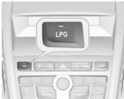
Pulse **LPG** para cambiar entre funcionamiento con gasolina y con gas líquido. El LED — de estado muestra el modo de funcionamiento actual.
