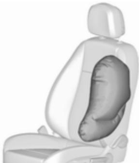
Los airbags inflados atenúan el impacto y reducen, por tanto, el riesgo de lesiones en la parte superior del cuerpo y la pelvis en el caso de que haya una colisión lateral fuerte.
