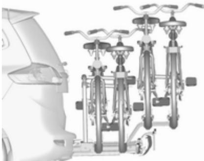
El portabicicletas trasero (sistema Flex-Fix) ofrece la posibilidad de fijar dos bicicletas en un soporte extraíble integrado en el suelo del vehículo. Se pueden sujetar dos bicicletas más en un adaptador. No se pueden transportar otros objetos.
