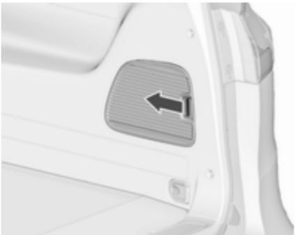
Para abrir, desbloquee y desmonte la tapa del panel de revestimiento lateral.
