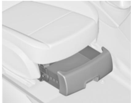
Pulse el botón en el rebaje y abra el cajón. Carga máxima: 3 kg. Para cerrar, empuje hacia adentro y encájelo.
