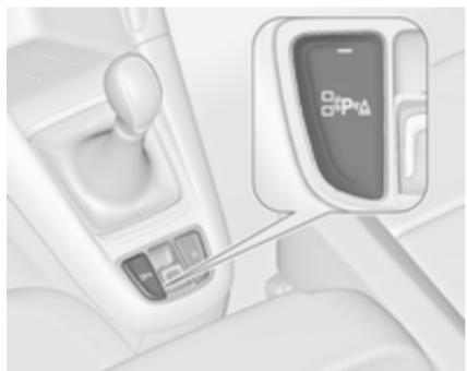
Se puede desactivar manualmente pulsando  $\text{P}^{\triangle}$  brevemente.
