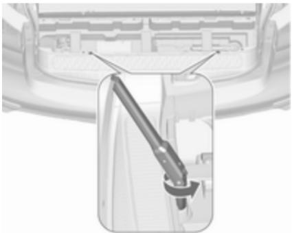
3. Sitúe la llave de tuercas de rueda sobre un perno hexagonal y gírela en sentido antihorario hasta alcanzar una resistencia evidente.
