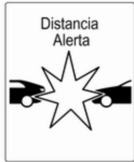
Cuando la distancia con respecto a un vehículo en movimiento que se encuentra delante es demasiado corta o al aproximarse a otro vehículo demasiado rápido con posibilidad de colisión inminente, aparece el símbolo de alerta de colisión en el centro de información del conductor.
