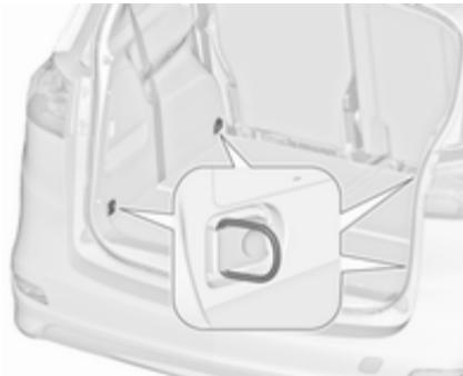
Las argollas están diseñadas para fijar las correas de amarre, o una red para el equipaje, y evitar que se desplacen los objetos transportados.
