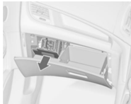
En los vehículos con volante a la derecha, la caja de fusibles está situada detrás de una tapa en la guantera. Abra la guantera, luego abra la cubierta y pliéguela hacia abajo.
