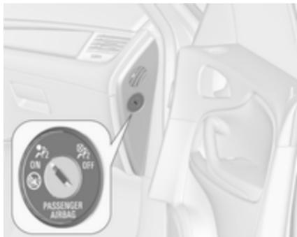
El sistema del airbag del acompañante delantero puede desactivarse con un interruptor accionado por llave situado en el lado derecho del panel de instrumentos.
