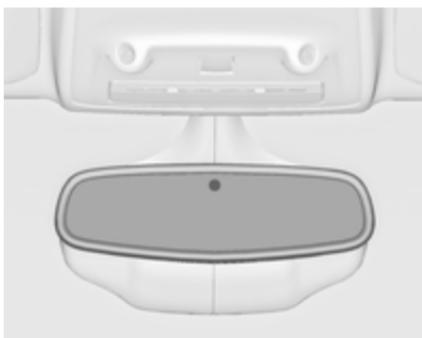
El deslumbramiento producido por los vehículos que nos siguen de noche se reduce automáticamente.
