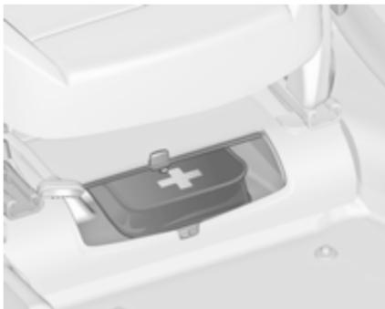
En otra versión, el botiquín está ubicado en una caja portaobjetos situada bajo el asiento del conductor. Deslice el rollo para abrir o cerrar la caja.
