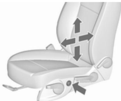
Ajuste el apoyo lumbar con el comutador de cuatro posiciones para adaptarlo a sus necesidades personales.
