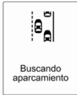
Cuando el vehículo pasa junto a una fila de coches y el sistema está activado, el sistema del asistente de aparcamiento avanzado empieza a buscar un hueco adecuado para aparcar. Al detectar un hueco ade-
