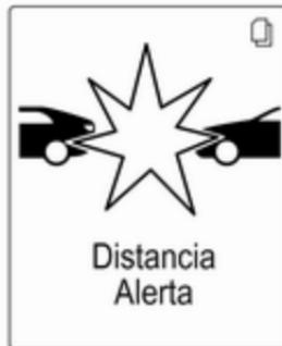
Un testigo de control de vehículo precedente se ilumina en verde en el cuadro de instrumentos cuando el sistema ha detectado un vehículo en su trayectoria de conducción.
