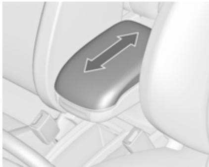
El reposabrazos se puede deslizar hacia delante. Debajo del reposabrazos hay un cajón portaobjetos.
