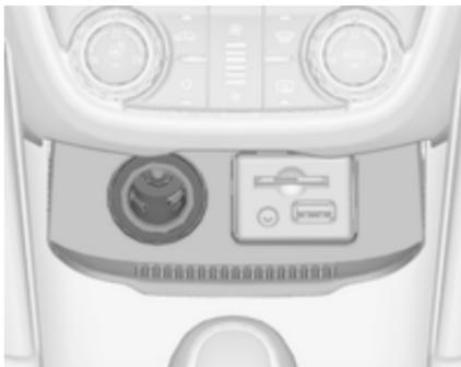
Hay una toma de corriente de 12 V situada en la consola delantera. Pliegue la cubierta hacia abajo.
