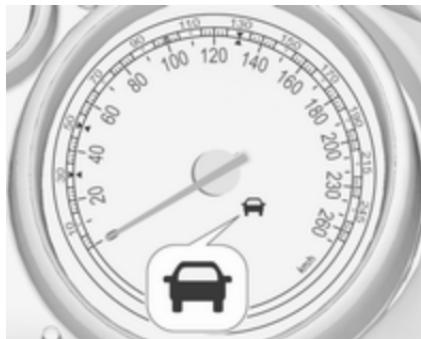
El testigo de control "vehículo de-lante"
