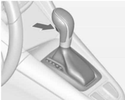
**P** = posición de estacionamiento, las ruedas están bloqueadas; sólo se debe seleccionar con el vehículo parado y el freno de estacionamiento accionado
