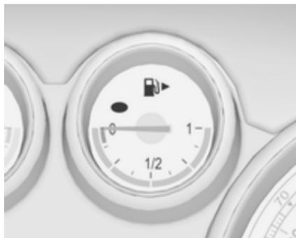
Indica el nivel de combustible, o la presión de gas, en el depósito según el modo de funcionamiento.
