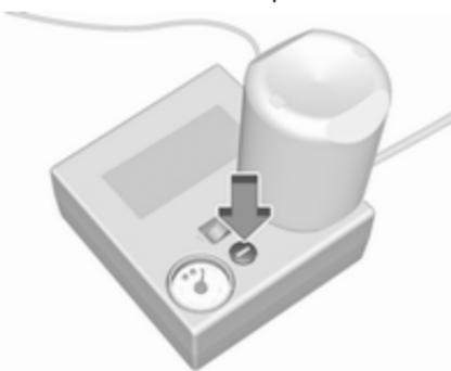
Si la presión prescrita no se alcanza en un plazo de 10 minutos, desconecte el juego de reparación de neumáticos. Haga girar el neumático una vuelta completa. Vuelva a conectar el juego de reparación de neumáticos y continúe el proceso de inflado durante
