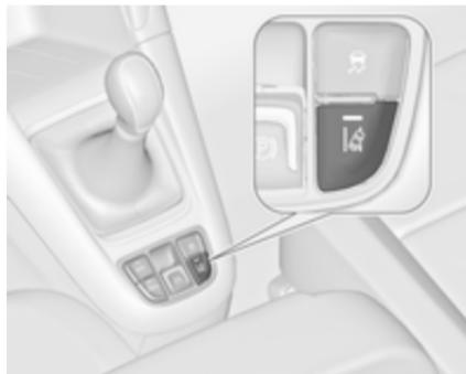
El sistema de aviso de cambio de carril se activa pulsando . El LED encendido en el botón indica que el sistema está conectado. Cuando el testigo de control en el cuadro de instrumentos se enciende en verde, el sistema está listo para funcionar.
