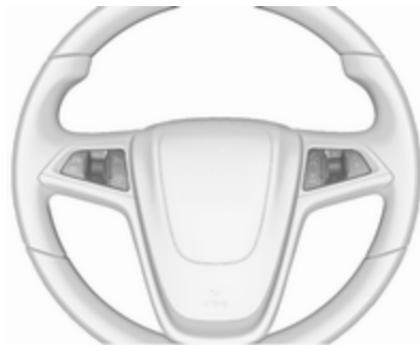
Se pueden manejar con los mandos en el volante el sistema de infoentretenimiento, algunos sistemas de ayuda a la conducción y un teléfono móvil conectado.
