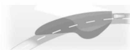
El haz de luz gira en función del ángulo del volante y de la velocidad, mejorando la iluminación en curvas.
