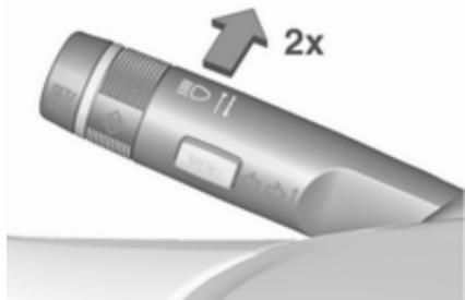
La asistencia de luz de carretera se activa pulsando dos veces la palanca del intermitente superando una velocidad de 40 km/h.
