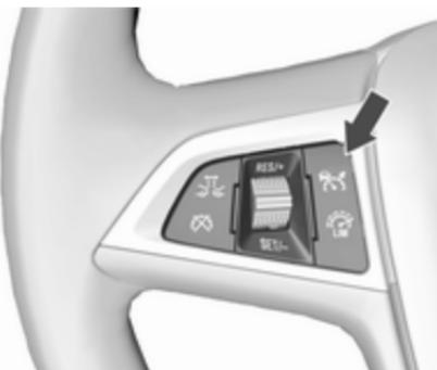
Pulse para activar el control de velocidad adaptable. El testigo de control se enciende en blanco.
