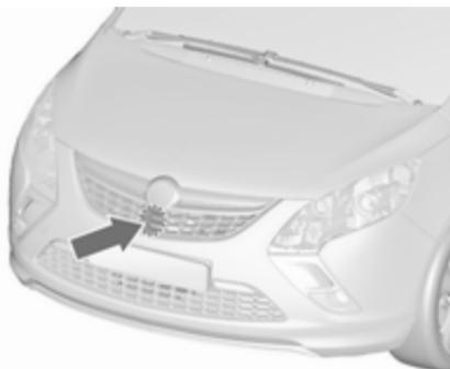
La unidad de radar está montada tras la rejilla del radiador, debajo del emblema de la marca.
