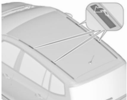
Para fijar un portaequipajes de techo, abra las tapas de las bandas del techo. Introduzca las provisiones de montaje, según instrucciones, en el dispositivo de retención indicado en la ilustración.
