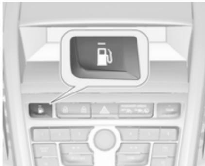
Pulse □ para cambiar entre funcionamiento con gasolina y con gas natural. El LED ■ de estado muestra el modo de funcionamiento actual.
