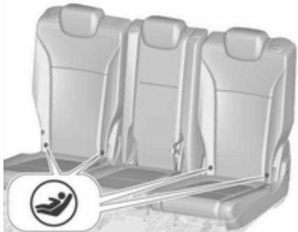
Fije los sistemas de seguridad infantil ISOFIX homologados para el vehículo a los soportes de montaje ISOFIX. Las posiciones específicas del vehículo para los sistemas de retención infantil ISOFIX están marcadas mediante "IL" en la tabla.
