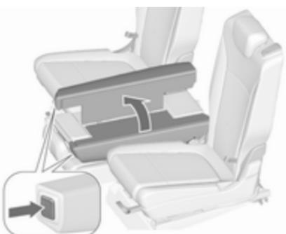
■ Pulse los botones izquierdo y derecho junto al reposacabezas central y pliegue las partes exteriores del respaldo para usarlas como reposabrazos. Enclave las partes del respaldo en la posición de reposabrazos.
