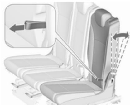
Levante el respaldo en posición vertical. Ajuste la inclinación tirando de la correa.
