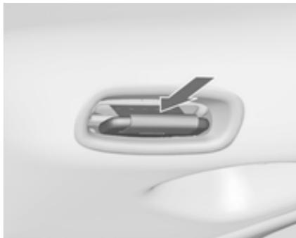
Insértelas en el alojamiento del cinturón de seguridad en el techo con la lengüeta inferior hacia delante.
