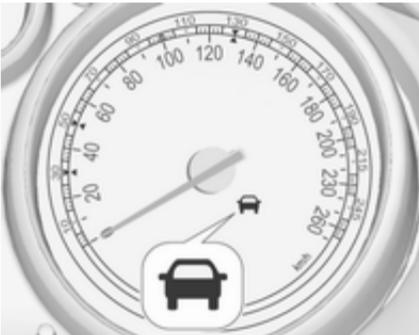
Un vehículo que se encuentra delante se indica mediante un testigo de control
