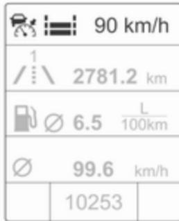
El símbolo del control de velocidad adaptable, el ajuste de distancia hacia delante y la velocidad establecida se indican en la línea superior del centro de información del conductor.
