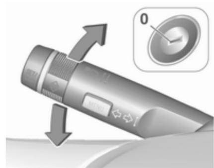
Cuando el vehículo está aparcado, se pueden activar las luces de estacionamiento de un lado:
