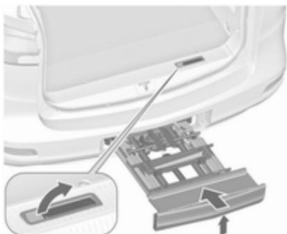
Mantenga levantada la palanca de desbloqueo. Suba ligeramente el portabicicletas trasero e introduzcalo en el parachoques hasta que quede enclavado.
