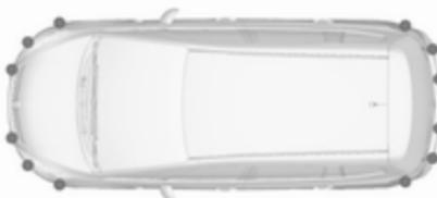
El sistema del asistente de aparcamiento avanzado guía al conductor a la hora de aparcar mediante instrucciones en el centro de información del conductor y señales acústicas. El conductor debe controlar la aceleración, frenado, dirección y cambio de marchas.
