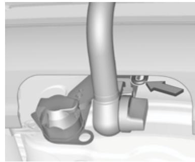
Enganche el cable de ruptura en la argolla.
