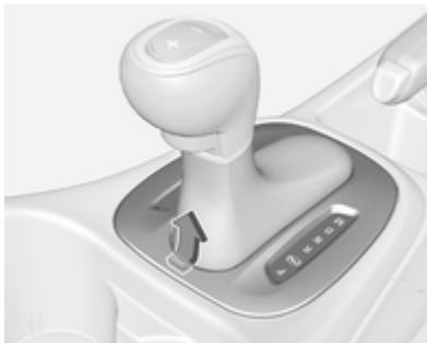
2. Suelte el revestimiento de la palanca selectora de la consola central; empuje con un dedo en el hueco de piel delante de la palanca selectora y presione el revestimiento hacia arriba en el borde delantero desde abajo, como se muestra en la ilustración. Gire el revestimiento hacia la izquierda.
