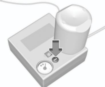
Si la presión prescrita no se alcanza en un plazo de diez minutos, desconecte el juego de reparación de neumáticos. Haga girar el neumático una vuelta completa. Vuelva a conectar el juego de reparación de neumáticos y continúe el proceso de inflado durante diez minutos.
