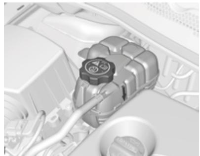
Con el sistema de refrigeración frío, el nivel del refrigerante debe estar por encima de la marca de la línea de llenado.
