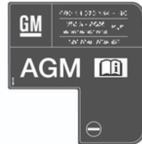
Las baterías AGM se pueden identificar por la etiqueta en la batería. Le recomendamos el uso de una batería original Opel.
