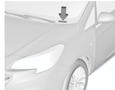
El número de identificación del vehículo puede estar estampado en el cuadro de instrumentos, visible a través del parabrisas, o en el compartimento del motor en el panel derecho de la carrocería.
