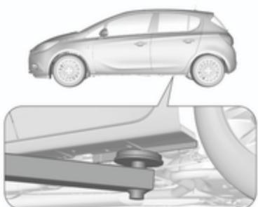
Posición del brazo trasero de la plataforma elevadora ubicado en la parte central bajo el rebaje del estribo.
