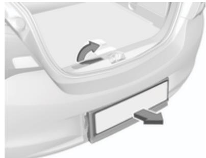
Levante la palanca de desbloqueo. El sistema se desenclava y sale rápidamente del parachoques.
