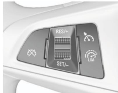
Pulse . Si el regulador de velocidad se ha activado anteriormente, se desconecta al activarse el limitador de velocidad y se apaga el testigo de control .
