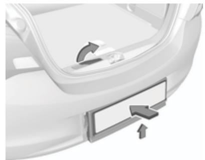
Mantenga levantada la palanca de desbloqueo. Suba ligeramente el sistema e introduzcalo en el parachoques hasta que quede enclavado.
