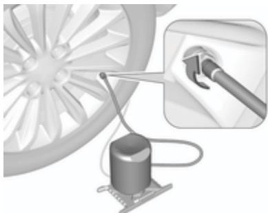
4. Desenrosque el tapón de la válvula del neumático averiado.
