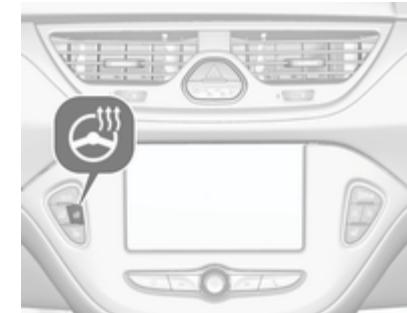
Active la calefacción pulsando ☀. La activación se indica mediante el LED del botón.
