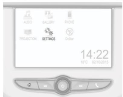
Seleccione **Configuración** y luego **Ajustes del vehículo**.
