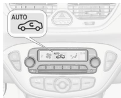
Los ajustes de la climatización se muestran en la pantalla de información. Las modificaciones de ajuste se muestran brevemente, superimpuestas sobre el menú que se muestra actualmente.
