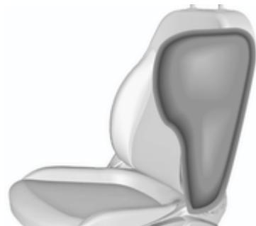
Los airbags inflados atenúan el impacto y reducen, por tanto, el riesgo de lesiones en la parte superior del cuerpo y la pelvis en el caso de que haya una colisión lateral fuerte.
