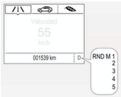
En modo automático, el programa de conducción se indica mediante **D** en el Centro de información del conductor.
