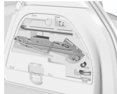
El gato, la llave para tornillos de rueda y algunas herramientas se encuentran en el lado derecho del compartimento de carga, detrás de una cubierta ▷ 73.
