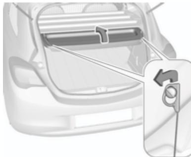
Para desmontar la cubierta trasera, desenganche las cintas de sujeción del portón trasero.
