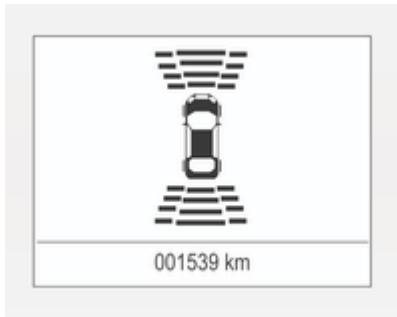
La indicación de distancia puede verse solapada por mensajes del vehículo con mayor prioridad. Después de descartar el mensaje, la indicación de distancia vuelve a aparecer.
