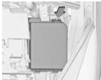
La caja de fusibles está en la parte delantera izquierda del compartimiento del motor.
