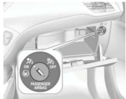
Utilice la llave del encendido para seleccionar la posición del interruptor:
