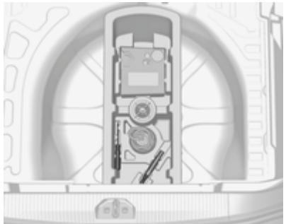
Las herramientas se encuentran juntas con la argolla de remolque y el juego de reparación de neumáticos en el compartimento de carga debajo de la cubierta del piso.
