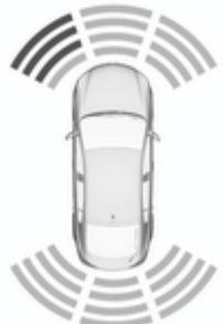
La distancia hasta los obstáculos se muestra en la pantalla de información en color mediante zonas de colores delante y detrás del vehículo ▷ 104.
