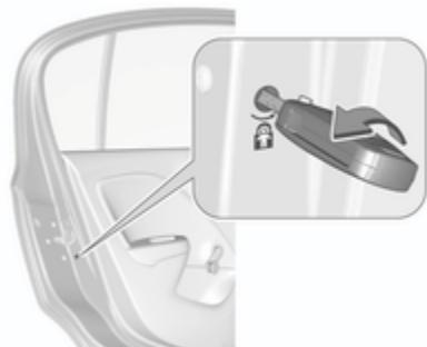
Usando una llave o un destornillador adecuado, gire el interruptor en la cerradura de la puerta trasera hasta la posición vertical. La puerta no puede abrirse desde el interior.
