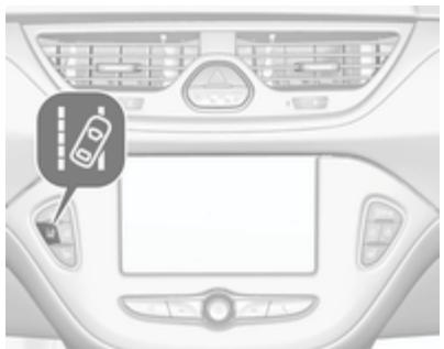
El sistema de aviso de cambio de carril se activa pulsando . El LED encendido en el botón indica que el sistema está conectado. Cuando el testigo de control en el cuadro de instrumentos se enciende en verde, el sistema está listo para funcionar.
