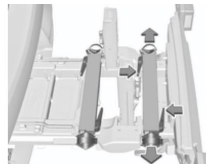
Pulse la palanca de desbloqueo y extraiga los alojamientos para las ruedas.
