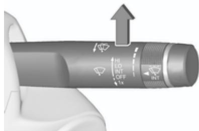
**INT** : funcionamiento automático con sensor de lluvia
