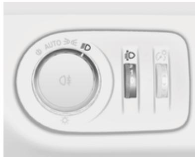
Para adaptar el alcance de los faros a la carga del vehículo y evitar el deslumbramiento: gire la rueda de ajuste hasta la posición requerida.
