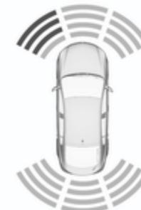
La distancia hasta los obstáculos se muestra en la pantalla de información en color mediante zonas de colores delante y detrás del vehículo  $\Rightarrow$  104.
