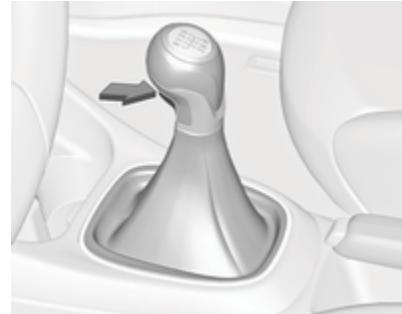
Para engranar la marcha atrás, pise el pedal de embrague, después, pulse el botón de desbloqueo de la palanca selectora y engrane la marcha.
