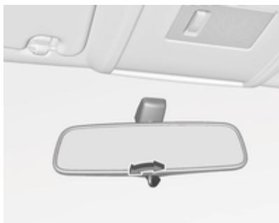
Para reducir el deslumbramiento, ajuste la palanca que hay debajo de la carcasa del espejo.
