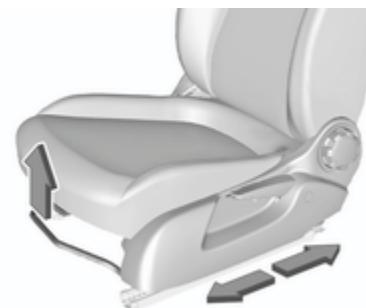
Tire del asidero, deslice el asiento, suelte el asidero. Intente mover el asiento hacia delante y hacia atrás para asegurarse de que el asiento está bloqueado en su posición.
