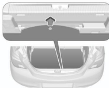
Levante la cubierta del piso trasero para poder acceder al equipo de reparación de averías de emergencia.
