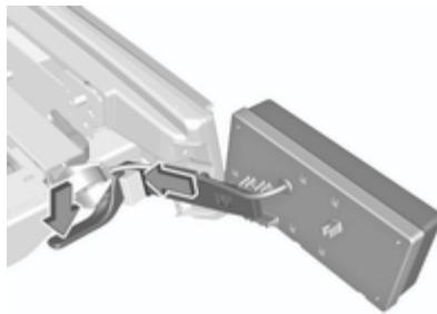
Baje la palanca tensora e inserte el soporte en el alojamiento hasta que enclave.
