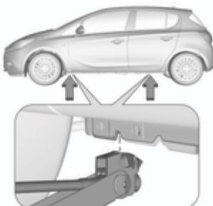
3. Asegúrese de que el gato está bien colocado en el punto de elevación correspondiente del vehículo.
