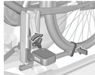
Apriete al máximo manualmente el tornillo de la fijación para la biela.
