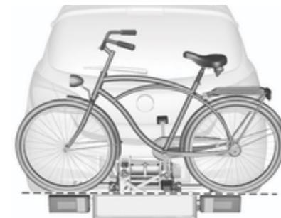
Ajuste los alojamientos para las ruedas de modo que la bicicleta quede en posición horizontal. La separación entre los pedales y el portón trasero debería ser de 5 cm como mínimo.
