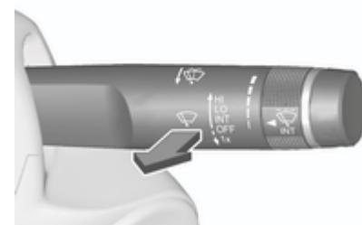
Tire de la palanca. Se pulveriza líquido de lavado sobre el parabrisas y el limpialuneta se realiza el barrido varias veces.
