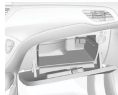
Tire de la palanca para abrir la tapa de la guantera.
