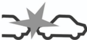
Cuando el tiempo hasta una posible colisión con un vehículo precedente es demasiado corto y la colisión es inminente, aparece el símbolo de alerta de colisión en el centro de información del conductor y el conductor recibe una notificación con una tira de LED rojos intermitentes que se proyecta en el parabrisas del campo de visión del conductor.
