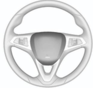
El sistema del airbag delantero se activa en caso de impacto frontal de una cierta gravedad. El encendido debe estar conectado.
