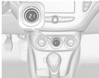
Si se ajusta la temperatura mínima **Lo**, el climatizador automático funciona a la máxima potencia de refrigeración siempre que se conecte la refrigeración
