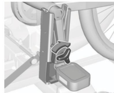
Gire el tornillo de apriete para sujetar la biela a la fijación correspondiente.
