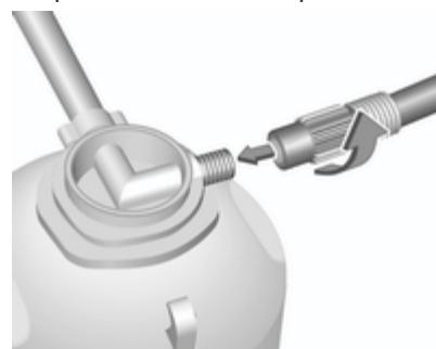
4. Enrosque el tubo flexible de aire del compresor a la conexión en el bote de sellador.
