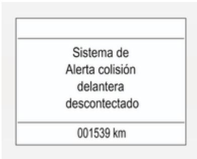
Si se ha desactivado la alerta de colisión frontal, la sensibilidad de la alerta se configura como "media" al encender el contacto la próxima vez. La configuración "cerca", "medio" o "lejos" se almacenará cuando se apague el encendido.
