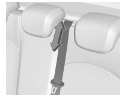
El cinturón de seguridad del asiento central podría bloquearse si el respaldo se endereza demasiado rápidamente. Para desbloquear el retractor, introduzca el cinturón de seguridad o tire de él unos 20 milímetros y luego suéltelo.
