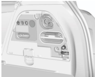
En la versión OPC o LPG o en versiones con portabicicletas trasero o piso de carga doble, las herramientas se encuentran junto con la argolla de remolque y el juego de reparación de neumáticos en el lado derecho del compartimento de carga detrás de una cubierta.
