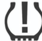
Si se detecta un problema de presión baja de los neumáticos, se indica mediante el testigo de control
