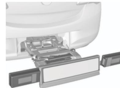
Compruebe la correcta instalación y colocación de los cables y la posición de las luces.
