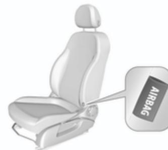
El sistema de airbags laterales se compone de un airbag en cada respaldo de los asientos delanteros. La ubicación se puede identificar por el rótulo **AIRBAG**.
