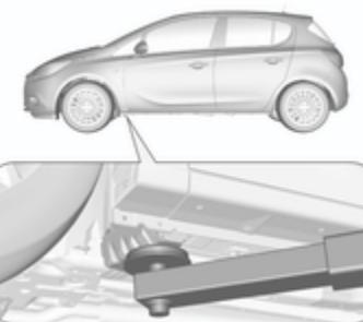
Posición del brazo delantero de la plataforma elevadora en los bajos.
