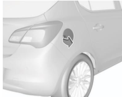
La tapa del depósito sólo se puede abrir con el vehículo desbloqueado. Desbloquee la tapa del depósito de combustible pulsando sobre la misma.
