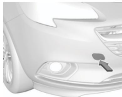
Introduzca un destornillador en la ranura de la parte inferior de la tapa. Suelte la tapa moviendo cuidadosamente el destornillador hacia abajo. La argolla de remolque se guarda con las herramientas del vehículo ▷ 223.
