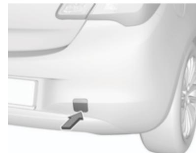
Introduzca un destornillador en la ranura de la curva inferior de la tapa. Suelte la tapa moviendo cuidadosamente el destornillador hacia abajo.
