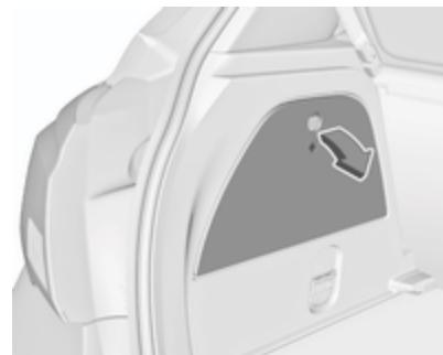
1. Suelte la cubierta del compartimiento de carga del lado correspondiente y extrágala.
