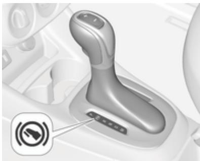
Si el pedal del freno no está pisado, se enciende el testigo de control
