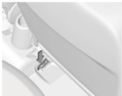
**Argolla de fijación de los anclajes en el asiento del acompañante**
