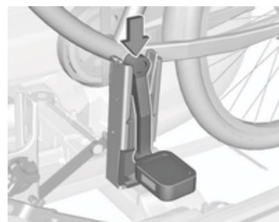
Coloque la bicicleta. La biela debe colocarse en el hueco del alojamiento para la biela, como se muestra en la ilustración.
