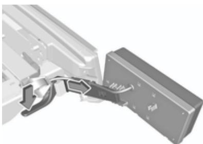
Baje la palanca de retención y extraiga los dos soportes de las luces de sus alojamientos.
