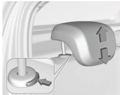
Tire del reposacabezas hacia arriba y deje que se enclave. Para bajarlo, pulse el resorte para desbloquearlo y empuje el reposacabezas hacia abajo.
