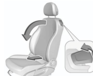
Tire de la palanca de desbloqueo hacia delante e incline el respaldo hacia delante. Luego deslice el asiento hacia delante hasta el tope.
