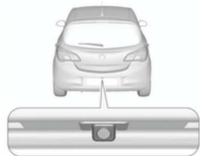
La cámara está montada entre las luces de la matrícula y ofrece un ángulo de visión de 130°.
