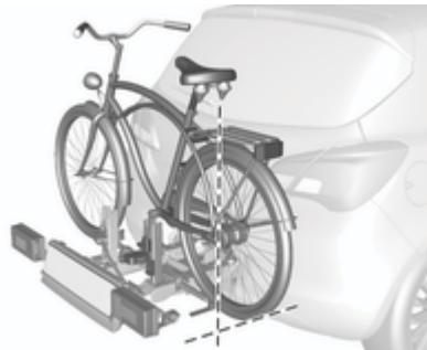
Alinee la bicicleta en sentido longitudinal respecto al vehículo. Afloje ligeramente la fijación para la biela.
