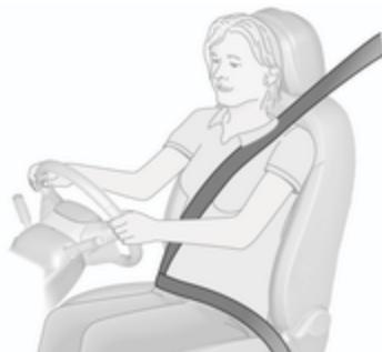
Extraiga el cinturón de seguridad y enclávelo en el cierre. El cinturón de seguridad no debe estar retorcido y debe quedar bien ajustado al cuerpo. El respaldo no debe estar demasiado inclinado hacia atrás (máximo aprox. 25°).
