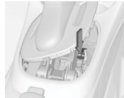
3. Presione la palanca de liberación hacia abajo y saque la palanca selectora de P o N. Si se seleccionan de nuevo estas posiciones, la palanca selectora volverá a bloquearse. Haga subsanar la causa de la interrupción de corriente en un taller.
