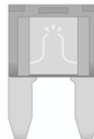
Dependiendo del tipo de fusible, un fusible defectuoso puede reconocerse por su filamento fundido. No sustituya el fusible hasta que se subsane la causa de la avería.
