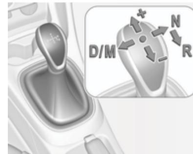
La palanca selectora siempre debe moverse en la dirección apropiada todo lo que sea posible. Una vez que la suelte, volverá automáticamente a la posición central.
