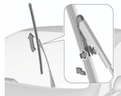
Levante el brazo del limpiaparabrisas hasta que permanezca en la posición elevada. Presione las fijaciones de ambos lados, incline la hoja de la escobilla en ángulo de 90° del brazo del limpiaparabrisas y extraiga hacia arriba.
