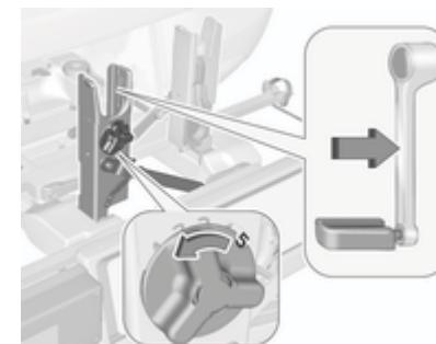
Con el asa giratoria del alojamiento, adapte aproximadamente el asiento para la biela del pedal a la inclinación de la biela.
