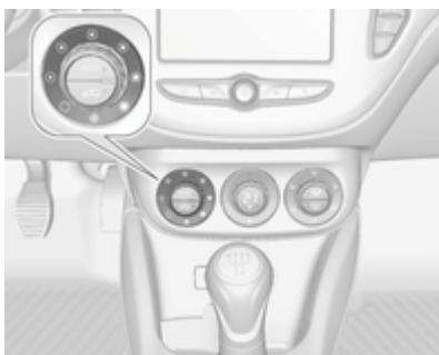
Gire el mando giratorio izquierdo para aumentar o disminuir la velocidad del ventilador. La velocidad del ventilador se indica en la pantalla de información.
