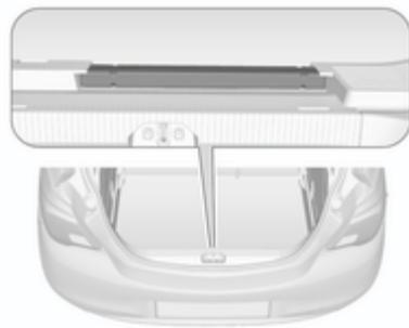
El triángulo de advertencia se guarda en el compartimento de carga, debajo del portón trasero.
