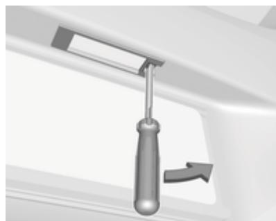
1. Meta el destornillador en la hendidura de la cubierta, presione a un lado y suelte el muelle.
