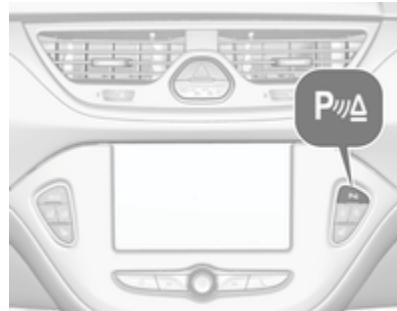
Si está iluminado el LED situado en el botón del asistente de aparcamiento **P $\parallel\Delta$** , indica que el sistema está listo para funcionar.
