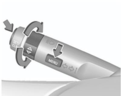
Seleccione mediante **MENU** y seleccione la página del asistente de señales de tráfico con la rueda de ajuste en la palanca del intermitente  $\Rightarrow$  100.
