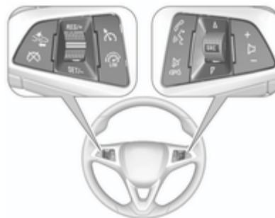
Los mandos del volante pueden emplearse para utilizar el regulador de velocidad, el limitador de velocidad, la configuración de alerta de colisión frontal, el sistema de infoentretenimiento y un móvil conectado.
