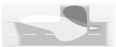
En giros cerrados o cruces, dependiendo del ángulo de la dirección o de los intermitentes, se conecta un reflector adicional en el lado izquierdo o derecho que ilumina la carretera en la dirección de marcha. Se activa hasta una velocidad máxima de 40 km/h.
