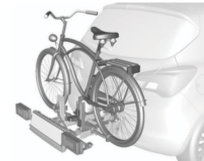
El portabicicletas trasero (sistema Flex-Fix) ofrece la posibilidad de fijar bicicletas en un soporte extraíble integrado en el piso del vehículo. No se permite el transporte de otros objetos.
