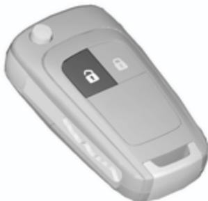
Pulse para desbloquear las puertas y el compartimento de carga. Abra las puertas tirando de la manilla correspondiente.
