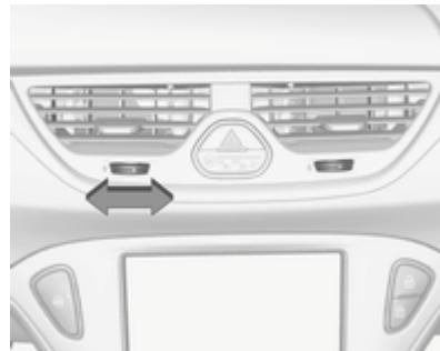
Ajuste el caudal de aire de la salida de ventilación girando la rueda de ajuste. La salida se cierra cuando la rueda de ajuste está girada a tope hacia la izquierda o la derecha.
