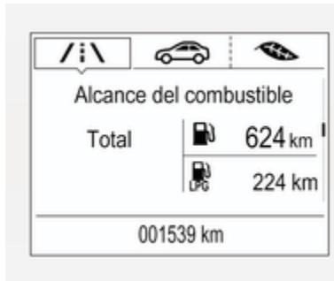
Muestra el alcance del combustible total aproximado para cada depósito de combustible (LPG y gasolina). Un nivel de combustible bajo en cualquier depósito se indica mediante **BAJO** en la sección correspondiente.
