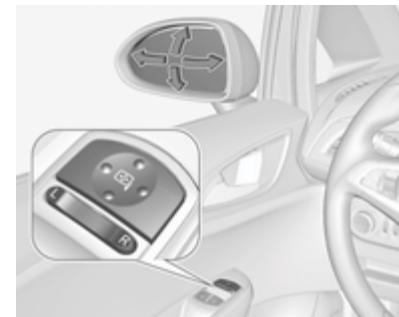
Seleccione el retrovisor exterior correspondiente pulsando el interruptor basculante a la izquierda (L) o a la derecha (R). Luego bascule el mando
