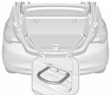
Las argollas están diseñadas para fijar las correas de amarre, o una red para el equipaje, y evitar que se desplacen los objetos transportados.
