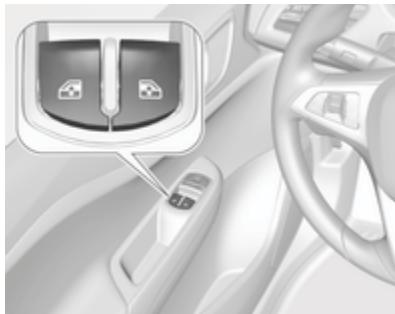
Accione el interruptor del revestimiento de la puerta de la ventanilla correspondiente: pulse para abrir o tire para cerrar.
