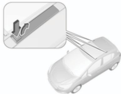
Desenganche las tapas de las aberturas de montaje para el portaequipajes de techo presionando las correderas en la dirección de la flecha y sacándolas hacia arriba. Para cerrar las tapas, inserte primero la parte delantera y luego enclave las correderas en la parte trasera.
