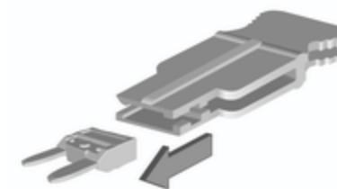
Coloque el extractor de fusibles en la parte superior de los diversos tipos de fusibles correspondiente y extraiga el fusible.
