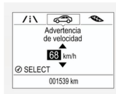
La función de aviso de velocidad alerta al conductor cuando se excede una velocidad definida.
