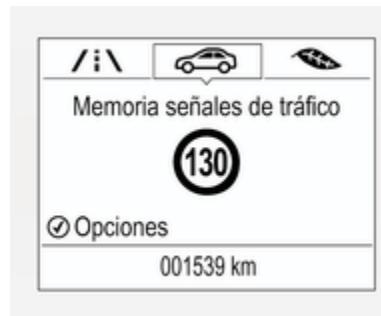
Una vez activada y cuando la página de detección de señales de tráfico no se muestre, se muestran el límite de velocidad y las señales de no adelantar nuevas detectadas como alertas en el centro de información del conductor.
