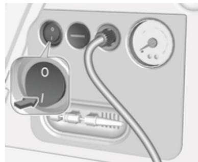
8. Pulse el interruptor de activación/desactivación del compresor. El neumático se llenará con el sellador.
