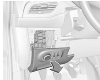
La caja de fusibles está detrás del conmutador de las luces en el tablero de instrumentos. Sujete la manilla, luego tire y saque el conmutador de las luces.
