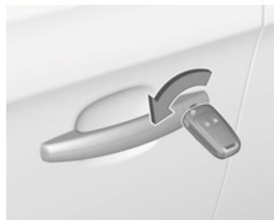
Desbloquee manualmente la puerta del conductor girando la llave en la cerradura. Conecte el encendido y pulse el botón del cierre centralizado para desbloquear todas las puertas, el compartimento de carga y la tapa del depósito de combustible.
