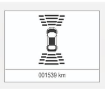
La distancia hasta los obstáculos delante y detrás se muestra mediante líneas de distancia cambiantes en el centro de información del conductor  $\Rightarrow$  100.
