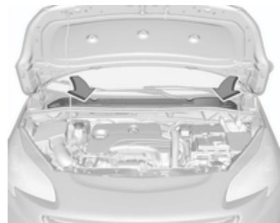
La entrada de aire en el compartimento del motor, delante del parabrisas, debe estar libre para permitir la entrada de aire. Retire cualquier resto de hojas, suciedad o nieve.
