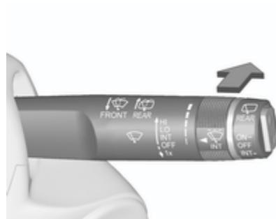
Presione la palanca. Se pulveriza líquido de lavado sobre la luneta trasera y el limpialuneta se realiza el barrido varias veces.
