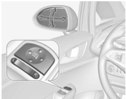
Seleccione el retrovisor exterior correspondiente con el interruptor basculante y ajuste el espejo con el mando .
