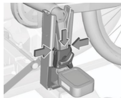
Inserte la fijación para la biela en el carril exterior del alojamiento desde arriba, y deslícela hacia abajo hasta debajo de la muesca como mínimo.
