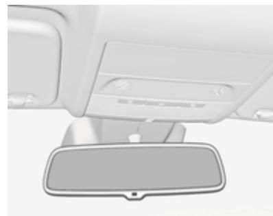
Se reduce automáticamente el deslumbramiento de los vehículos que tiene detrás por la noche.
