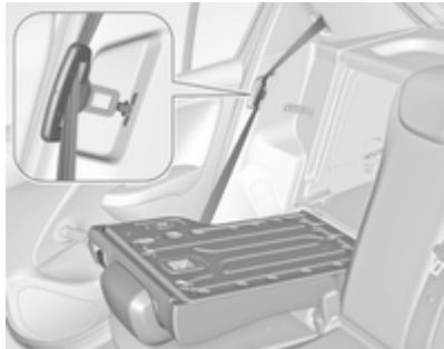
Si se va a cargar el vehículo por una de las puertas traseras, saque el cinturón de seguridad de la guía del res-
