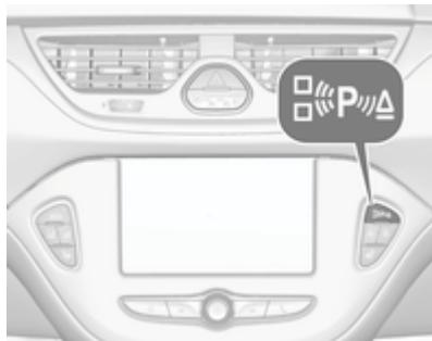
Cuando busque un hueco para aparcar, el sistema está listo para funcionar con una pulsación prolongada de **P<sub>W</sub>A**.
