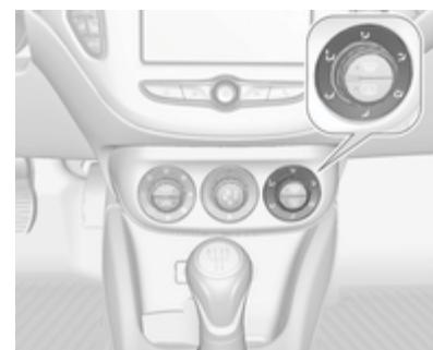
Gire el mando giratorio derecho para seleccionar el ajuste deseado. El ajuste se indica en la pantalla de información.
