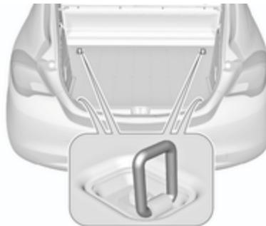
Las cargas se pueden asegurar con cuatro argollas en el compartimento de carga
