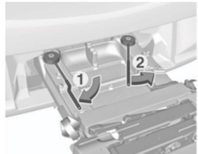
Bascule las palancas tensoras, primero la izquierda (1) y luego la derecha (2), hasta que lleguen al tope. Las dos palancas tensoras deben señalar hacia atrás; en caso contrario, no estará garantizado un funcionamiento seguro.
