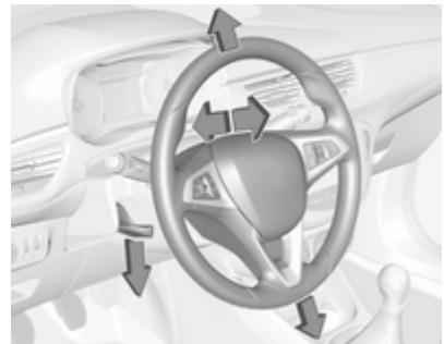
Desbloquee la palanca, ajuste el volante, luego enclove la palanca y asegúrese de que esté totalmente bloqueada.
