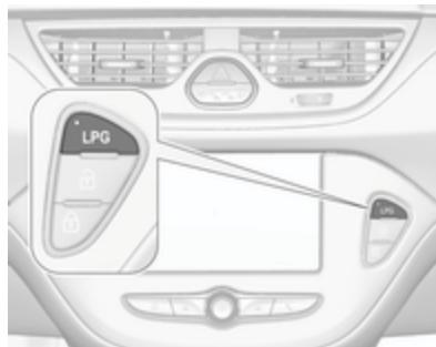
Pulse LPG para cambiar entre funcionamiento con gasolina y con gas líquido. El LED del botón muestra el modo de funcionamiento actual.
