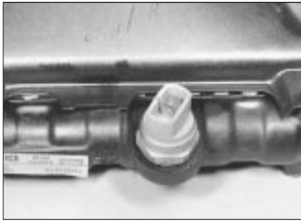
7.3 Cooling fan thermo-switch
