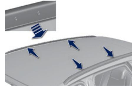
Debe fijar las barras transversales a las barras longitudinales respetando los puntos de fijación señalados mediante las marcas grabadas en las barras longitudinales.
