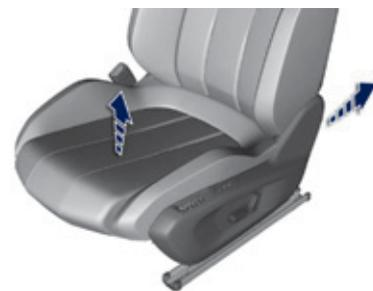
**Con el asiento del acompañante regulado en posición alta y en posición longitudinal retrocedido al máximo.**
