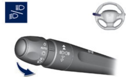
Tire del mando para conmutar el encendido de las luces de cruce/carretera.
