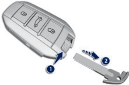
La llave integrada permite bloquear o desbloquear el vehículo cuando no funciona la llave electrónica debido a que:
