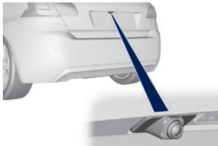
La cámara se activa automáticamente al introducir la marcha atrás. Según la versión, la imagen capturada se indicará en la pantalla táctil o en el cuadro de a bordo.
