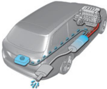
El aditivo AdBlue® está almacenado en un depósito específico, situado bajo el maletero, en la parte trasera del vehículo. Su capacidad es de 17 litros, lo que garantiza una autonomía de circulación de aproximadamente 20.000 km antes de la activación de un dispositivo de alerta que le avisa de que el nivel de reserva le permitirá recorrer hasta 2.400 km.
