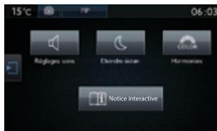
Permite configurar el sonido (balances, ambientes, etc.) los universos gráficos, la intensidad luminosa del puesto de conducción, la pantalla (idioma, unidades, fecha, hora, etc.) y acceder a una ayuda interactiva en relación con los principales equipos y testigos luminosos del vehículo.
