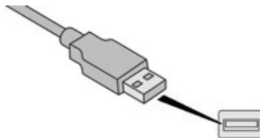
Conectar el reproductor Apple® a la toma USB mediante un cable adaptado (no incluido). La reproducción comienza automáticamente.
