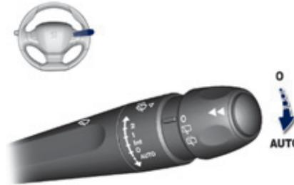
**i** Es necesario volver a activar el barrido automático después de haber cortado el contacto durante más de un minuto, accionando el mando hacia abajo.
