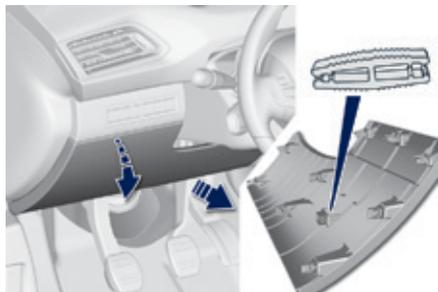
La pinza de extracción está fijada en el interior de la tapa de la caja de fusibles del salpicadero.
