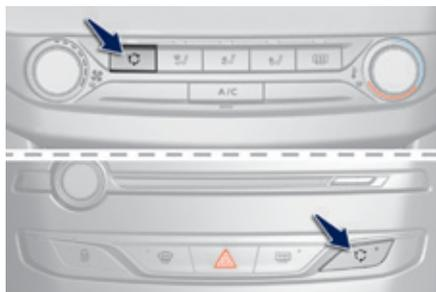
La entrada de aire exterior evita la formación de vaho en el parabrisas y las lunas laterales. El reciclado del aire interior permite aislar el habitáculo de los olores y humos exteriores.
