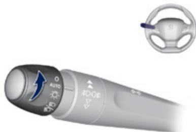
Si el sensor detecta poca luminosidad exterior, las luces de matrícula, de posición y de cruce se encienden automáticamente sin intervención por parte del conductor. Asimismo, en caso de detección de lluvia, las luces se encenderán junto con los limpiaparabrisas delanteros. En cuanto la luminosidad vuelve a ser suficiente, o al desactivar los limpiaparabrisas, las luces se apagan automáticamente.
