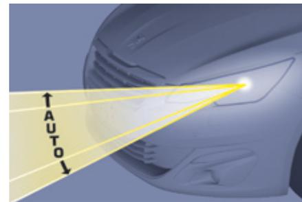
Para no molestar a los demás usuarios de la vía, este sistema corrige automáticamente la altura del haz de luz de las lámparas "full leds", en función de la carga del vehículo.
