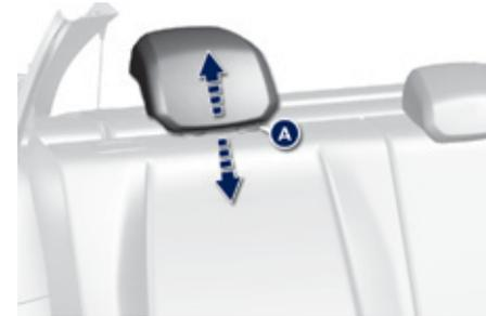
Cuentan con una única posición de uso (alta) y una posición de reposo (baja). Los reposacabezas son desmontables e intercambiables.
