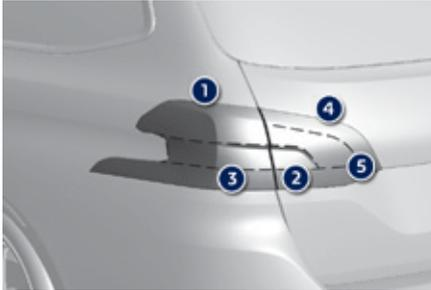
1. Luces de posición (diodos electroluminiscentes-LED)
