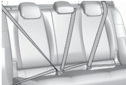
Cada una de las plazas traseras está equipada con un cinturón de seguridad, provisto de tres puntos de anclaje y un carrete enrollador con limitador de esfuerzo (salvo para el pasajero trasero central).
