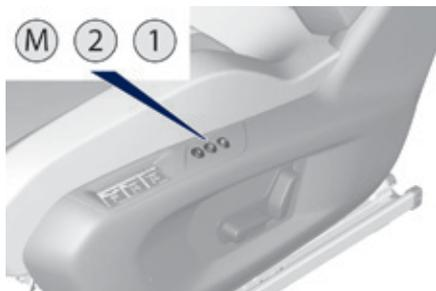
Sistema que permite memorizar los reglajes eléctricos del asiento del conductor y de los retrovisores exteriores.
