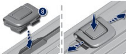
8. Anillas de sujeción de la red (retención de equipaje) (según versión)
