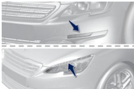
Se encienden automáticamente al arrancar el motor, cuando el mando de luces está en la posición "0" o "AUTO".
