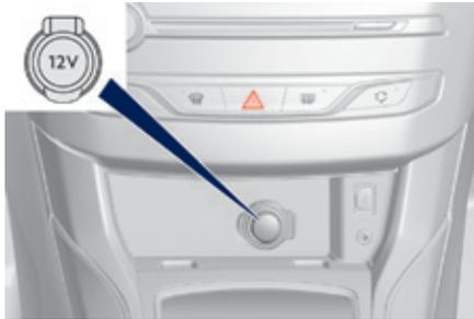
☞ Para conectar un accesorio de 12 V (potencia máxima: 120 vatios), abra la tapa y conecte el adaptador adecuado.
