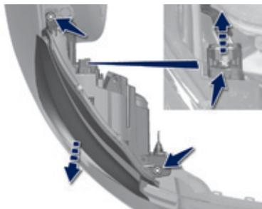
Para desplazar el piloto unos centímetros hacia adelante y poder así acceder a las lámparas, proceda de la siguiente manera:
