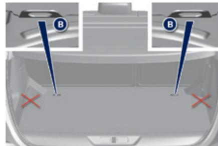
Una anilla **B** situada en el maletero (identificada mediante una marca), denominada **TOP TETHER**, que permite la fijación de la correa superior.
