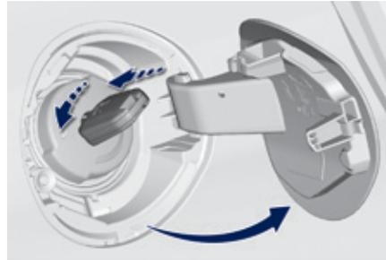
Los repostajes de carburante deben ser superiores a 10 litros para que el indicador de nivel los tenga en cuenta. La apertura del tapón puede generar un ruido de aspiración de aire, que es completamente normal y se debe a la depresión provocada por la estanqueidad del circuito de carburante.
