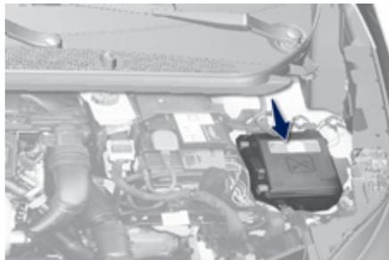
La caja de fusibles está situada en el compartimento motor, cerca de la batería.
