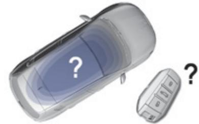
Si, al cerrar un acceso o al accionar la parada del motor, la llave electrónica no se encuentra en la zona de detección, aparece un mensaje en el cuadro de a bordo.
