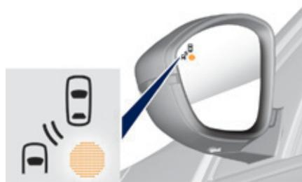
En el retrovisor del lado correspondiente se enciende un testigo luminoso fijo:
