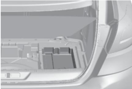
El espacio para guardar el triángulo plegado o su caja de almacenamiento está situado bajo el suelo del maletero.
