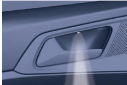
De noche, las luces de techo y de los mandos de apertura interior de las puertas delanteras se encienden automáticamente al encender las luces de posición.
