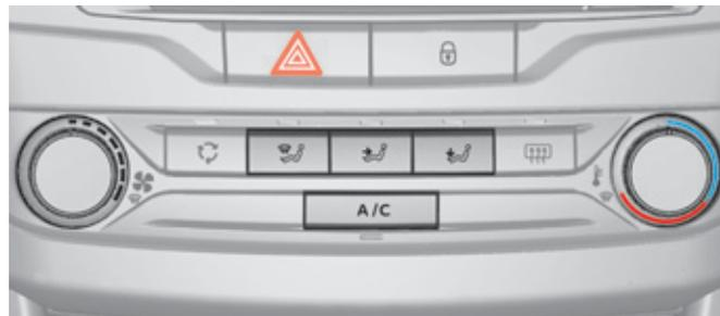
**i** Colocando el mando de caudal de aire en la posición **mínima** (neutralización del sistema), el sistema deja de gestionar el confort térmico. No obstante, se puede seguir percibiendo un ligero flujo de aire debido al desplazamiento del vehículo.
