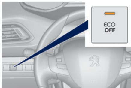
En caso de fallo de funcionamiento del sistema, este testigo se enciende de manera fija.
