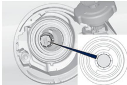
**i** Es posible utilizar una garrafa para llenar el depósito lentamente. Para que el carburante se vierta correctamente, acerque la boquilla de la garrafa sin ponerla en contacto directo con la válvula del sistema anticonfusión.
