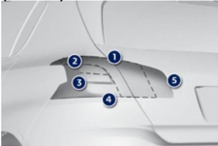
1. Luces de posición (diodos electroluminiscentes-LEDs)
