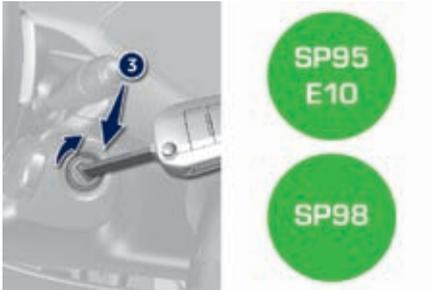
☞ Con un motor gasolina, accione el motor de arranque girando la llave hasta la posición **3** hasta que el motor se ponga en marcha, sin acelerar. Cuando el motor arranque, suelte la llave.
