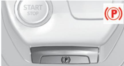
Este sistema permite el tensado del freno de estacionamiento al parar el motor y el destensado del mismo al poner el vehículo en movimiento.
