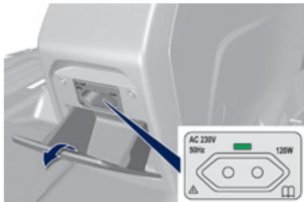
El compartimento trasero incluye una toma de 230 V/50 Hz (potencia máxima: 120 W). Esta toma funciona con el motor en marcha y en el modo STOP del Stop & Start.
