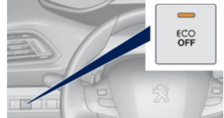
Pulse el mando "ECO OFF" en cualquier momento para neutralizar el sistema. Esto se indica mediante el encendido del piloto del mando, acompañado de un mensaje.
