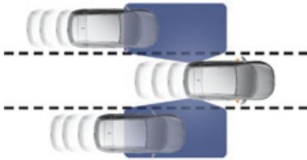
Este sistema de ayuda a la conducción alerta al conductor de la presencia de otro vehículo en las zonas de ángulo muerto del vehículo (zonas ocultas al campo de visión del conductor) ya que estas representan un peligro potencial.
