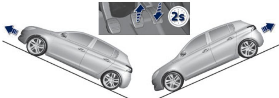
**En pendiente ascendente, con el vehículo parado, este se mantiene un momento después de soltar el pedal del freno:**
