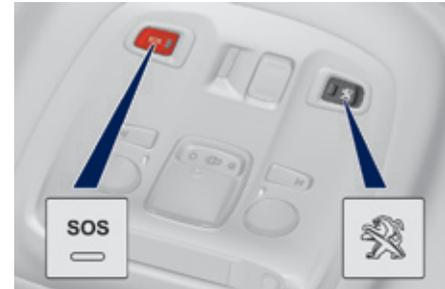
Este dispositivo permite realizar una llamada de urgencia o de asistencia a los servicios de emergencia o a la plataforma PEUGEOT.
