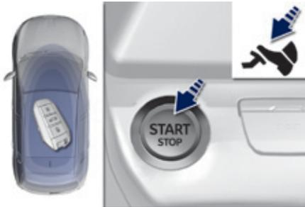
☞ Con la llave electrónica en el interior del vehículo pise el pedal de embrague a fondo y manténgalo pisado hasta que el motor arranque.
