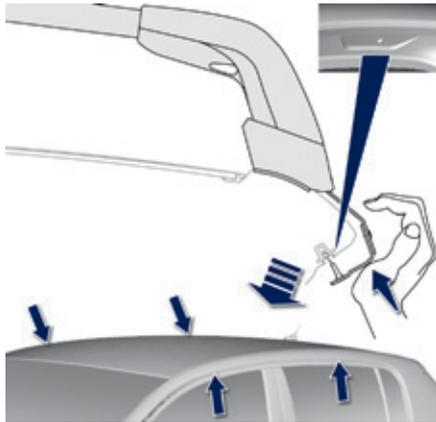
**!** Utilice los accesorios homologados por PEUGEOT y respete las consignas e instrucciones de montaje del fabricante para evitar el deterioro de la carrocería (deformación, arañazos, etc.).
