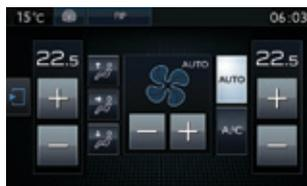
Permite gestionar los diferentes reglajes de temperatura y el caudal de aire.
