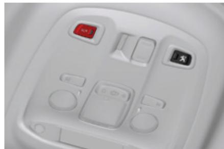
**!** Cuando el calculador de airbag detecta un choque, independientemente de si se despliegan o no los airbags, se envía automáticamente una llamada de urgencia.
