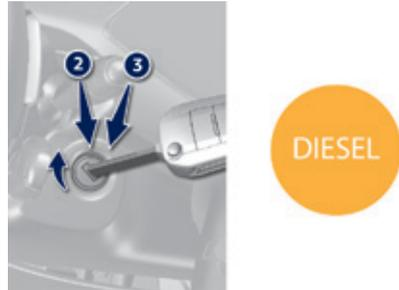
☞ Con un motor diésel, gire la llave hasta la posición **2**, con el contacto puesto para activar el dispositivo de precalentamiento del motor.
