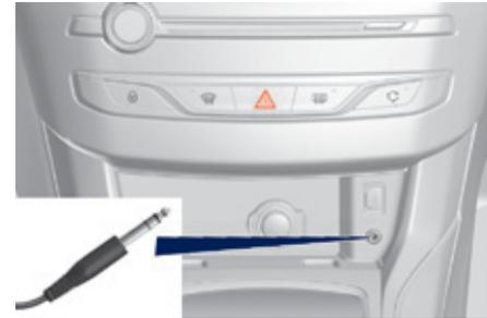
Permite conectar un dispositivo portátil para escuchar archivos de audio a través de los altavoces del vehículo. El manejo de los ficheros se realiza desde el dispositivo portátil.
