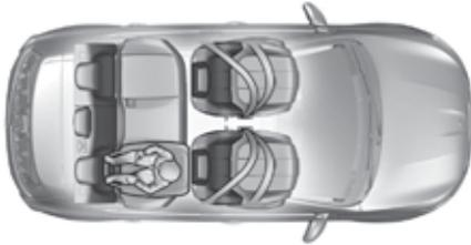
Cuando instale una silla infantil "de espaldas al sentido de la marcha" en una **plaza trasera**, avance el asiento delantero y coloque el respaldo en posición recta de manera que la silla instalada "de espaldas al sentido de la marcha" no toque el asiento delantero del vehículo.
