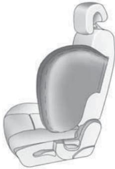
Si el vehículo dispone de airbags de impacto lateral montados en el asiento para el conductor y el acompañante del asiento exterior delantero, los airbags están situados en los laterales de los respaldos más cercanos a la puerta.
