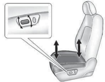
Eleve o baje la parte delantera o trasera de la parte inferior del asiento desplazando el control delantero o trasero hacia arriba o hacia abajo.
