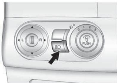
El botón de los lavafaros está situado en el tablero de instrumentos, cerca del control de las luces exteriores. Los faros deben estar encendidos para usar esta función.
