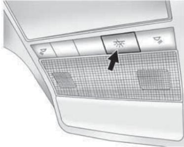
**☼ (Desactivación de las luces de techo):** Pulse para dejar apagadas las luces del techo y otras luces interiores cuando hay abierta alguna puerta. Vuelva a pulsarlo para que vuelva a la posición exterior y para que las luces se enciendan automáticamente cuando se abra alguna puerta.
