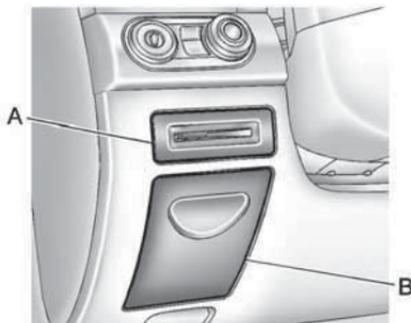
El tablero de instrumentos incluye un portatarjetas (A) y un compartimento portaobjetos (B).
