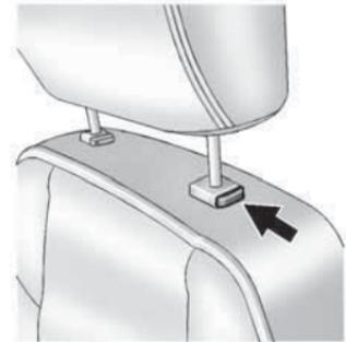
Es posible ajustar la altura del apoyacabezas. Tire hacia arriba del apoyacabezas para elevarlo. Intente mover el apoyacabezas para asegurarse de que no se pueda mover.
