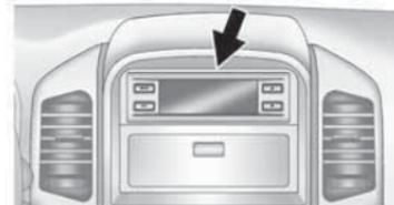
El vehículo puede incorporar un Centro de información del conductor. Proporciona al conductor información, como: temperatura exterior, distancia de conducción para el combustible restante, velocidad media, tiempo de
