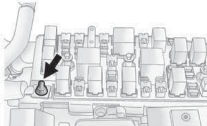
Su vehículo dispone de un terminal positivo (+) remoto. El terminal está situado en el compartimento del motor del lado del conductor, en la caja de fusibles situada debajo del capó. Si desea más información, consulte *Vista general del compartimento motor en la página 9-5*.
