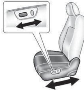
Si lo hay, desplace el asiento hacia delante o hacia atrás deslizando el control horizontal hacia delante o hacia atrás.
