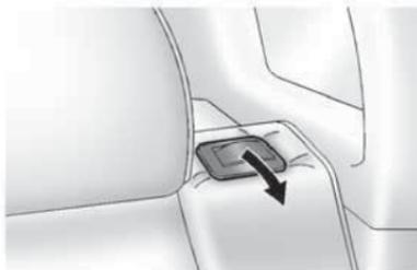
3. Levante la palanca situada en la parte superior del respaldo del asiento para desbloquearlo. A continuación, pliegue el respaldo hacia delante.
