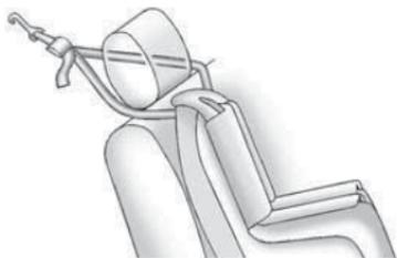
Si el asiento exterior trasero que usa dispone de un apoyacabezas regulable y utiliza una correa doble, enrolle la correa alrededor del apoyacabezas.
