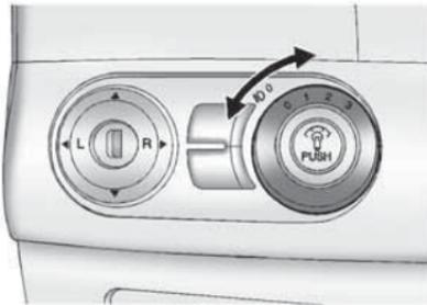
En vehículos con nivelación de faros manual, el control del alcance de los faros manual está junto a la columna de dirección. Esta función le permite ajustar el alcance de los faros según la carga del vehículo.
