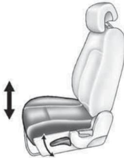
Si lo hay, mueva repetidamente la palanca hacia arriba o hacia abajo para elevar o bajar el asiento del conductor.
