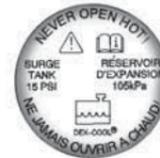
1. Quite el casquillo de presión de la cámara de compensación de refrigerante cuando el sistema de refrigeración, el propio tapón y el tubo flexible del radiador superior se hayan enfriado.
