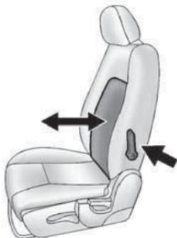
Si lo hay, mueva repetidamente la palanca hacia delante o hacia atrás para aumentar o disminuir el soporte lumbar.
