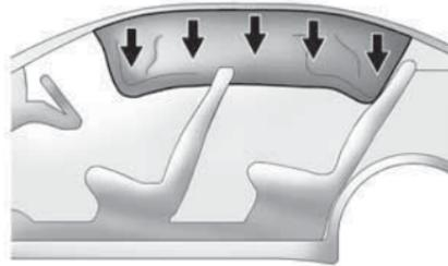
Si el vehículo dispone de airbags de cortina en el riel del techo para el acompañante del asiento exterior delantero y para los ocupantes de los asientos exteriores de la segunda fila, los airbags de cortina estarán situados en el techo, encima de las ventanas.
