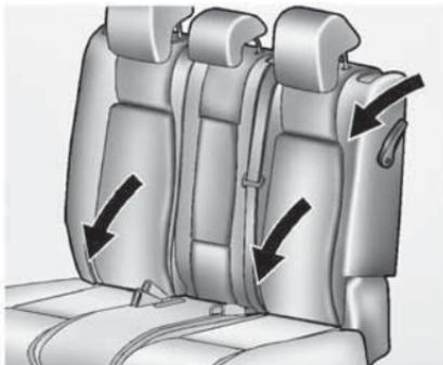
3. Tire de la palanca situada en la parte exterior del respaldo hacia delante. A continuación, empuje ligeramente el respaldo hacia delante. El respaldo se pliega y el asiento se abate automáticamente hacia delante.
