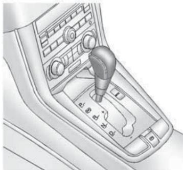
La palanca de cambios tiene varias posiciones distintas para el cambio automático.
