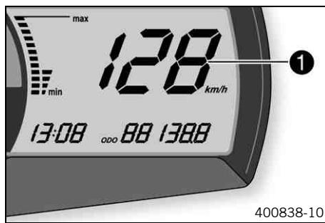
La velocidad ① se indica en kilómetros por hora **km/h** o en millas por hora **mph**.
