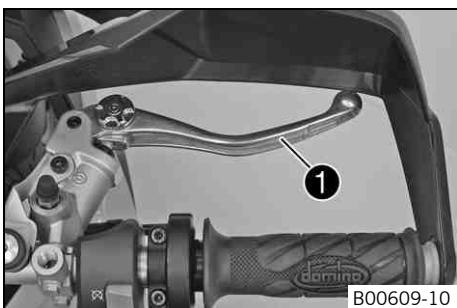
La maneta del freno de mano 1 se encuentra en el lado derecho del manillar. La maneta del freno de mano acciona el freno de la rueda delantera.
