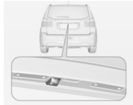
La cámara está montada debajo de la moldura del portón trasero y tiene un ángulo de visión de 130°.
