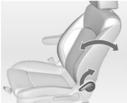
Tire de la palanca, ajuste la inclinación y suelte la palanca. Deje que el asiento enclave audiblemente. No se apoye en el respaldo mientras lo ajusta.
