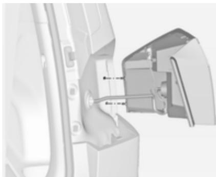
3. Desmonte el grupo óptico trasero. Asegúrese de que el conducto de cables permanezca en su posición.
