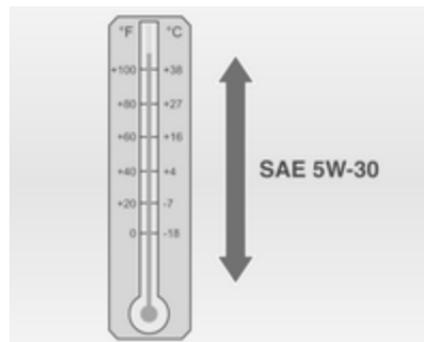
SAE 5W-30 es el mejor grado de viscosidad para el vehículo. No utilice aceites de grados de viscosidad como SAE 10W-30, 10W-40 o 20W-50.
