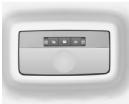
Al subir o bajar del vehículo, se encienden automáticamente las luces de cortesía y se apagan poco después. Se encienden brevemente aunque la llave se saque de la cerradura del encendido.
