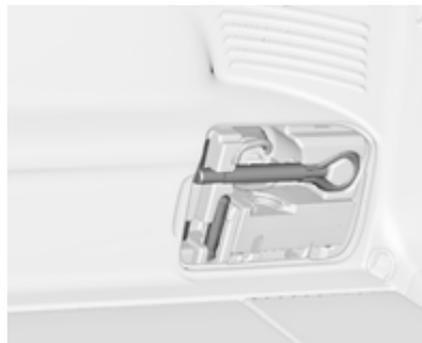
Las herramientas del vehículo están en el lado derecho del compartimento de carga, detrás de una tapa, junto con el juego de reparación de neumáticos.
