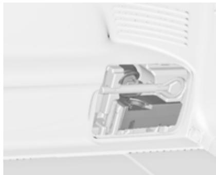
El juego de reparación de neumáticos está en un compartimento debajo de la cubierta del piso en el compartimento de carga. Abra el compartimento portaobjetos ⇨ 284
