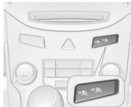
En caso de colisión, el sistema del airbag del acompañante se inflará siempre que el testigo de control
