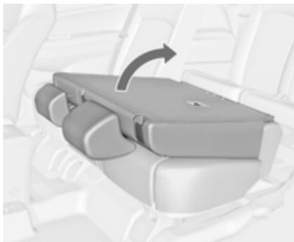
Coloque el respaldo en posición vertical, hasta que se enclave.
