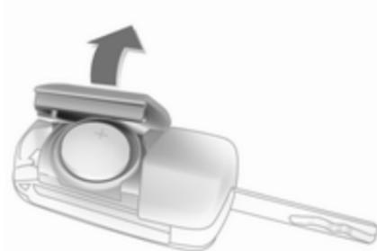
Despliegue la llave y abra la unidad. Sustituya la pila (tipo CR 2032), prestando atención a la posición de montaje. Cierre la unidad y sincronice el mando a distancia.
