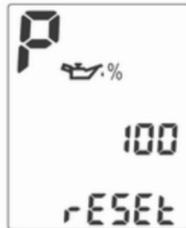
La vida útil restante del aceite se indica en el centro de información del conductor mediante el testigo de control , seguido de un valor porcentual. Para que aparezca se tiene que conectar el encendido sin poner el motor en marcha.
