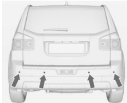
El sistema se compone de cuatro sensores de aparcamiento por ultrasonidos montados en el parachoques trasero.
