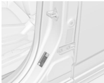
Presión de los neumáticos ↪ 328 y en la etiqueta colocada en el marco de la puerta delantera izquierda.
