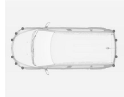
El sistema de asistente de aparcamiento avanzado hace maniobrar al conductor en el hueco de aparcamiento mediante instrucciones dadas en el centro de información del conductor y las señales acústicas.
