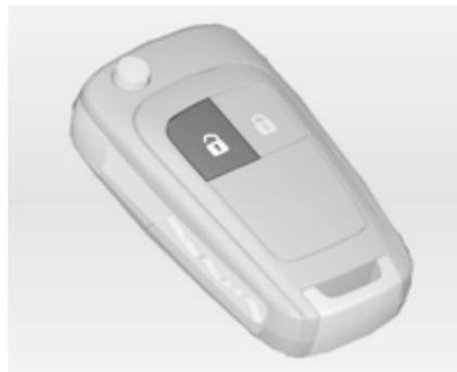
Pulse el botón
