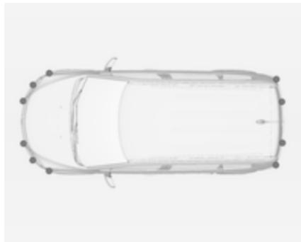
El sistema consiste en seis sensores de aparcamiento ultrasónico en cada uno de los parachoques delantero y trasero.
