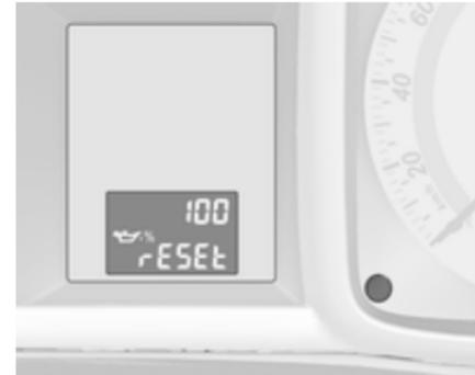
Pulse el botón de ajuste durante unos 5 segundos hasta que se haya mostrado la vida útil restante del aceite del motor. Suelte el botón de ajuste y púlselo de nuevo unos segundos para reiniciar el sistema de control de vida útil del aceite del motor.
