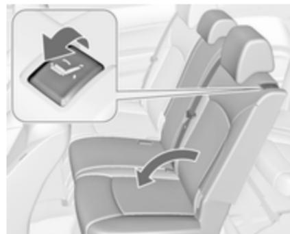
Levante la palanca de desbloqueo completamente y luego abata el respaldo del asiento.
