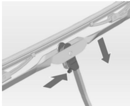
Levante el brazo del limpiaparabrisas, pulse la palanca de desbloqueo y deslice la escobilla hacia abajo para desenclavarla y desmóntela.
