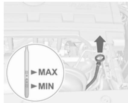
Rellene aceite del motor cuando el nivel haya descendido hasta la marca **MIN**.
