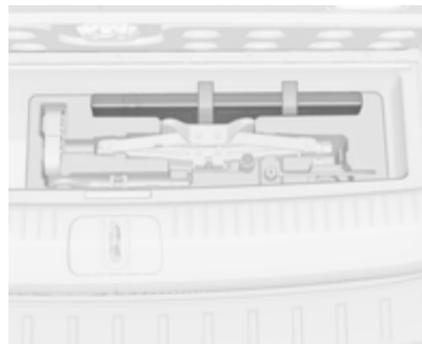
Guarde el triángulo de advertencia en el compartimento portaobjetos que hay debajo de la cubierta del piso en el compartimento de carga.
