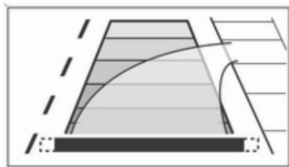
La trayectoria del vehículo se muestra en función del ángulo de la dirección.
