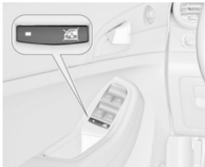
Pulse el interruptor
