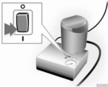
10. Ponga el interruptor basculante del compresor en I. El neumático se llenará con el sellador.
