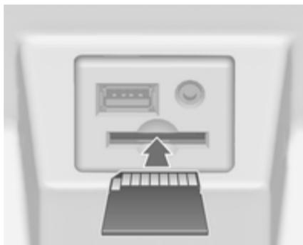
Empuje con cuidado la tarjeta SD con el borde cortado hacia la izquierda (vea la imagen superior) en la ranura, hasta que quede encajada.
