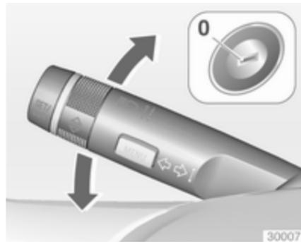
Cuando el vehículo está aparcado, se pueden activar las luces de posición delantera y trasera de un lado del vehículo:
