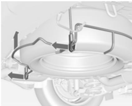
7. Levante el soporte de la rueda de repuesto y desenganche las dos fijaciones.
