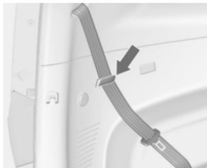
Cuando no esté en uso, guíe el cinturón de seguridad por la sujeción correspondiente.
