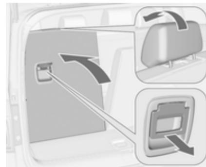
Desde el compartimento de carga, tire de la manilla y el reposacabezas se abatirá automáticamente. Abata el respaldo hasta que el asiento se oculte en el piso del vehículo.
