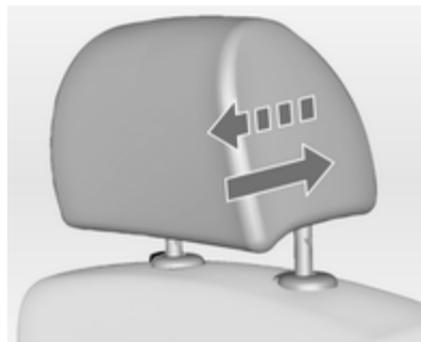
Tire del reposacabezas hacia delante, se enclava en varias posiciones.
