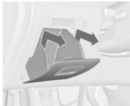
3. Levante el compartimento portaobjetos hasta que se desenclave audiblemente y desmóntelo en la dirección de las flechas.
