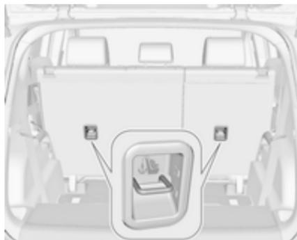
Fije los sistemas de retención infantil con anclaje superior a las argollas de la segunda fila de asientos. La correa debe pasar entre las dos varillas guía del reposacabezas.
