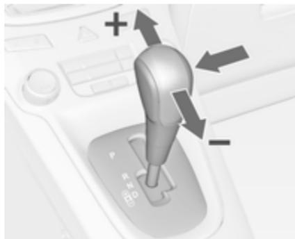
Mueva la palanca selectora desde la posición **D** hacia la izquierda y luego hacia adelante o hacia atrás.
