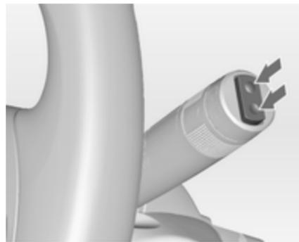
Pulse el interruptor basculante para activar el limaluneta:
