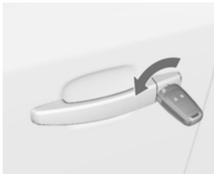
Desbloquee manualmente la puerta del conductor girando la llave en la cerradura. Conecte el encendido y pulse el botón del cierre centralizado
