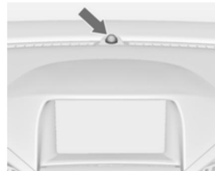
El LED de estado está integrado en el sensor situado en la parte superior del tablero de instrumentos.
