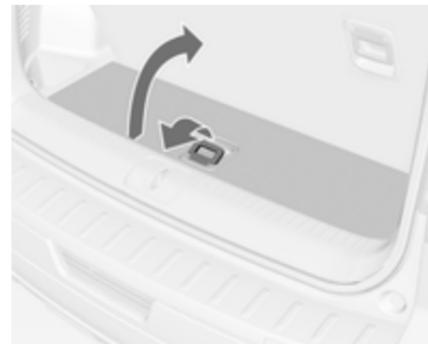
Tire de la manilla de la cubierta del piso. Levante la cubierta del piso.
