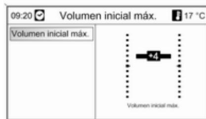
Pulse el botón **CONFIG** para abrir el menú de ajustes del sistema.
