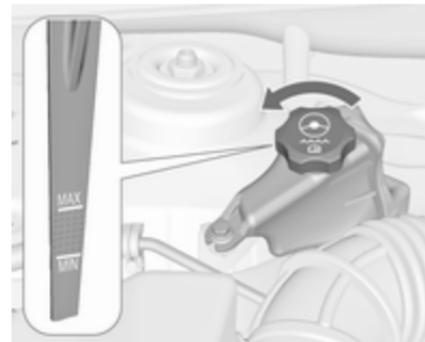
Abra y retire el tapón. Seque la varilla de medición con un paño y gire el tapón en el depósito. Abra de nuevo el tapón y verifique el nivel de líquido de la dirección asistida.
