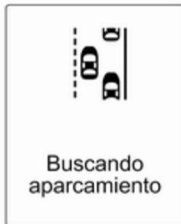
Cuando el vehículo pasa una hilera de coches y el sistema está activado, el sistema de asistente de aparcamiento avanzado comienza a buscar un hueco de aparcamiento adecuado. Cuando detecta un hueco de aparcamiento adecuado, se produce una confirmación visual en el centro de información del conductor y una señal acústica.
