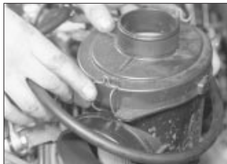
28.5a Prise down the toggle clips . . .
