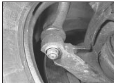
13.2a Loosen the balljoint nut . . .
