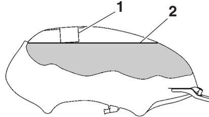
1. Tubo de llenado del depósito de gasolina
