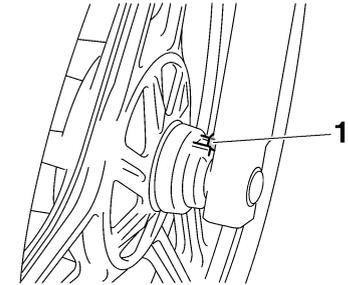
1. Sujeción de los engranajes del velocímetro
