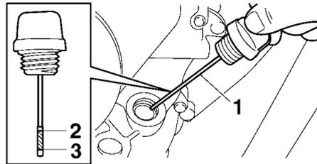
1. Varilla de medición del aceite del motor
