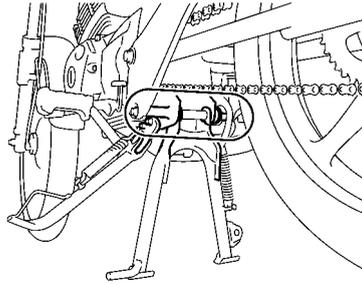
Antes de cada utilización debe comprobar el funcionamiento de los caballetes central y lateral y engrasar los pivotes y las superficies de contacto metal-metal según sea necesario.
