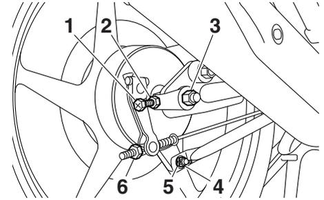
1. Perno de ajuste del juego de la cadena de transmisión
