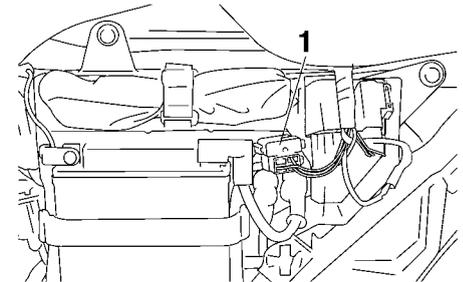
1. Acoplador del relé de arranque
