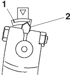
1. Marca de límite de desgaste de la zapata de freno
