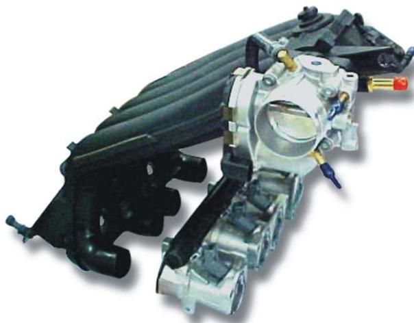
La parte de aluminio aloja los inyectores, el tubo distribuidor de combustible y el regulador de presión.
