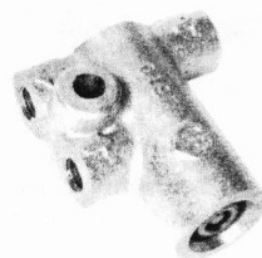
Regulador de presión: actuando sobre las ruedas posteriores
