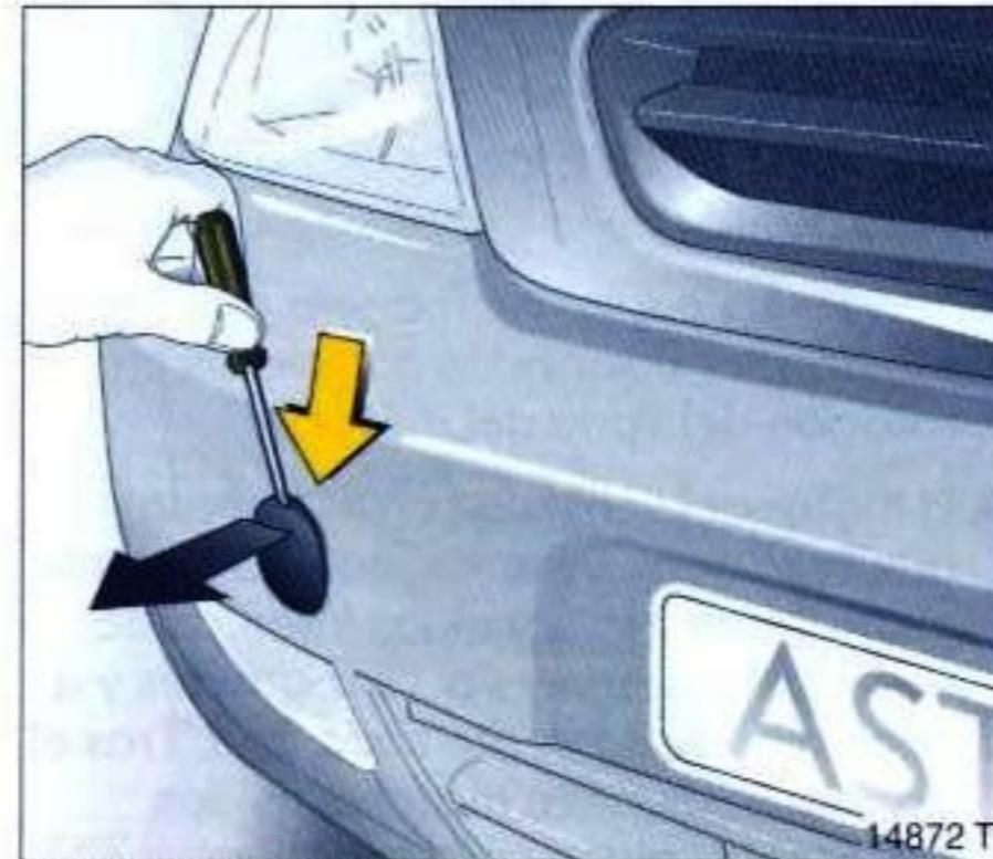
Coupé, Cabrio: Abrir la tapa para el alojamiento de la argolla para remolcar delantera derecha: Desenclavar la tapa superior con un destornillador y retirarla hacia abajo.
