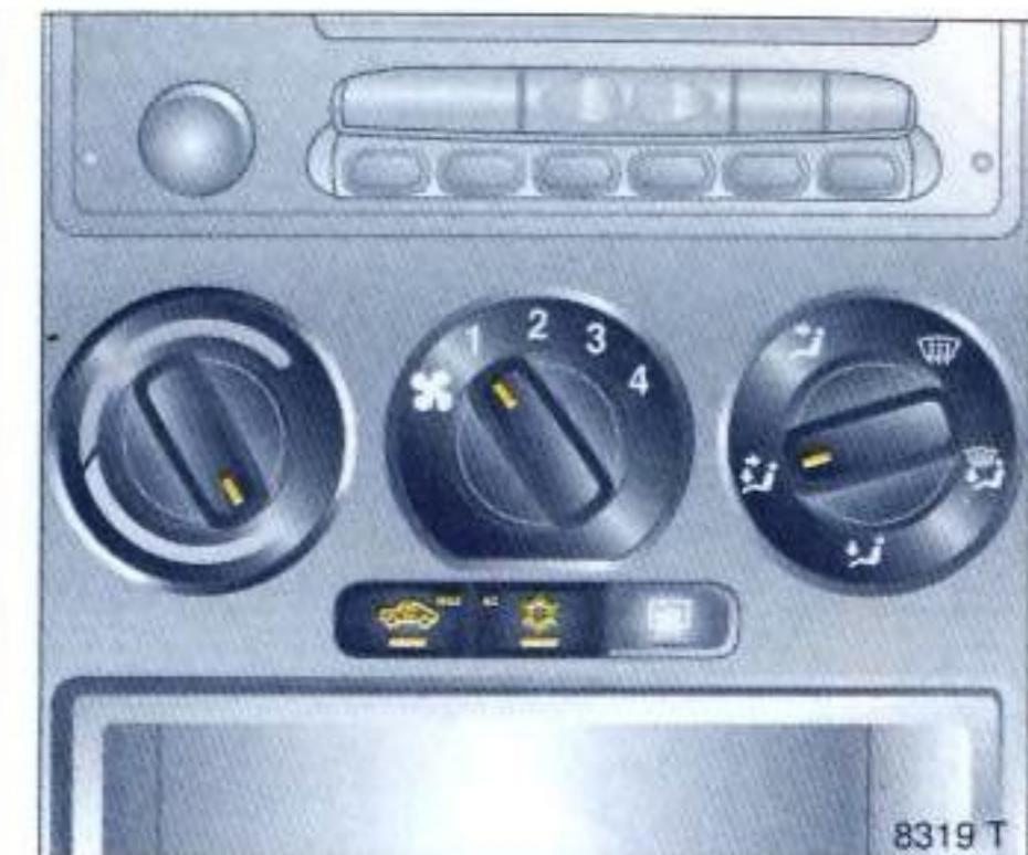
El funcionamiento con refrigeración (compresor de refrigeración) sólo es posible estando el motor en marcha.
