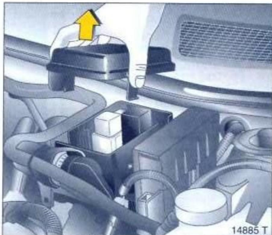
**Fusibles en el compartimento del motor**
