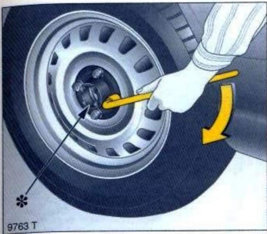
7. Enroscar los tornillos de la rueda y apretarlos ligeramente (en caso de embellecedores con seguro \*, colocar previamente el adaptador y fijarlo con los tornillos de las rueda), insertando la llave de vaso para tornillos de rueda hasta el tope.
