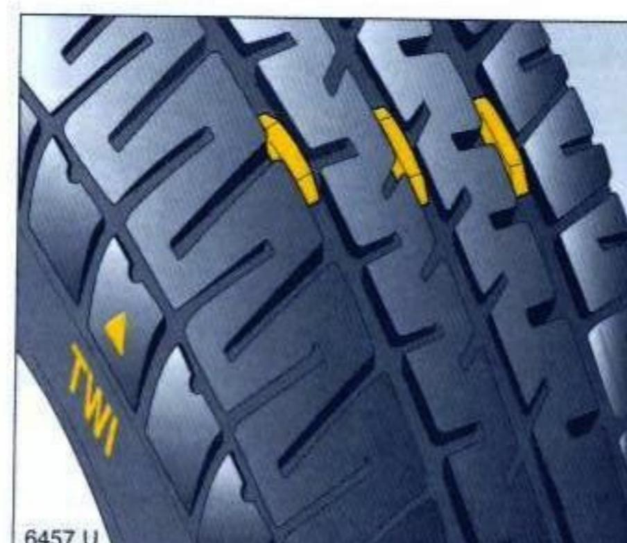
La profundidad mínima permisible por la ley (1,6 mm) se ha alcanzado cuando el dibujo muestra un indicador de desgaste (TWI<sup>1)</sup>). Diversos indicadores de desgaste se encuentran distribuidos a igual distancia en el fondo del dibujo. Su ubicación se indica mediante marcas en el lado del neumático.
