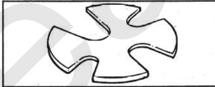
KM-307-B Placa de presión para expulsar a presión el cuerpo sincronizador 1ª y 2ª marcha, así como piñón 2ª marcha. Cambio mecánico F 13. Expulsar el piñón (impulsor) del árbol primario.
