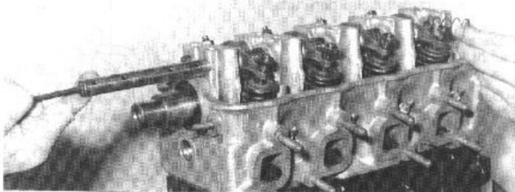
Desmontaje de un eje de balancines.
