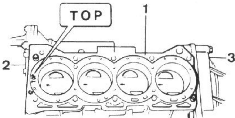
Montaje de la junta de culata
