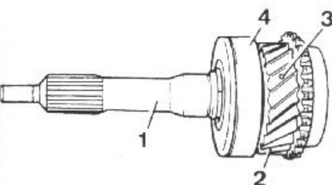
Ensamblado del eje primario.
