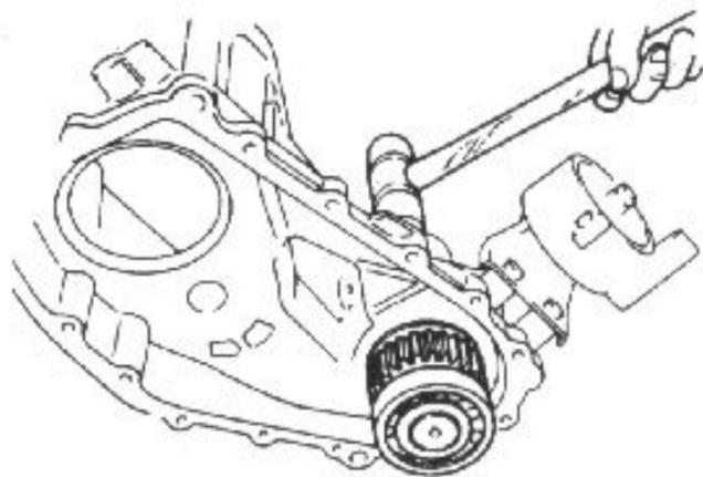
Desmontaje del eje de salida delantero.
