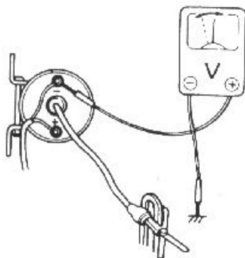
Conexión del voltímetro para control del captador.
