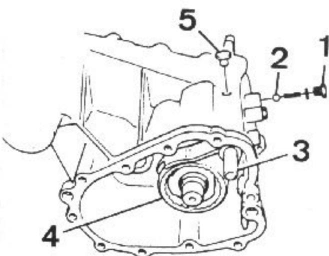
Desmontaje del eje de cambio de gama.
