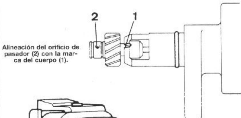
Alineación del orificio de pasador (2) con la marca del cuerpo (1).
