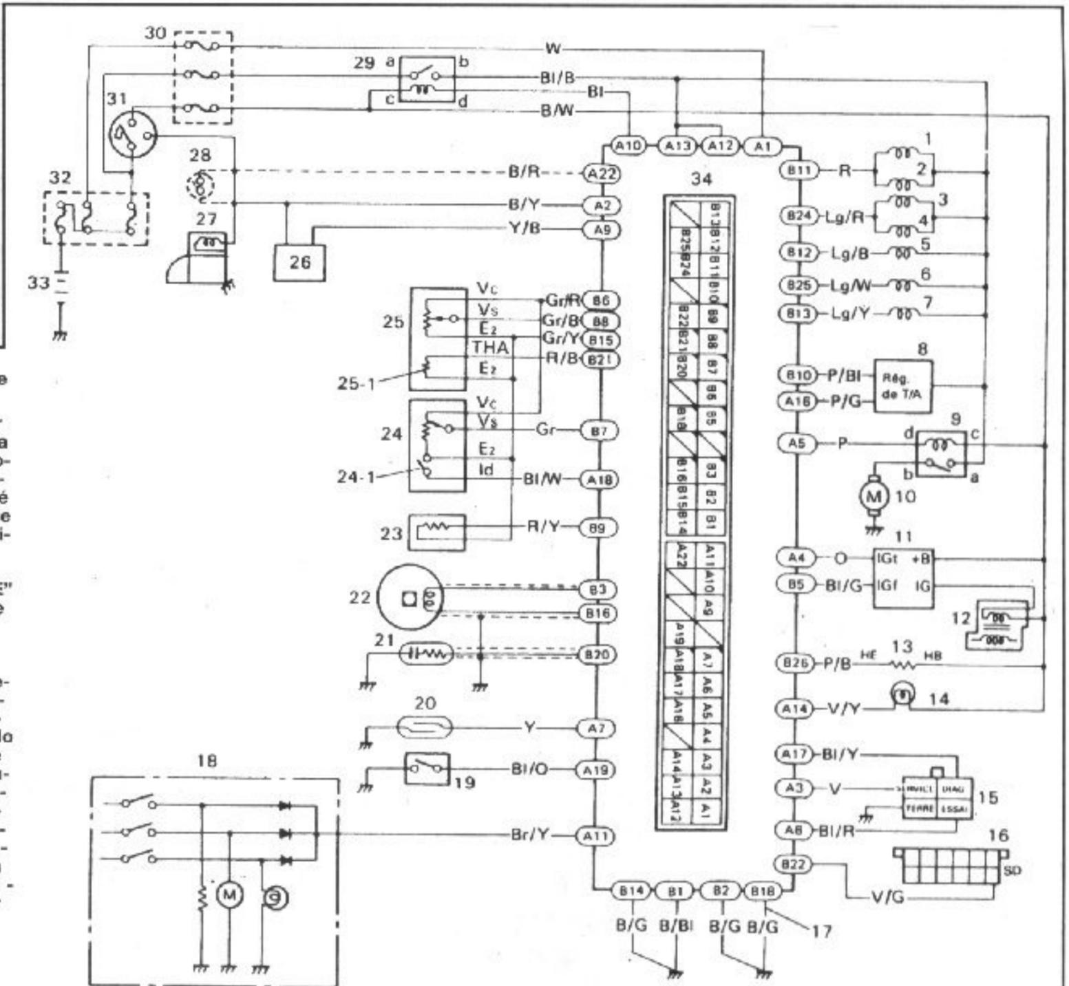
**Esquema de cableado del sistema de inyección multipunto**
