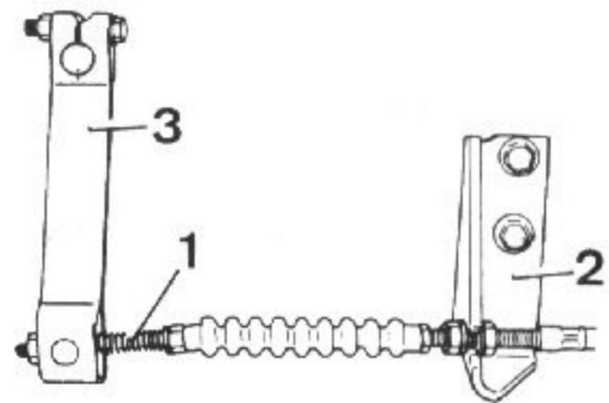
Desmontaje del cable de embrague
