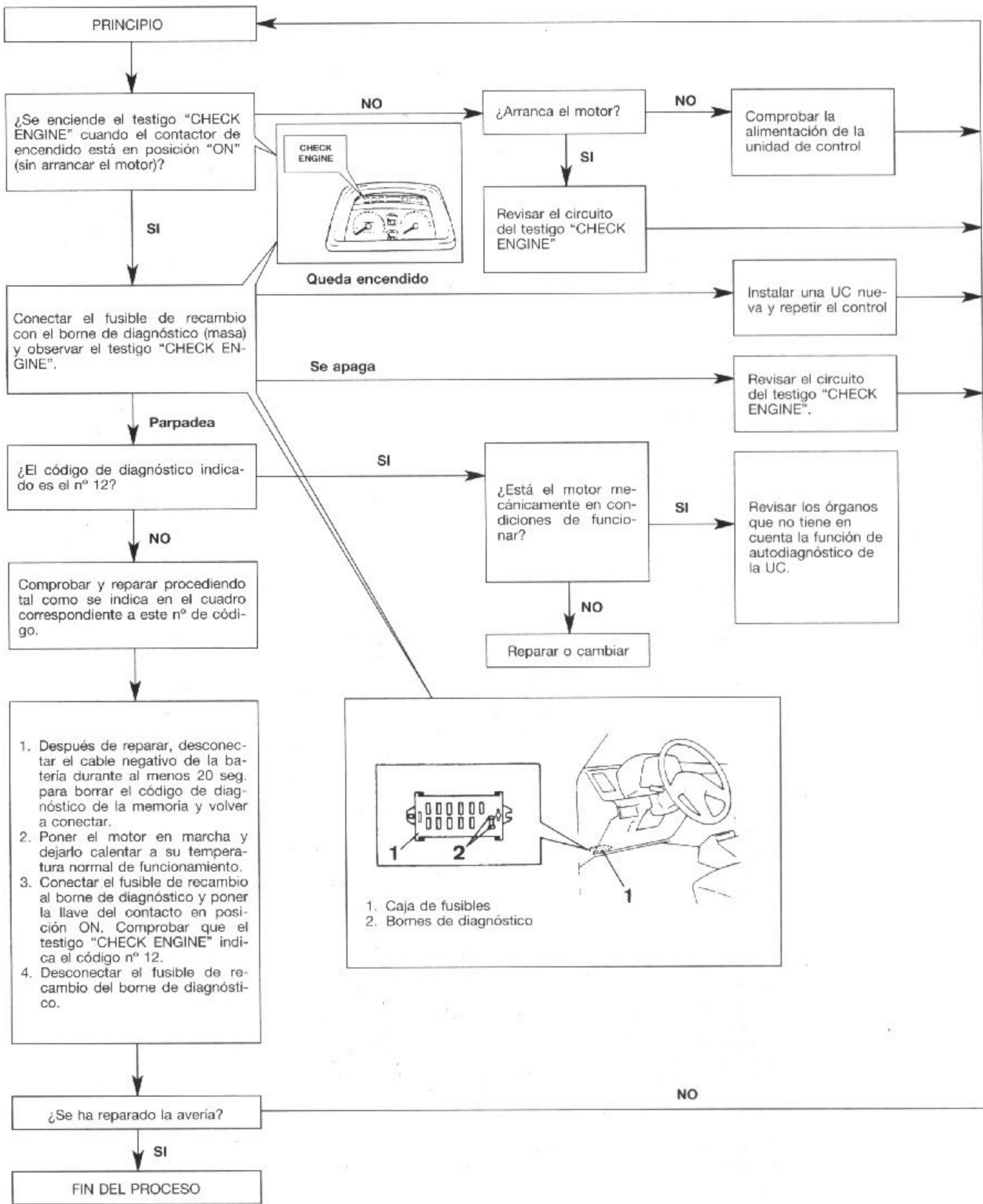
Conectar el fusible de recambio con el borne de diagnóstico (masa) y observar el testigo "CHECK ENGINE".
