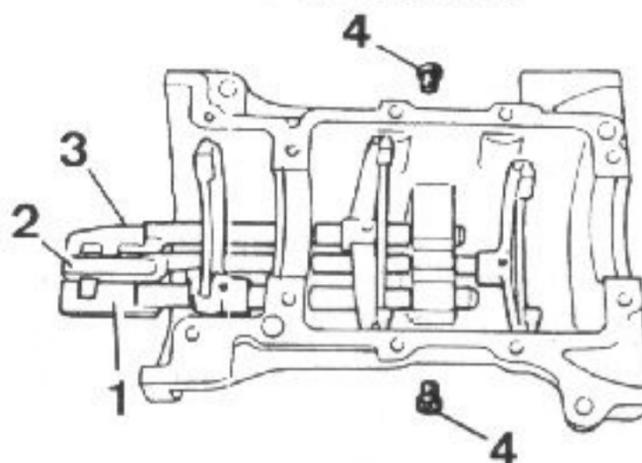
Ensamblado de los ejes de horquillas.
