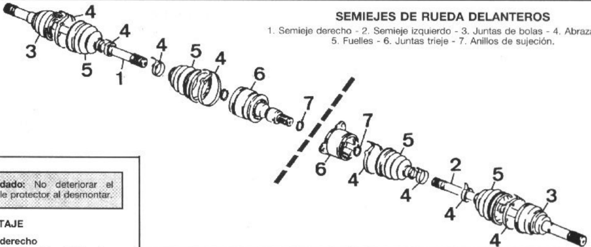
**Cuidado:** No deteriorar el fuelle protector al desmontar.
