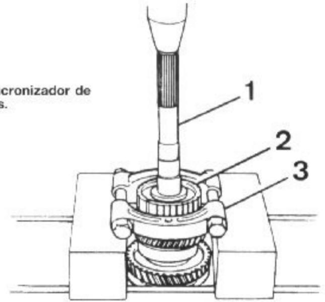
Desmontaje del rodamiento trasero de eje secundario.
