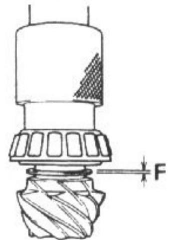
Montaje con prensa del rodamiento de piñón de ataque.
