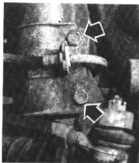
Fijación inferior de un amortiguador.
