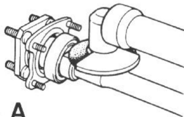
Desmontaje del casquillo de retención del rodamiento del cubo.
