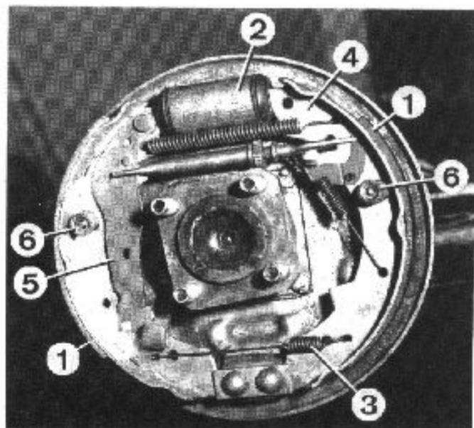
Montaje de un freno trasero.
