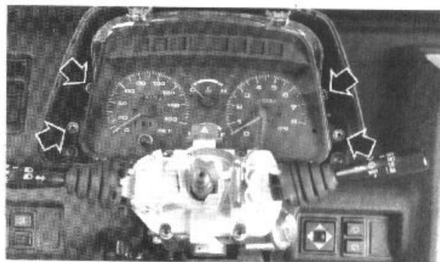
Tornillos de fijación del cuadro de instrumentos.
