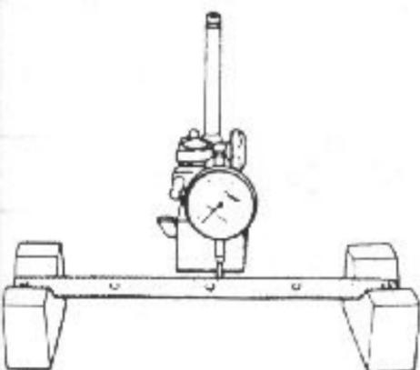
Control del salto del eje de balancines.
