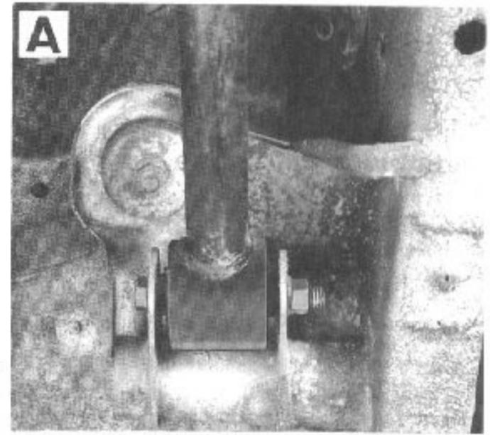
Desmontaje de un tirante longitudinal
