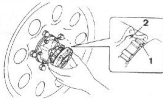
Ensamblado de un cubo desembragable manual
