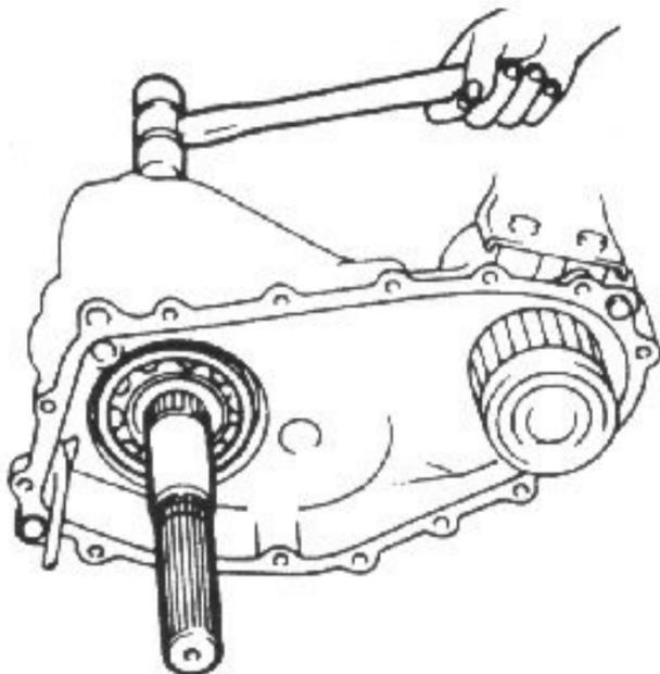
Desmontaje del eje de salida trasero.
