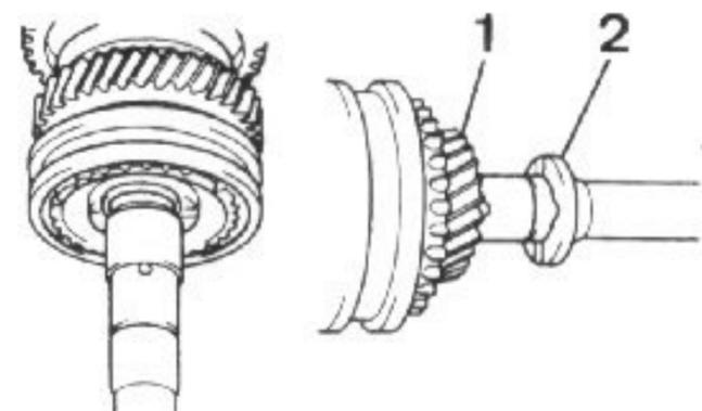
Ensamblado del eje secundario.
