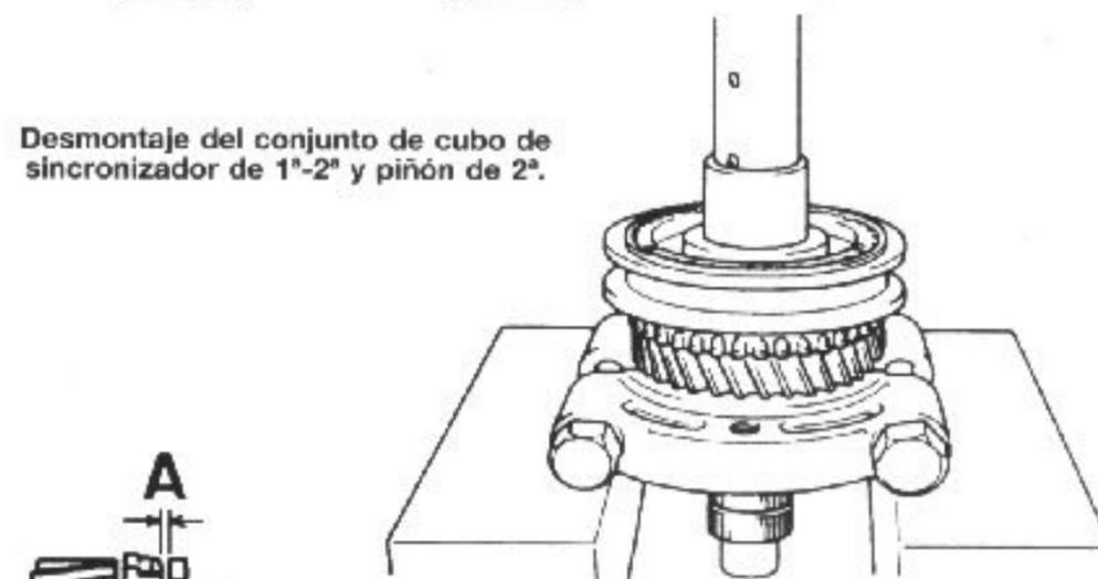
Desmontaje del conjunto de cubo de sincronizador de 1ª-2ª y piñón de 2ª.
