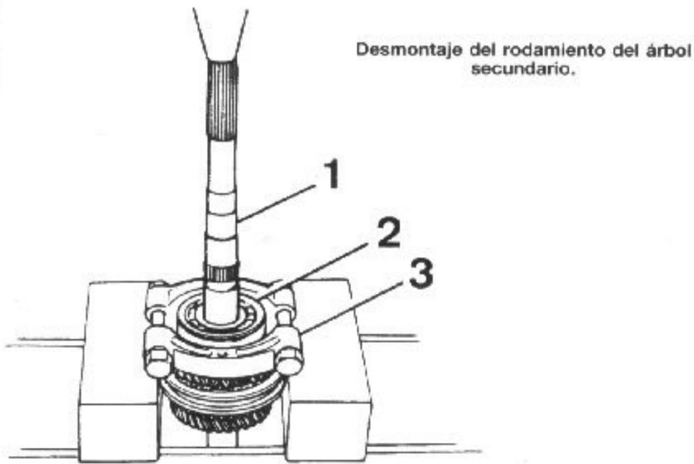
Desmontaje del rodamiento del árbol secundario.
