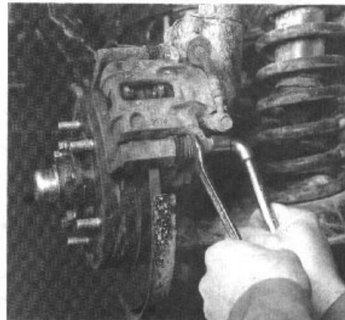
Desmontaje del tornillo de guía inferior.
