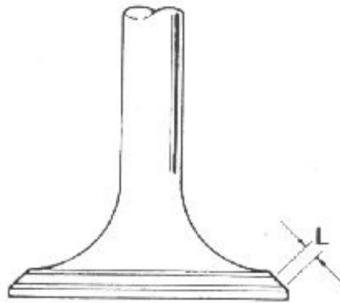
Control del ancho de asiento de una válvula
