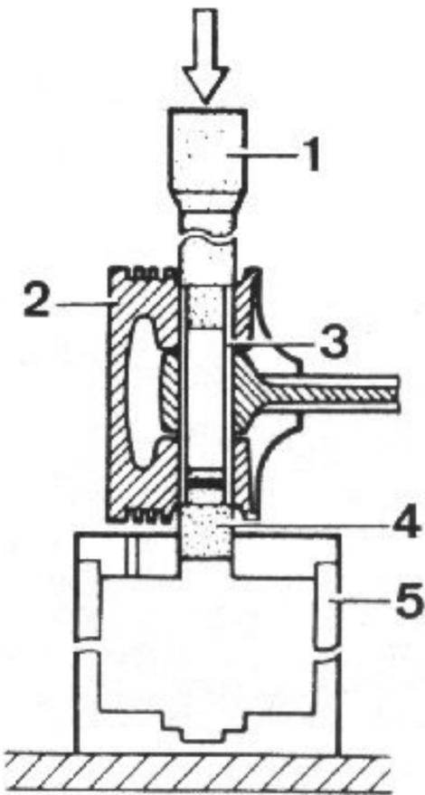
Desmontaje con prensa de un bulón en un motor de 8 válvulas.
