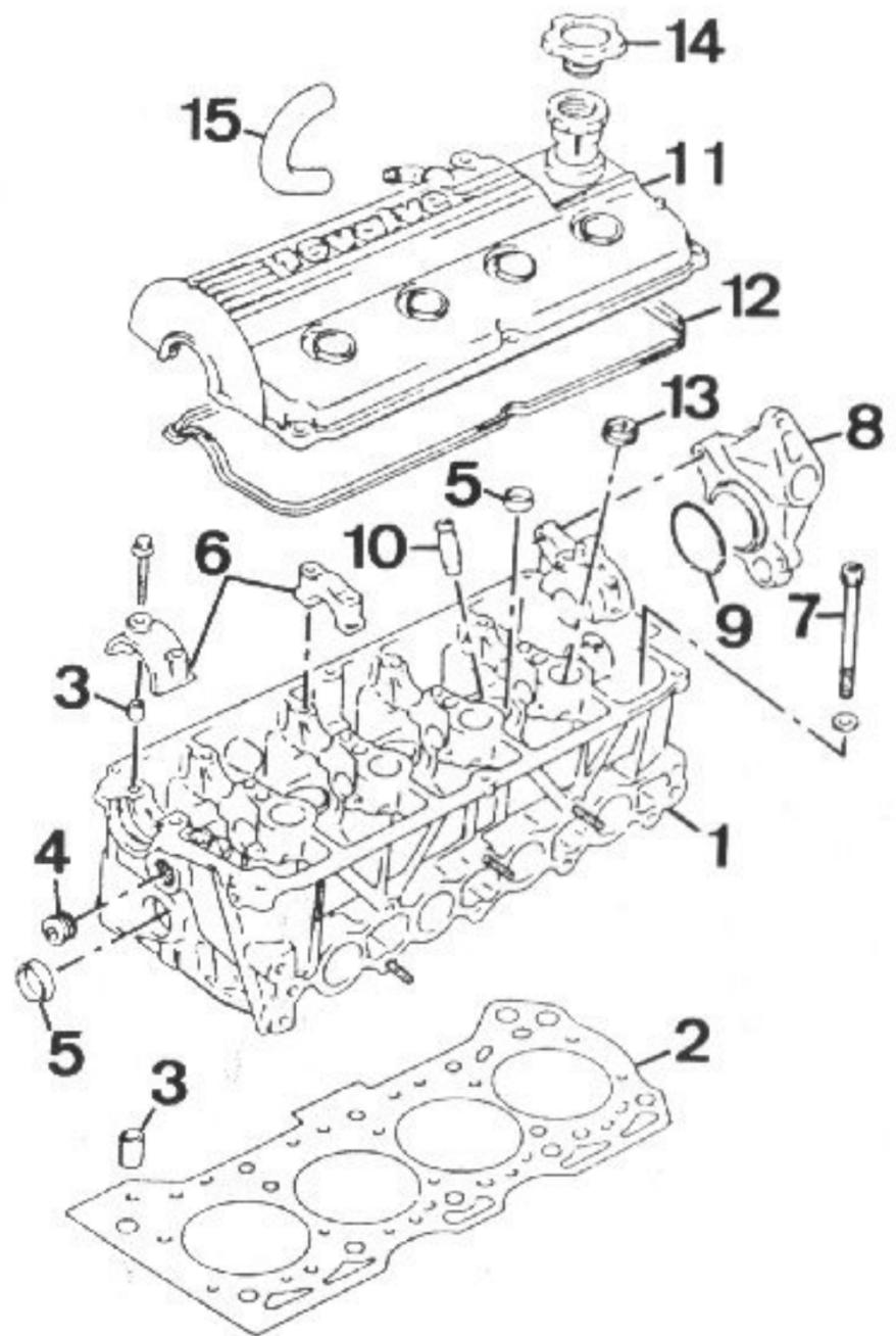
Desmontaje del eje de balancines
