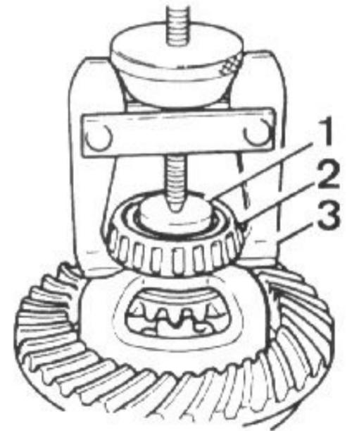
Desmontaje del rodamiento de diferencial.
