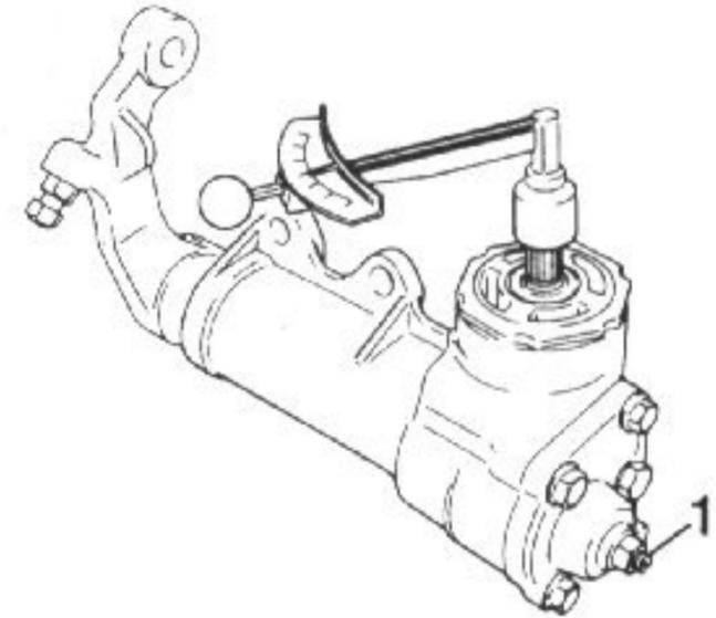
Control del par de rotación del eje de entrada.
