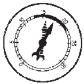
ASENTAMIENTO DE VALVU- LAS POBRE EN RALENTI
