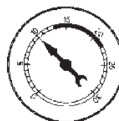
DISTRIBUCION DE VALVULAS ATRA- SADA, PERDIDA DE VACIO EN RALENTI
