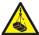
Peligro de cargas suspendidas
