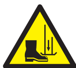
Peligro de aplastamiento - pies
