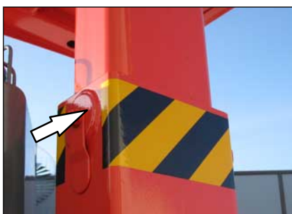
19 Placa de protección sobre los tubos del techo
