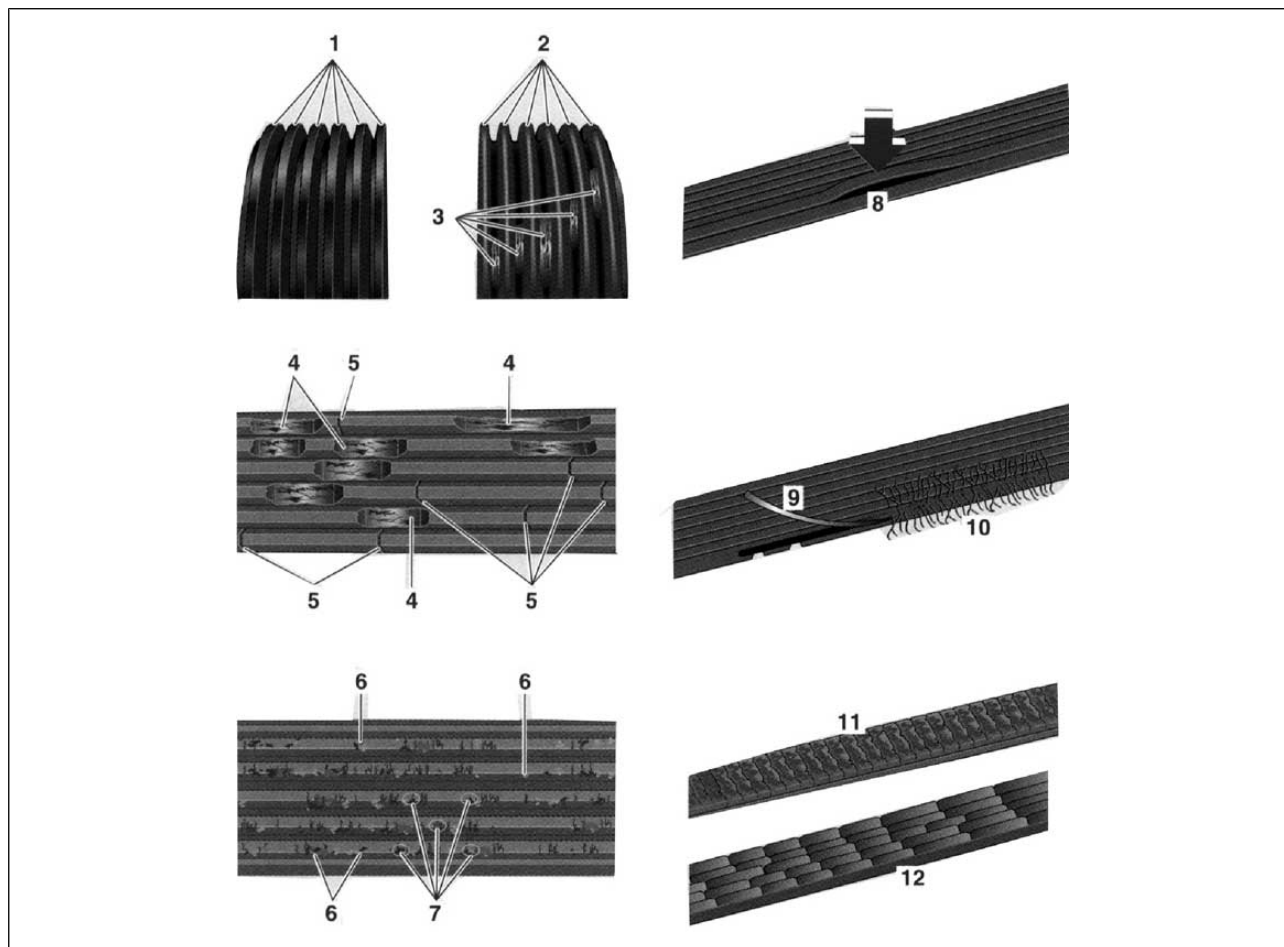
Figura: Patrones de avería o daño
