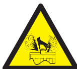
Peligro de salpicaduras de refri- gerante caliente
