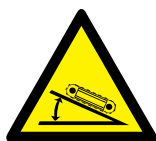
Peligro de caída hacia delante/hacia atrás
