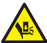
Peligro de aplastamiento - manos
