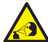
Peligro de inyección a alta presión
