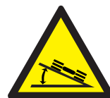
Peligro de caída lateral
