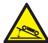
Peligro de caída hacia delante/hacia atrás
