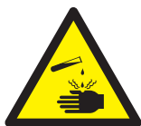
Peligro de quemadura química
