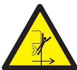
Peligro de vuelco.
