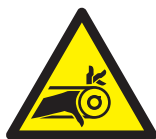
Peligro de aprisionamiento
