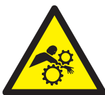
Peligro de aprisionamiento
