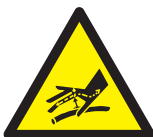
Peligro de inyección en la piel
