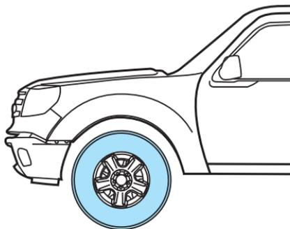
Si tiene que conducir sobre bordes o cordones bajos de veredas, hágalo a baja velocidad y si es posible, crúcelos en ángulo recto. Se debe evitar conducir sobre obstáculos altos y con bordes agudos. Al estacionar el vehículo, no permita que los neumáticos rocen lateralmente los bordes.
