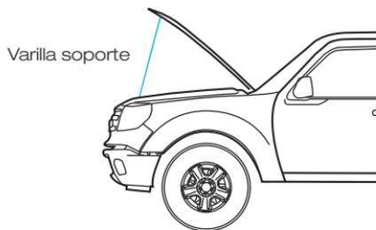
Para cerrarlo: volver a colocar la varilla soporte en su presilla de retención, bajar el capó y dejarlo caer de una altura de 20 a 30 centímetros.
