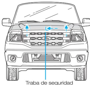
3. Levantar totalmente la tapa del capó y apoyarlo en su varilla soporte.
