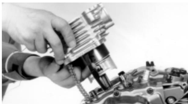
**NOTA:** Instalar el cilindro mientras comprima los anillos del pistón con las manos.
