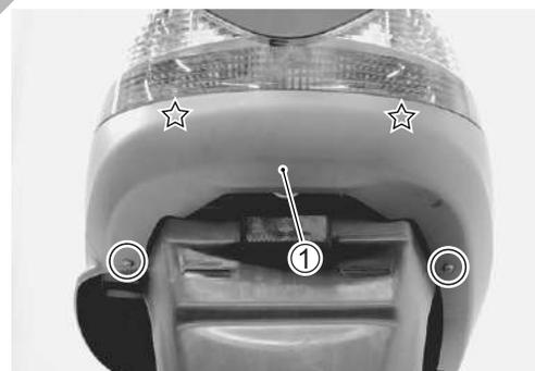
**CUBIERTA DEL BASTIDOR****EXTRACCIÓN**
