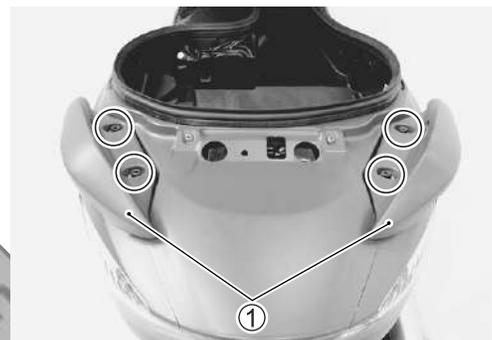
**CUBIERTA INFERIOR DEL BASTIDOR****EXTRACCIÓN**
