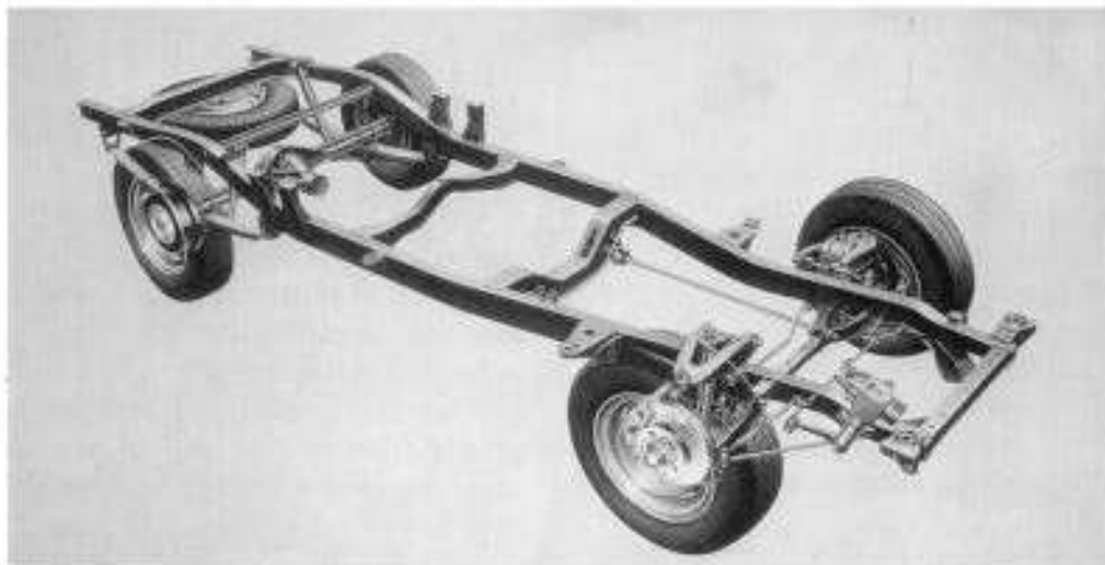
Ejemplo de bastidor de largueros, con suspensión posterior de ballesas e independiente en el avante con barras de torsión.
