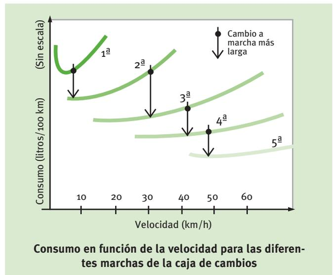
A partir de las 1.000 o 1.500 rpm, para una potencia dada, el consumo en litros/100 km aumenta al aumentar las revoluciones.
