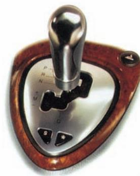
Las cajas de cambios automáticas eligen la relación de marcha adecuada sin intervención del conductor, en función de las revoluciones del motor y de la posición del acelerador.
