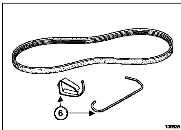
Útil para colocar la correa del compresor del acondicionador de aire (6).
