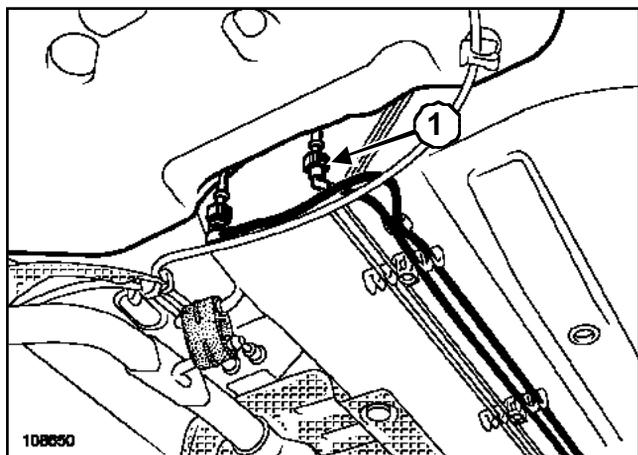
Desconectar el racor (1) del tubo de alimentación de gasolina.
