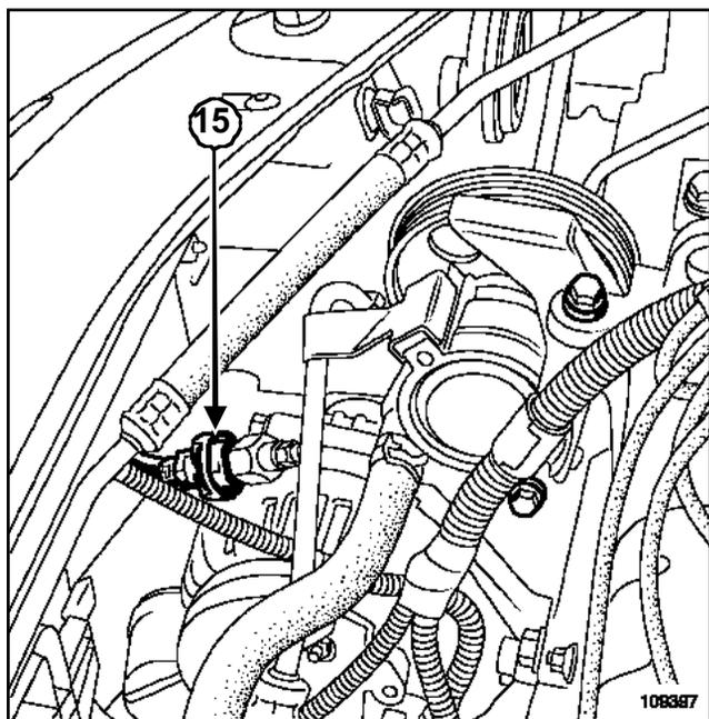
Desconectar el conector (15) del presostato de dirección asistida.
