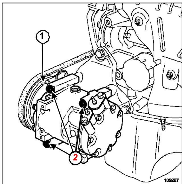
Desconectar el conector (1) del compresor del acondicionador de aire.
