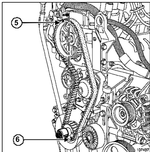
Enroscar el tornillo de la polea de accesorios del cigüeñal con un separador.
