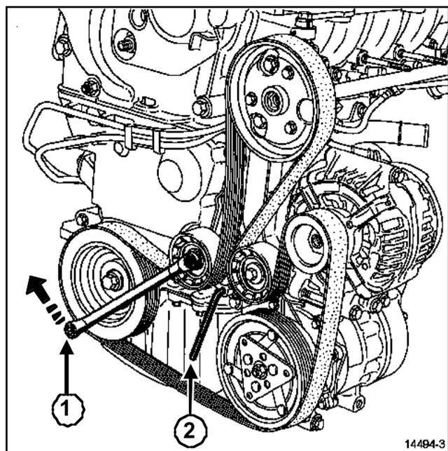
Pivotar el rodillo tensor en el sentido de las agujas del reloj, mediante una llave (1), para destensar la correa.
