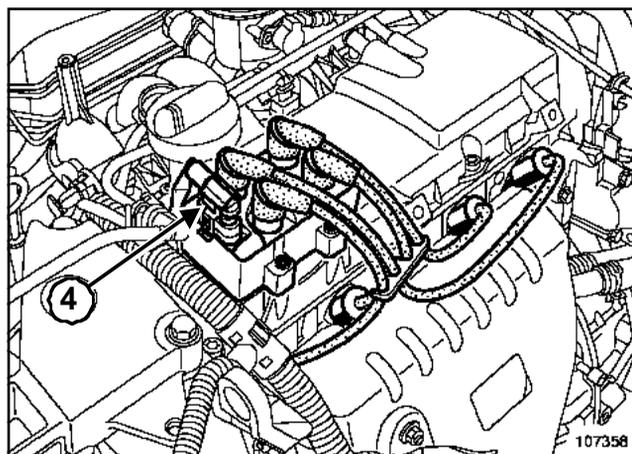
Desconectar el conector (4) de la bobina de encendido.
