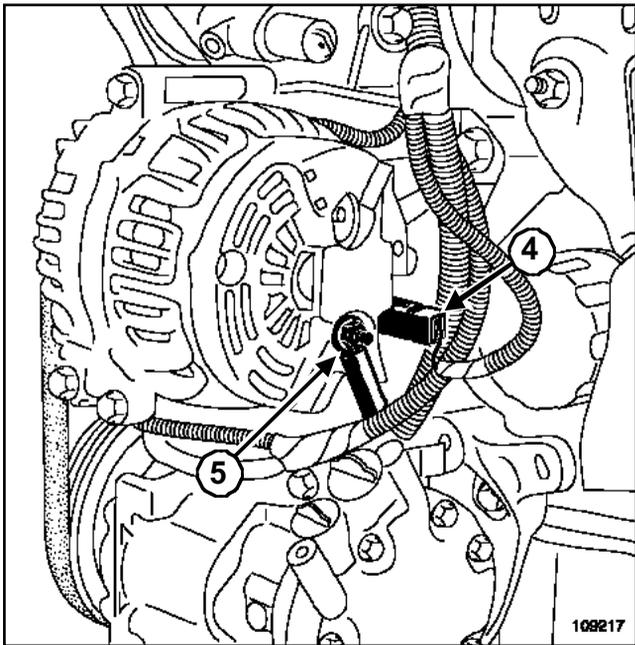
Extraer el cable eléctrico (5) del alternador.
