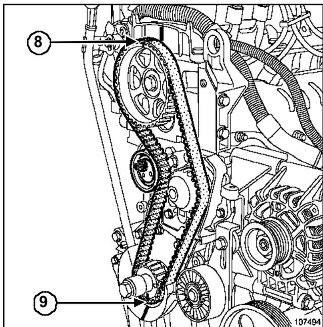
Colocar la correa de distribución alineando las marcas de la correa con las de los piñones del árbol de levas (8) y del cigüeñal (9).
