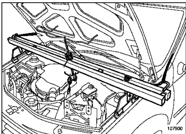
Colocar el útil de sujeción del motor (Mot. 1453) con la correa de sujeción, tomando el anillo de levantamiento del lado del volante motor como punto de anclaje.
