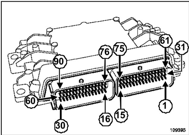
Para la conexión del calculador de inyección (consultar **esquema eléctrico** adaptado al vehículo diagnosticado, órgano 120).
