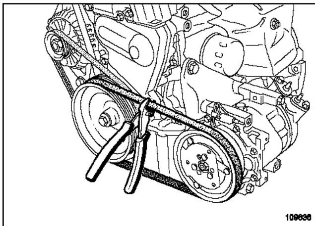
Cortar la correa del compresor del acondicionador de aire con una pinza cortante.
