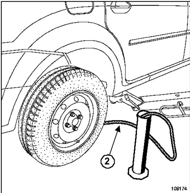
Sumergir el tubo (2) en una probeta graduada de 2 l.
