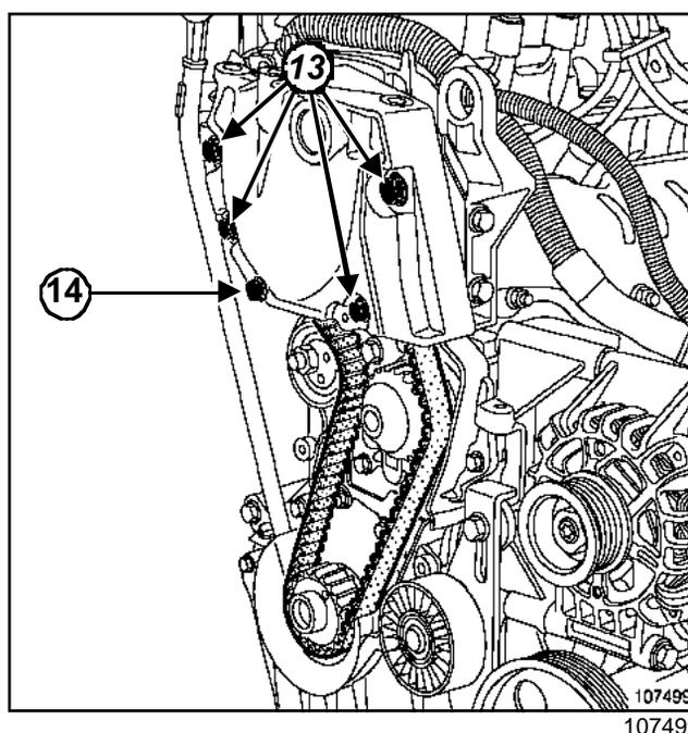
Untar con **LOCTITE FRENETANCH** los tornillos de fijación del cárter de distribución superior.
