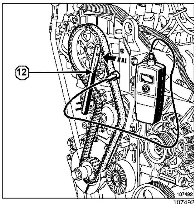
Colocar el útil tensor de la correa de distribución (**Mot. 1135-01**)(12).
