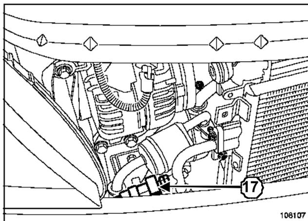
Desconectar el conector (17) del captador de presión del fluido refrigerante.
