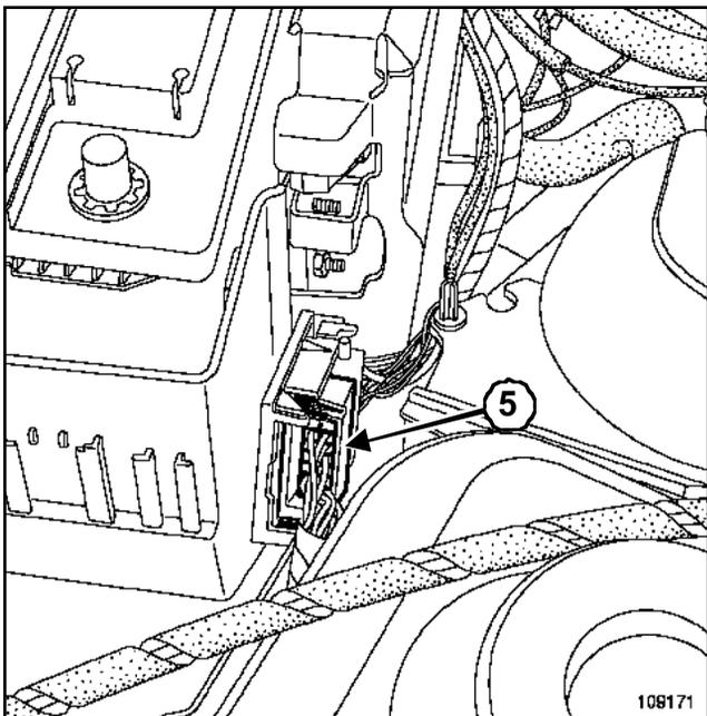
Desconectar el conector (5) del cableado eléctrico motor-habitáculo.
