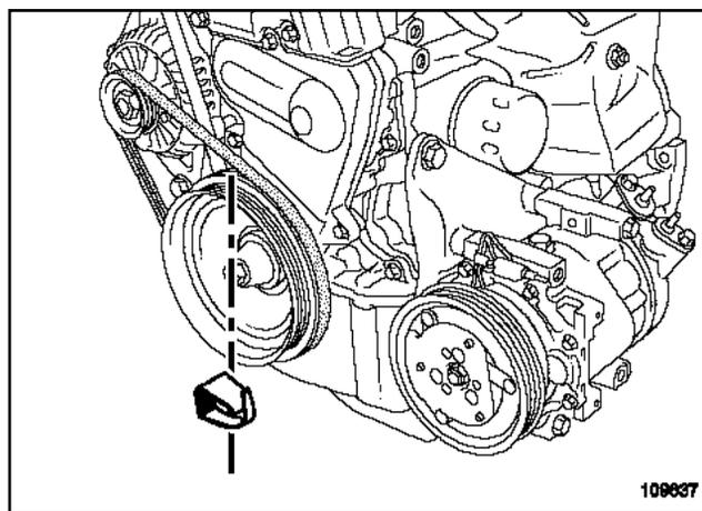
Encajar el útil de colocación de la correa en la polea del cigüeñal como se indica en el dibujo.
