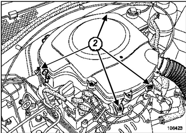
Quitar los tornillos (2) de fijación de la carcasa del filtro de aire.
