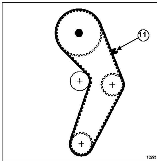
Colocar el útil de pretensión de la correa de distribución (Mot. 1501) en el piñón del árbol de levas (10).
