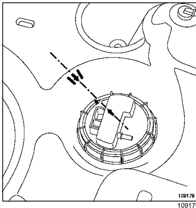
Apriete el casquillo de apriete del conjunto "bomba-aforador-filtro" mediante el útil (**Mot. 1397**).
