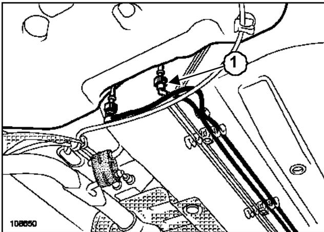
Desconectar la racor (1) del tubo de alimentación de gasolina.
