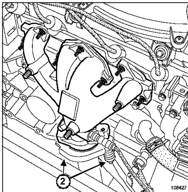
Desconectar el conector de la sonda de oxígeno
