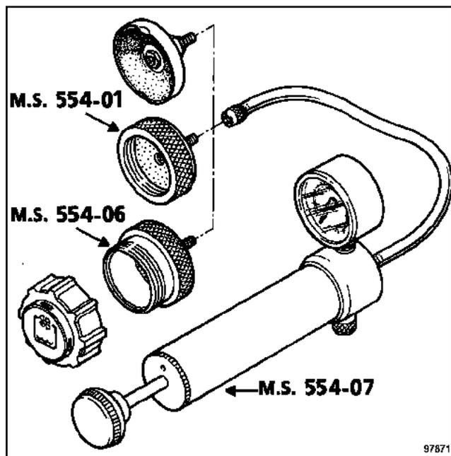
Sustituir la válvula del vaso de expansión por el tapón del útil (**Ms. 554-01**).
