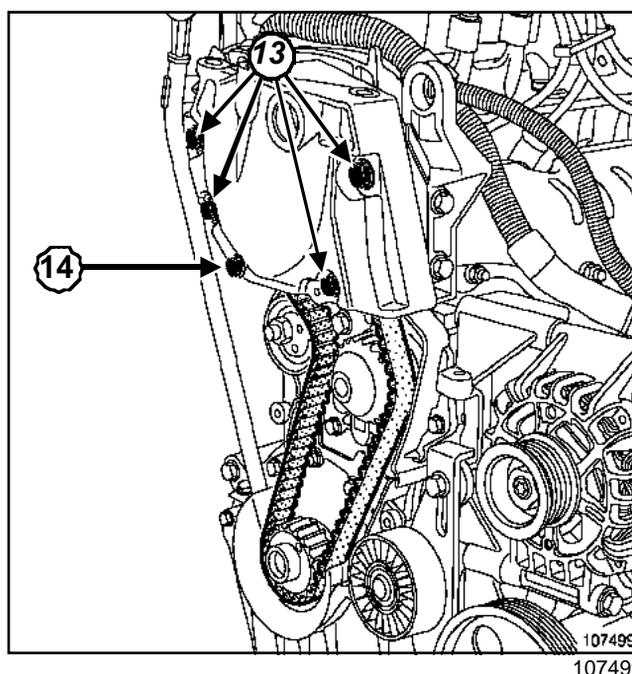
Untar de **LOCTITE FRENATANCH** los tornillos de fijación del cárter de distribución superior.
