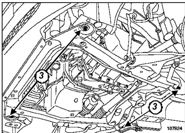
Extraer uno a uno los tornillos (3) de fijación de la cuna, y después sustituirlos poco a poco por las varillas roscadas del útil (Tav. 1747).
