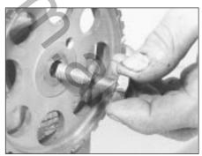
5B.22B Camshaft sprocket bolt and washer
