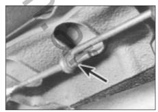
16.2 Handbrake adjuster nuts
