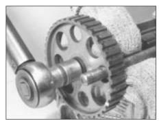
5B.22A Unscrewing the camshaft sprocket
