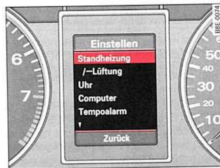
Fig. 126 Puesto de conducción: Pantalla digital del FIS, menú Einstellen (Ajustes), se ha seleccionado Standheizung (Calefacción estacionaria)
