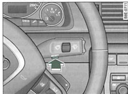
Fig. 25 Palanca del limpiaparabrisas: Tecla Reset
