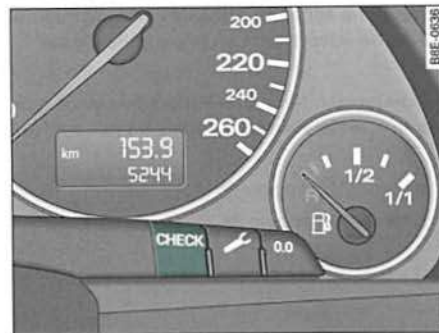
Fig. 20 Detalle del cuadro de instrumentos: Tecla CHECK
