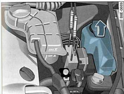
Fig. 220 Comparti- mento del motor: Depósito del sistema lavacristales
