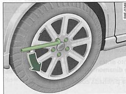
Fig. 233 Cambio de rueda: Aflojar los tornillos de la rueda
