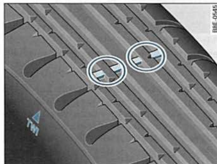
Fig. 222 Dibujo del neumático: Indicadores de desgaste
