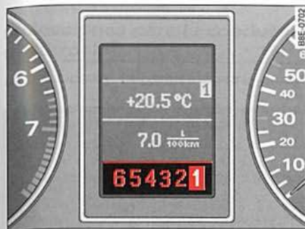
Fig. 148 Pantalla: Cambiar las marchas manualmente (tiptronic)
