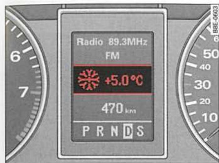
Fig. 11 Pantalla: Indicador de temperatura exterior
