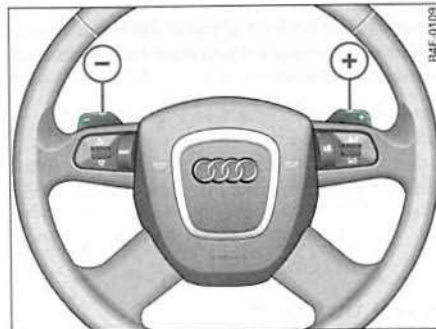
Fig. 155 Volante: Mandos del tiptronic
