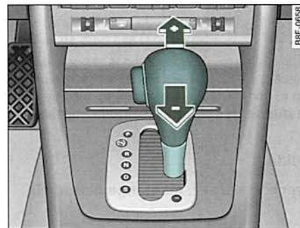
Fig. 147 Consola central: Cambiar las marchas manualmente (tiptronic)
