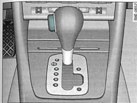
Fig. 150 Detalle de la consola central: Palanca selectora con tecla de bloqueo
