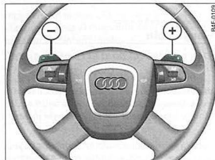
Fig. 149 Volante: Mandos del tiptronic
