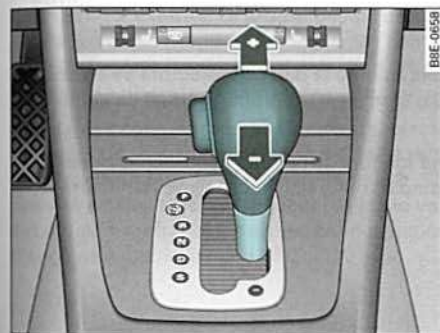
Fig. 153 Consola central: Cambiar las marchas manualmente (tiptronic)
