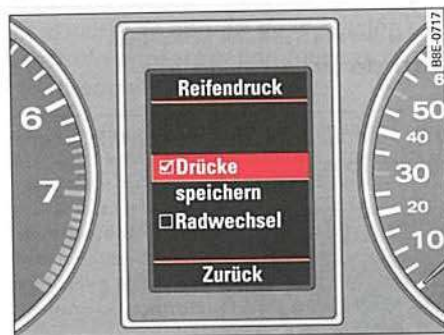
Fig. 40 Pantalla: Memorizar la presión de los neumáticos
