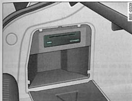
Fig. 103 Maletero: Lector de CD-ROM para el sistema de navega- ción
