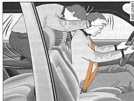
Fig. 166 El ocupante del asiento trasero que no lleve el cinturón de seguridad abrochado se verá lanzado hacia adelante.
