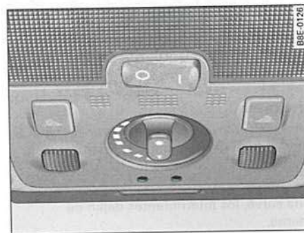
Fig. 72 Detalle del revestimiento del techo: Iluminación ambiental
