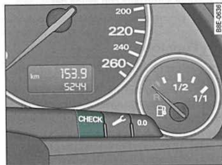
Fig. 19 Detalle del cuadro de instrumentos: Tecla CHECK
