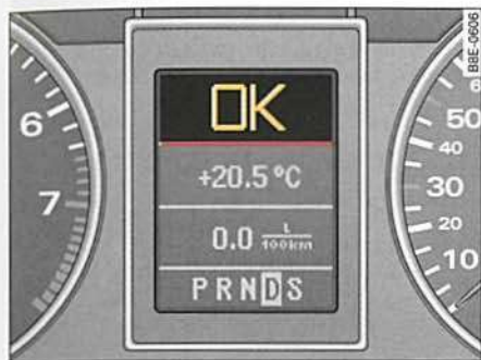
Fig. 15 Pantalla: Sistema de autochequeo
