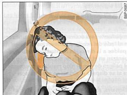
Fig. 183 Posición incorrecta de un niño que no va sujeto en su asiento y puede resultar herido por el airbag lateral
