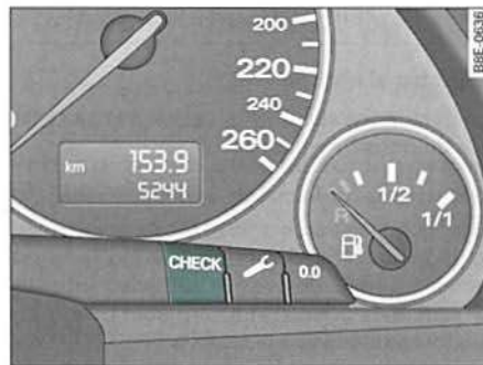
Fig. 6 Detalle del cuadro de instrumentos: Tecla CHECK
