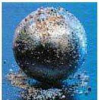
**Contaminación:** 14% de las fallas de rodamientos son causadas por contaminación del medio ambiente o del trabajo. La falta o falla de retenes, la revisión luego de trabajar en el agua, la limpieza del área de trabajo y el exceso de polvo afectan la vida útil del equipo.
