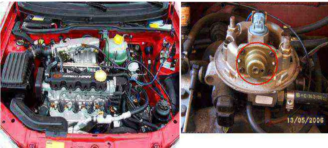
A partir de 2005 se instala el sistema de inyección electrónica en las carrocerías para el Chevy C2 y un sistema de inyección SEFI.
