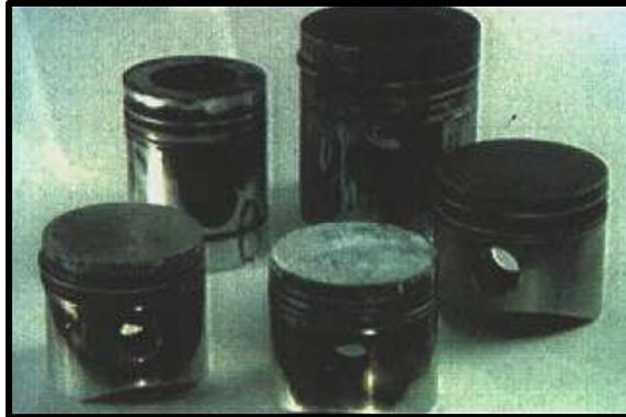
*Formación de depósitos en los pistones - un resultado de la oxidación de películas delgadas de aceite a altas temperaturas.*
