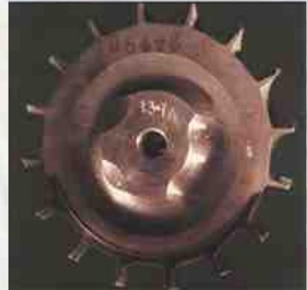
*El rozamiento en la superficie y la parte posterior de la rueda del compresor ha sido causado por el movimiento del eje.*
