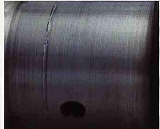
*Rayaduras profundas resultado del efecto de los abrasivos incrustados en la superficie del cojinete.*
