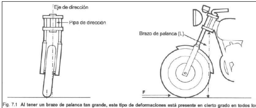
Fig. 34.- Flexión lateral de la suspensión delantera.
