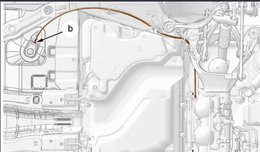
Desgrapar los cables de freno de sus fijaciones a la caja.
