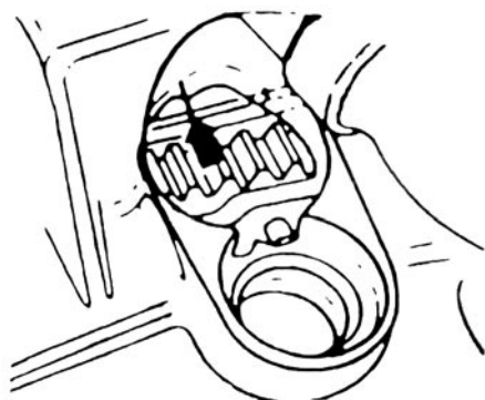
Localización de las marcas de sincronización en la campana de embrague.
