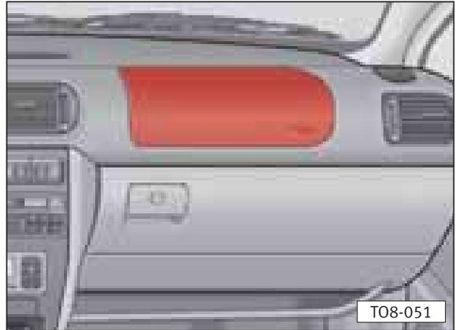
El sistema Air Bag, completando el efecto protector de los cinturones de seguridad de tres puntos, ofrece una protección adicional para la zona de la cabeza y el pecho del conductor y del acompañante en colisiones frontales graves.
