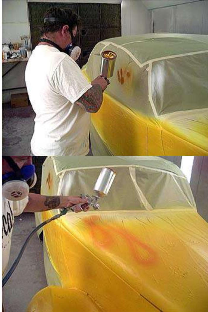
**Con la base aplicada es la hora de agregar color a las llamas. Él ajusta el inyector de su pistola de modo que rocíe una tira 1-1/2 " hasta el 2" ancho. La graduación da a la voluntad del color de la llama del color bajo a través dos cortinas de naranja y finalmente a la púrpura en las extremidades. El alumbrador, de dos cortinas de naranja se rocían alrededor de los bordes de las llamas que comienzan en su base y ampliar 2/3 de la manera hacia la llama inclina.**
