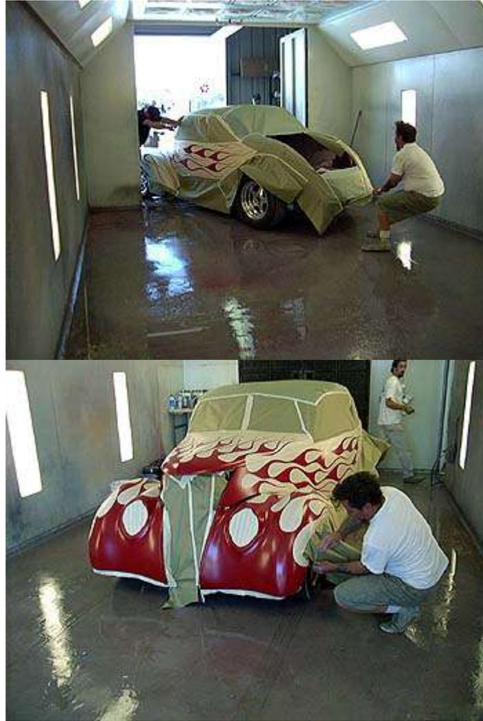
**Una vez que el coche se mueve a la cabina de pintura recientemente lavada, Pete acaba el enmascarar de las ruedas. Lavar bien el piso de la cabina de pintura para que no se deposite ningún polvo sobre la pintura del auto cuando los sopladores del pintura golpean en el piso.**
