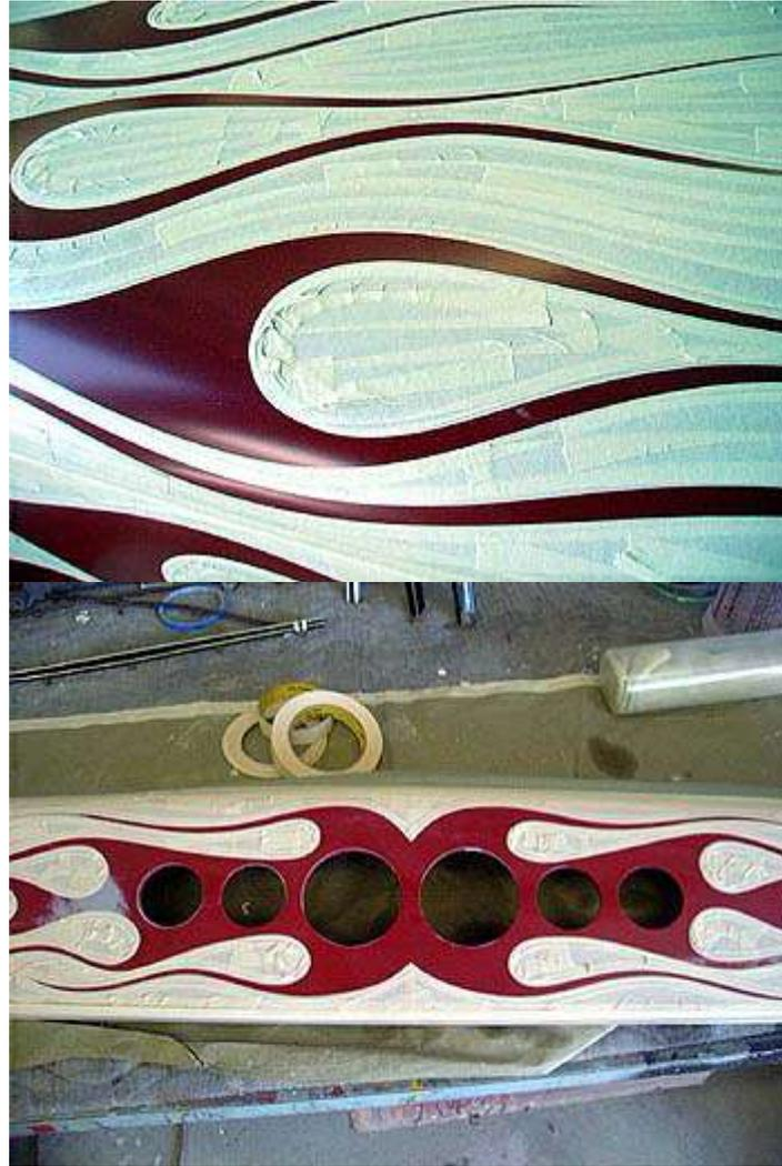
**La cinta usada para los bordes es muy estrecha de modo que no lo haga preñe o abroche al hacer las vueltas y las torceduras que se convertirán en los bordes externos de las llamas. Una cinta más ancha se utiliza para completar los boquetes.**
