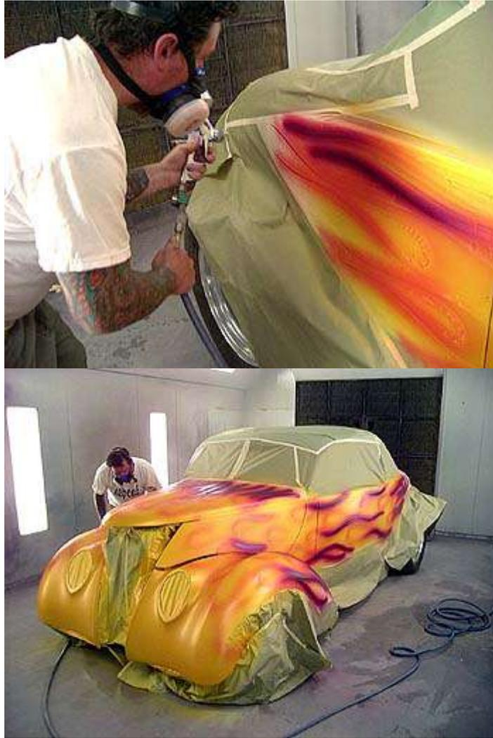
**Las extremidades púrpuras de la llama se aplican con la misma técnica de los otros colores, el comenzar en la extremidad y mover de un tirón la muñeca se descoloran él hacia la base.**
