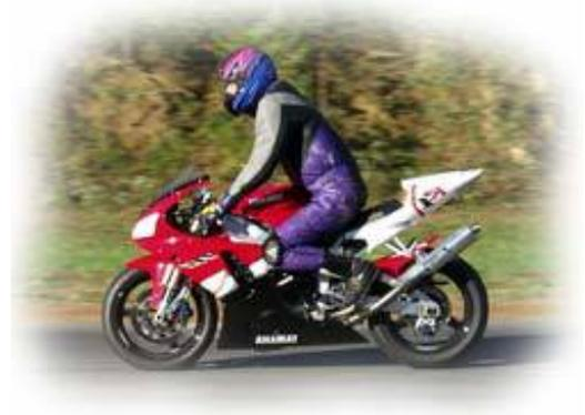
*Figura 4.1:* Al accionar la maneta del freno, la moto comprime el amortiguador delantero al tiempo que descomprime el trasero, debido al traslado de peso que provoca hacia el tren anterior.
