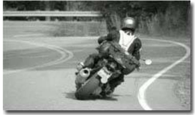
**Figura 5.39:** Postura en la tumbada inglesa: el tronco del piloto queda más vertical que la inclinación de la moto.
