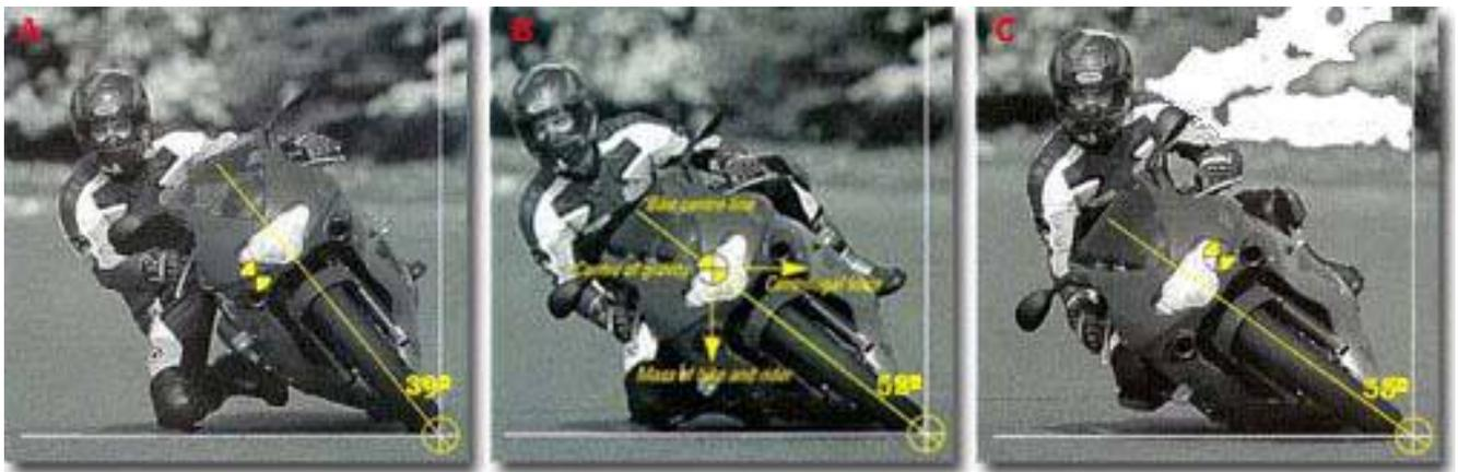
**Figura 5.38:** Estas fotografías muestran como el traslado lateral del peso del piloto modifica el centro de gravedad del conjunto piloto-máquina y su repercusión sobre el grado de tumbada –para una misma curva y velocidad-. En el centro (B), la postura continental (52°). A la izquierda (A), la postura racing (39°) y a la derecha (C), la postura inglesa (55°).
