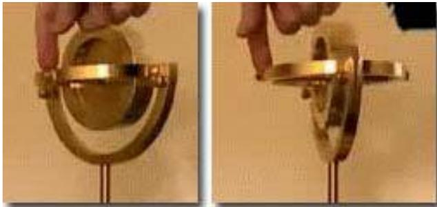
**Figura 5.21:** Otro efecto giroscópico que hace que una rueda, que está rotando sobre su eje, gire hacia el lado que se la intenta inclinar. En la figura de la izquierda se realiza una leve presión para intentar tumbarla hacia ese lado. La figura de la derecha muestra la reacción de la rueda, que ha girado hacia ese mismo lado.
