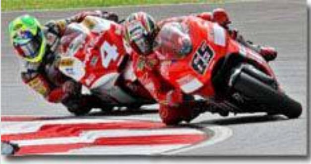
**Figura 5.26 :** *Postura racing. Los pilotos están mirando hacia donde van a dirigir la moto. Sus cabezas mantienen una posición bastante vertical. El pie interior apoyado sobre la punta de la bota. Rodilla y cuerpo desplazados hacia el interior de la curva.*
