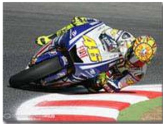
**Figura 5.22:** La rueda de Rossi ha girado ligeramente hacia el interior de la curva cuando se está acercando al ápice. Esta reacción suele ser espontánea en la moto.
