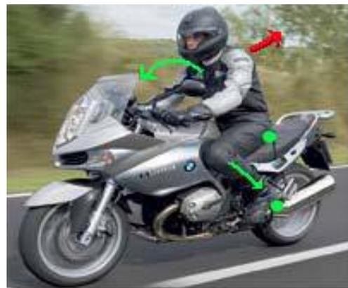
**Figura 1.2:** En la aceleración, el apoyo sobre los reposapiés, permite inclinar el tronco hacia delante, para contrarrestar la inercia natural del tronco (flecha roja), la descarga del tren delantero y disminuir la resistencia al aire.
