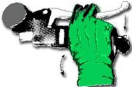
**Figura 3.6** . Golpe de gas al vacío al tiempo que se frena con la maneta. El giro brusco de la muñeca se realiza sin modificar la presión de los dedos sobre el mando del freno. (Dibujo modificado de K. Code<sup>®</sup>).
