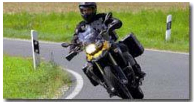
**Figura 5.36:** Postura continental. La distribución de pesos hacia ambos lados de la moto es simétrica. La cabeza mantiene una orientación más próxima a la vertical, como en las demás posturas.
