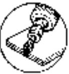
6 puntos eléctricos sobre espesor 1,2
