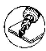
8 puntos eléctricos sobre espesor 0,8 para un corte en (C).
