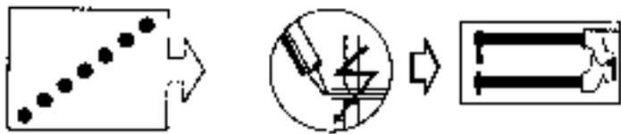
NOTA : la operación de soldadura se efectuará antes de la reposición del panel de aleta salvo en (A) donde los puntos van sobre 3 espesores.
