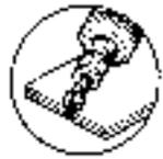
2 puntos eléctricos sobre espesor 0,8
