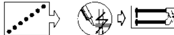
**NOTA :** Puntos sobre 3 espesores 0,7 + 0,7 + 0,8 que se efectuarán al colocar el panel de aleta.
