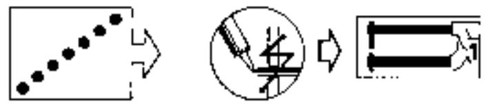
En A, 2 puntos eléctricos de 3 espesores 0,7+1+0,8
