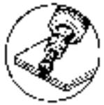
2 puntos eléctricos sobre espesor 0,8 por cada lado.
