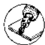
3 puntos eléctricos sobre espesor 0,8 por cada lado.
