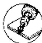
6 puntos eléctricos sobre espesor 0,7
