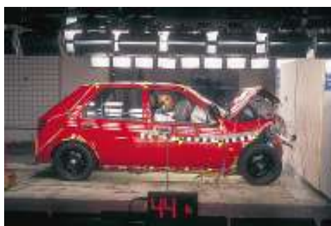
Las pruebas de choque validan el comportamiento del vehículo ante una colisión real
