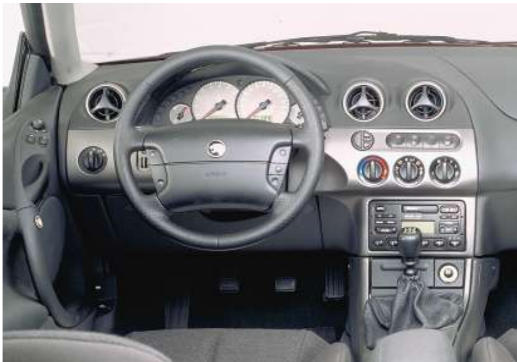
Mandos del control de velocidad de crucero situados en el volante
