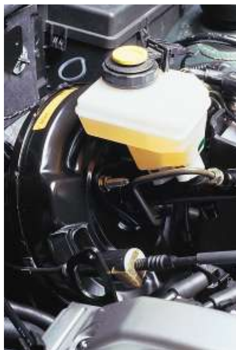
La presión de frenado se genera en la bomba de frenos
