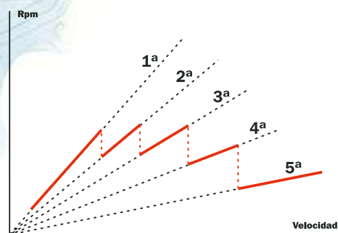
Relación de velocidad y revoluciones para las distintas marchas de la caja de cambios
