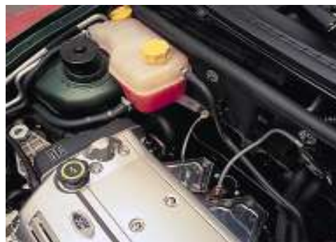
El nivel del refrigerante puede comprobarse en el vaso de expansión
