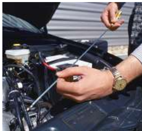
El uso del vehículo origina el consumo de aceite del motor. Debe verificarse periódicamente su nivel
