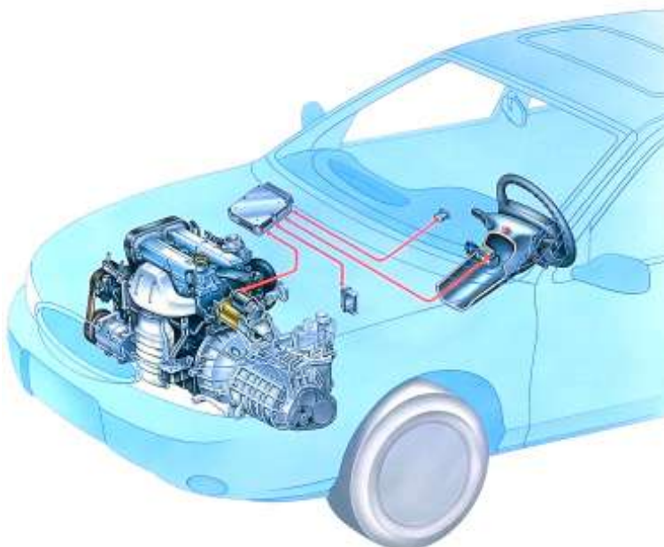
Ubicación en el vehículo de los componentes del PATS
