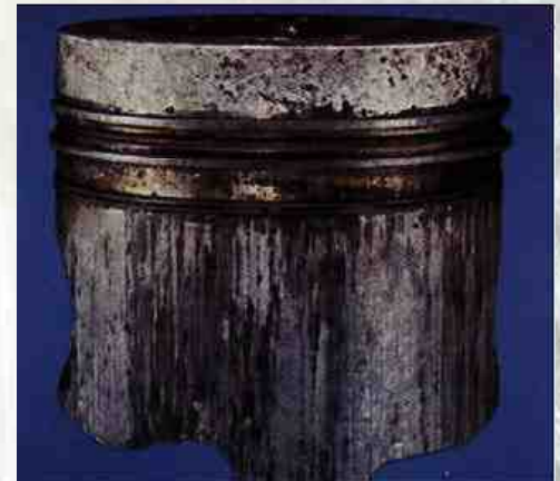
Marcas de agarrotamiento desde la parte superior a la inferior, pueden indicar una falta del sistema de lubricación o de enfriamiento.
