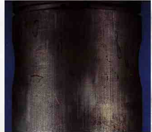
Falda del pistón dañada por el desgaste abrasivo.
