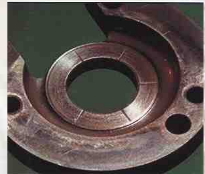
Schwitzer, superficie de cojinete de empuje pulida para abrasivos finos en el aceite.
