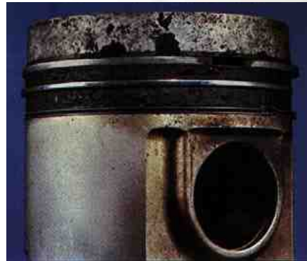
La densa acumulación de incrustaciones en el primero y el segundo resalto indica que el aceite no puede mantener limpio el pistón. La severa degradación y deterioración del aceite puede ser debida a un consumo insuficiente de aceite, un intervalo de cambio de aceite demasiado prolongado o una baja calidad de aceite.
