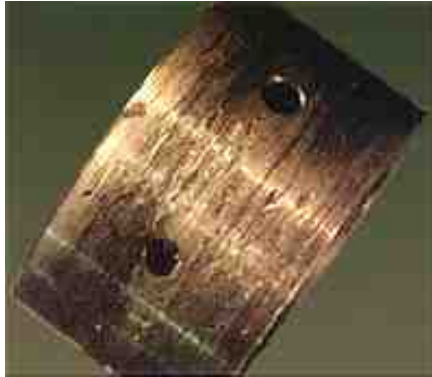
La falla de lubricante hizo que este cojinete de bancada se deformara o estirase.
