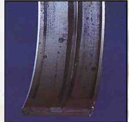
Superficie del cojinete rayada. Se puede observar las partículas de residuos incrustadas en la superficie del cojinete.
