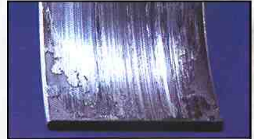
La última etapa del cojinete deteriorado por falta de lubricación es su agarrotamiento.
