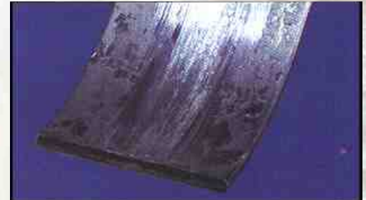
El cojinete está excesivamente gastado lo que produce un deterioro severo resultante de la falta de lubricación.
