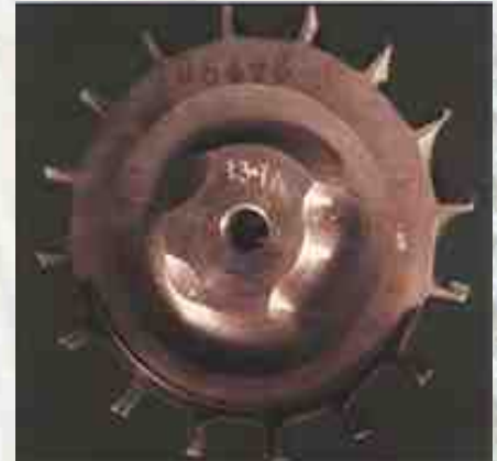
El rozamiento en la superficie y la parte posterior de la rueda del compresor ha sido causado por el movimiento del eje.
