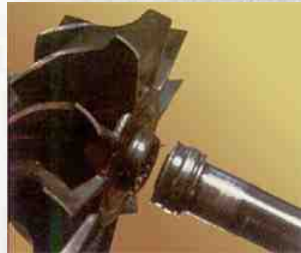
Eje roto por el debilitamiento de la soldadura debido al contacto con la maza de la turbina.
