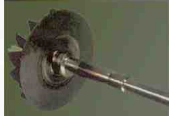
Decoloración en el eje por el calor.
