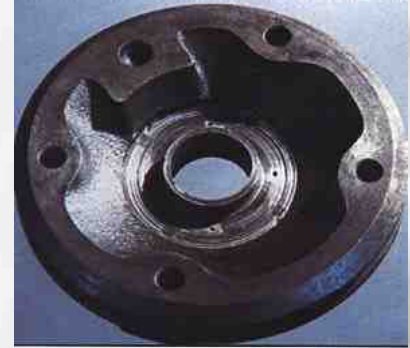
AiResearch, ranuras de desgaste en la superficie de las arandelas de empuje.
