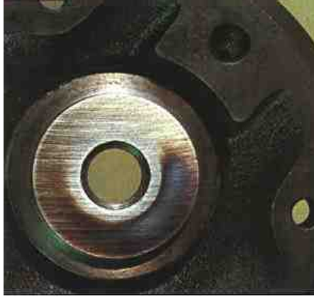
Decoloración por el calor en el lado interno del anillo de empuje (AiResearch).
